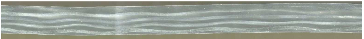
FIGURE 2.18 – Mise en évidence des ondulations des torons axiaux
