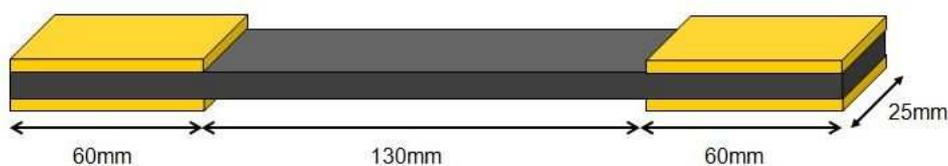
FIGURE 3.3 – Dimensions des éprouvettes
