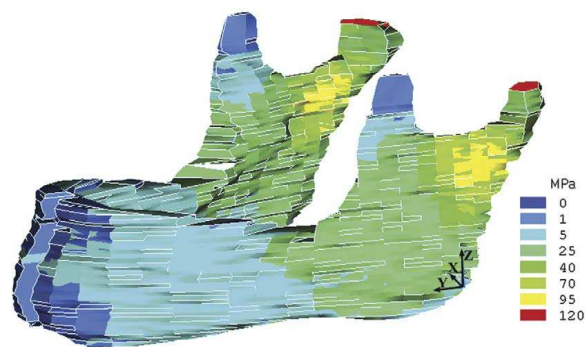
Figure 35 : modèle de Basciftci et al. [57] montrant les contraintes osseuses (champs de von Mises) lors d'une distraction symphysaire.
