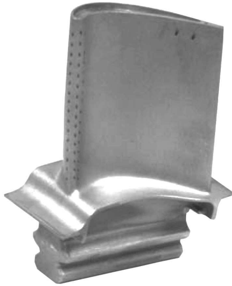
FIGURE 1.2 – Aube de turbine haute pression du moteur militaire M88
