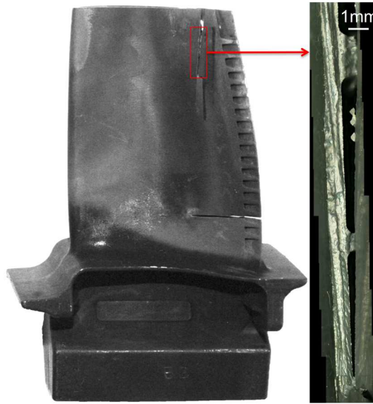
FIGURE 3.41 – Facies de rupture de l'éprouvette de structure A950/F/EF ( F_{max} : 1kN , f : 1Hz et R_{force} : 0,1 )
