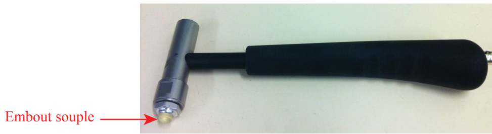
FIGURE 9.3. Marteau utilisé pour engendrer la force extérieure.
