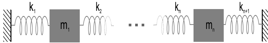
FIGURE 5.4. Système masse-ressort encastré-encastré à n masses m_i et à n + 1 ressorts de raideur k_s .
