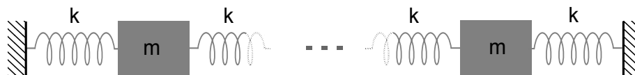
FIGURE 5.6. Système masse-ressort encasté-encasté à n masses m et à n + 1 ressorts de raideur k .
