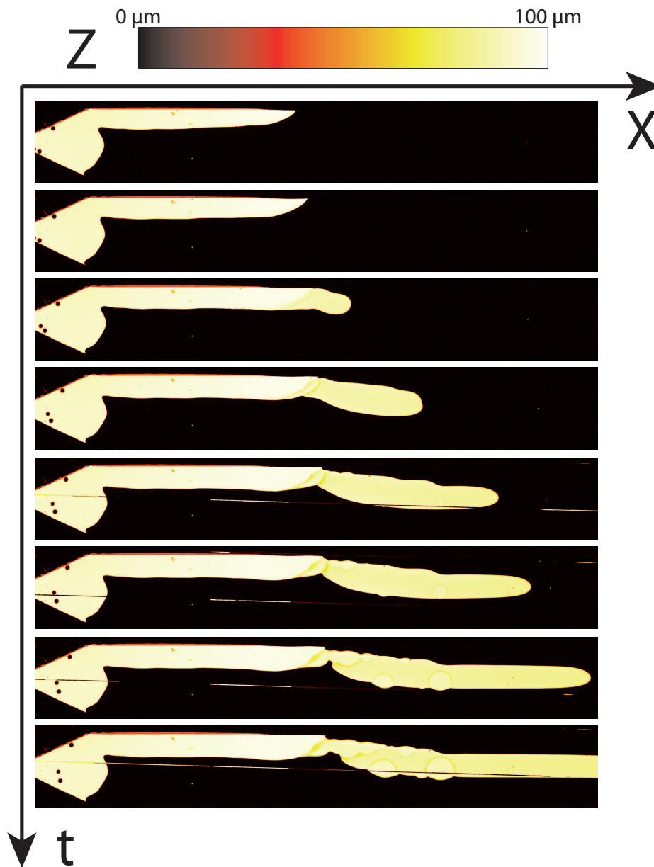
FIGURE 4.15 – Images issues d’une expérience d’invasion en régime d’imbibition dans une cellule de Hele-Shaw pour \theta_e \sim 60^\circ et M = 1000 et avec un débit croissant. Au delà d’un débit seuil, un doigt d’eau se développe à l’intérieur de l’huile et prend une forme typique d’un doigt de Saffman-Taylor.
