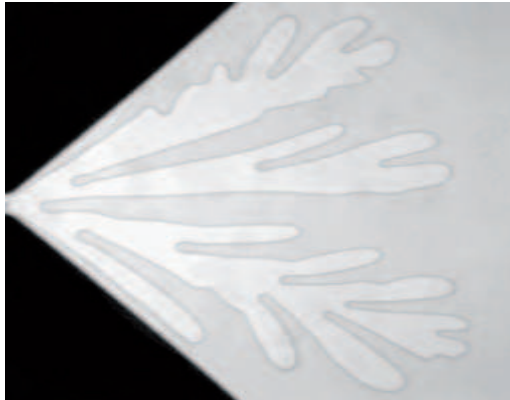
FIGURE 1.4 – Image de la croissance Laplacienne d'un doigt visqueux dans une géométrie en cône. La variation de \epsilon entraîne un dédoublement de chacun des doigts, phénomène d'instabilité connu sous le nom de tip-splitting . Issue de [38].
