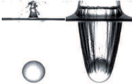
(a) Image de l'impact d'une sphère sur une surface de liquide. A gauche, le liquide mouille la sphère ( \theta_0 \sim 15^\circ ) et il n'y a pas d'entraînement d'air. A droite, le liquide est non-mouillant ( \theta_0 \sim 100^\circ ) et il y a entraînement d'air.
