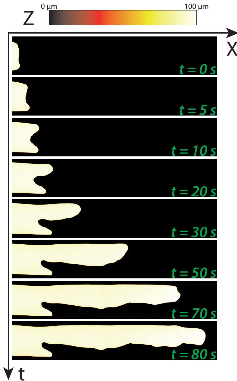
FIGURE 3.2 – Images issues d’une expérience d’invasion en régime de drainage dans une cellule de Hele-Shaw pour Q = 1.5 \mu\text{L}/\text{min} , \theta_e = 120^\circ et M = 1000 . Le niveau de couleur correspond à l’épaisseur d’eau dans le canal. L’eau envahit toute la hauteur du canal.
