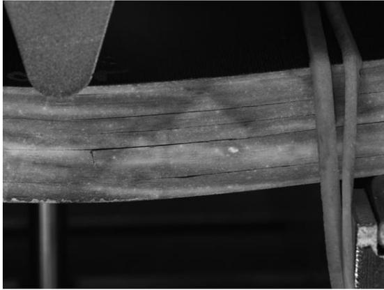
Figure V-34: Faciès de rupture observés sur un empilement UD (16 plis) pour l'essai de cisaillement interlaminaire.
