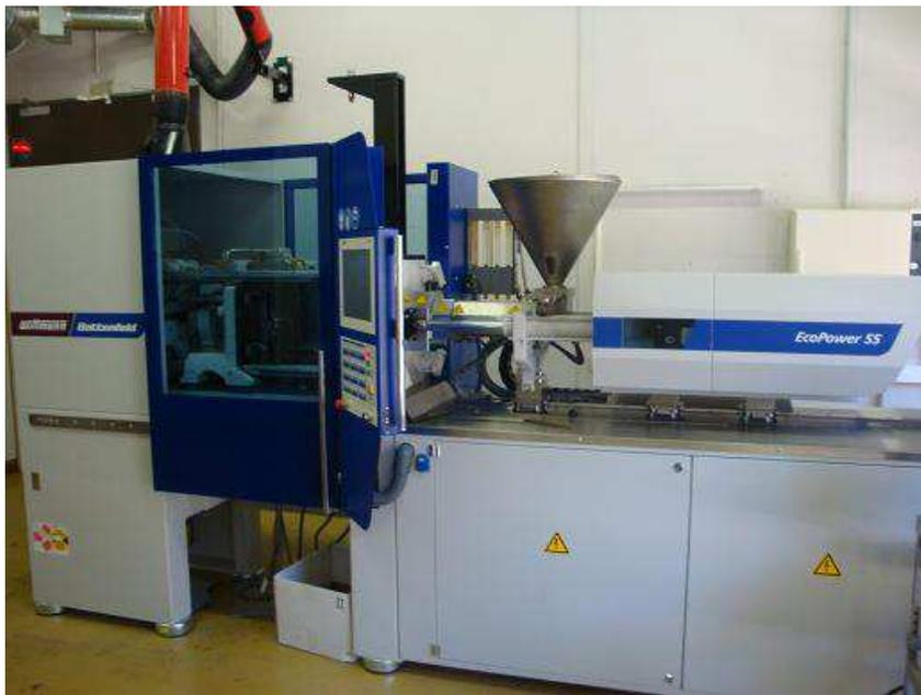
Figure B-9: Presse à injectée utilisée : Wittman Battenfeld EcoPower55
