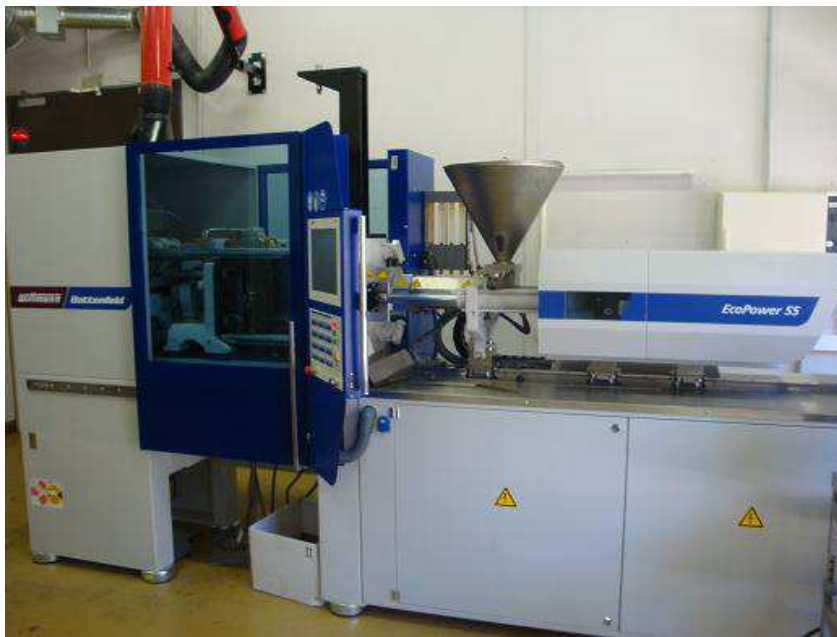
Figure B-9: Presse à injectée utilisée : Wittman Battenfeld EcoPower55
