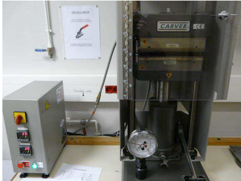
Figure B-4 : Presse hydraulique Carver M 3853-0 pour la préparation de barreaux d'essais de résistance au choc.
