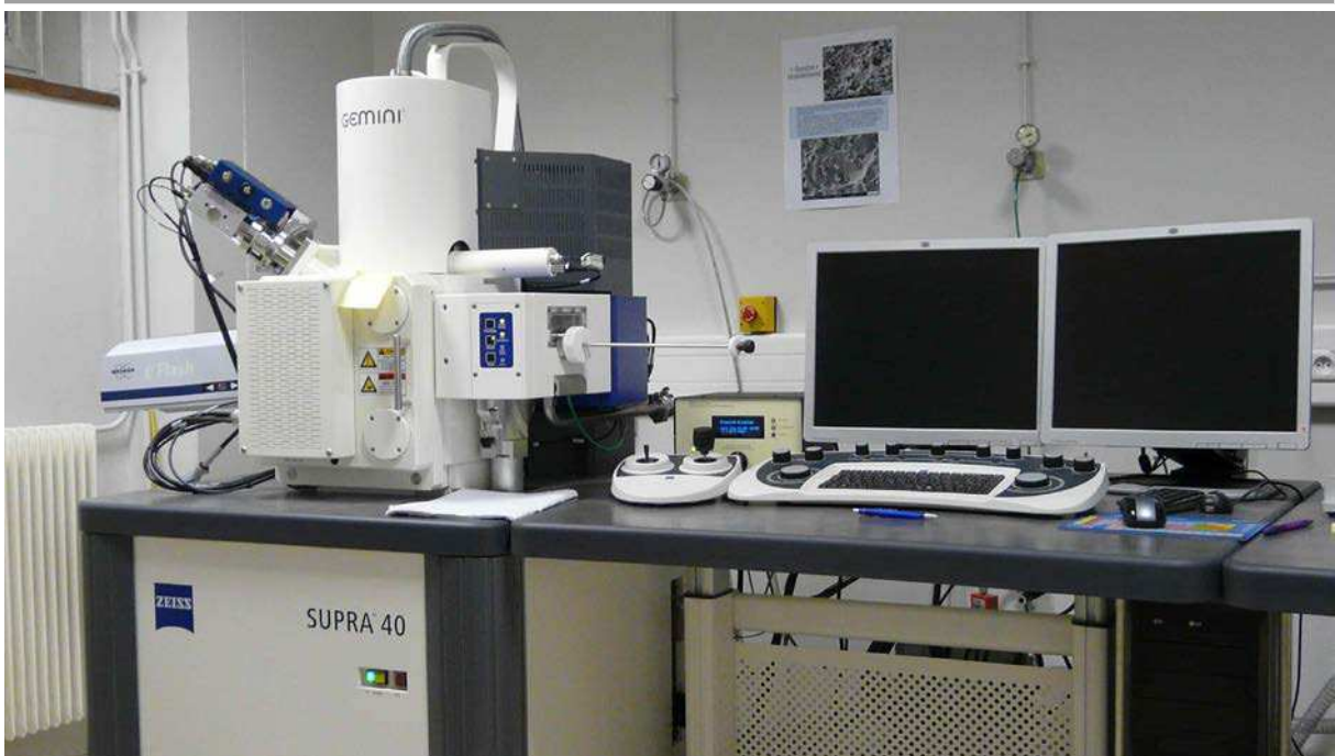
Figure B-19 : Microscope électronique à balayage Zeiss Supra 40 principalement utilisé lors de la thèse
