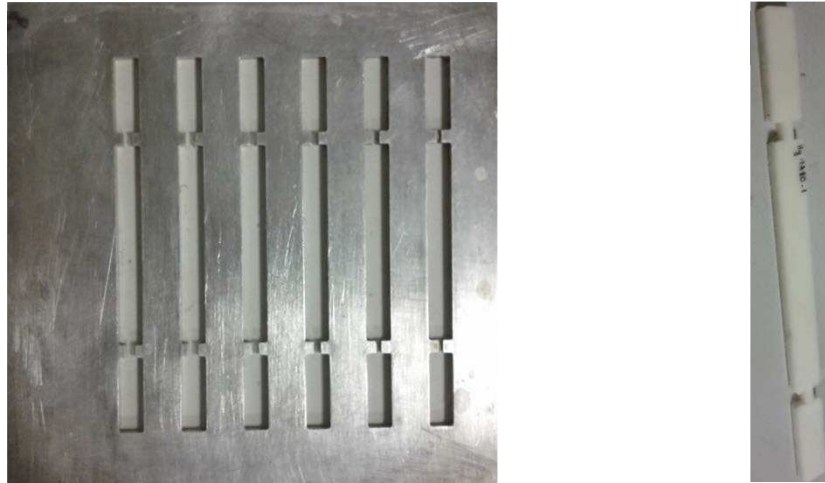
Figure B-5 : Photographie du moule en acier inoxydable, réalisé au Cemef, et permettant le pressage de barreaux d'essais de résistance au choc.
