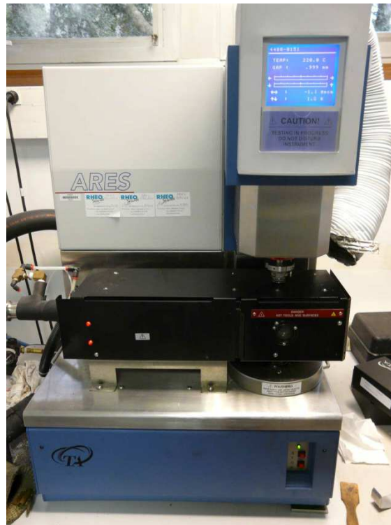
Figure B-12: Rhéomètre ARES (TA Instruments) utilisé durant la thèse.
