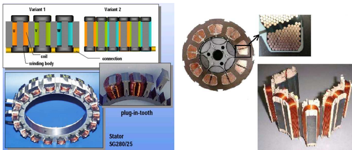
(a) Technique plug-in dent [34] (b) Technique joint-lapped stator [9] Figure 1-10 Deux techniques du stator à dents séparées pour le bobinage concentré non-croisé
