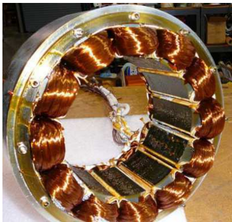
Figure 1-9 Exemples d'un bobinage concentré autour des dents (non-croisé) [32]-[source HONDA]
