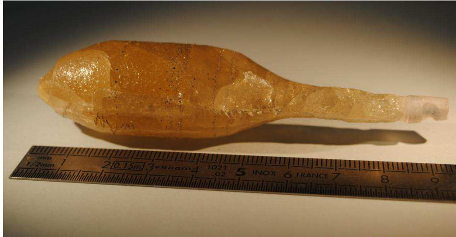
Figure 94 : Monocristal de CGS-1 obtenu par méthode Czochralski
