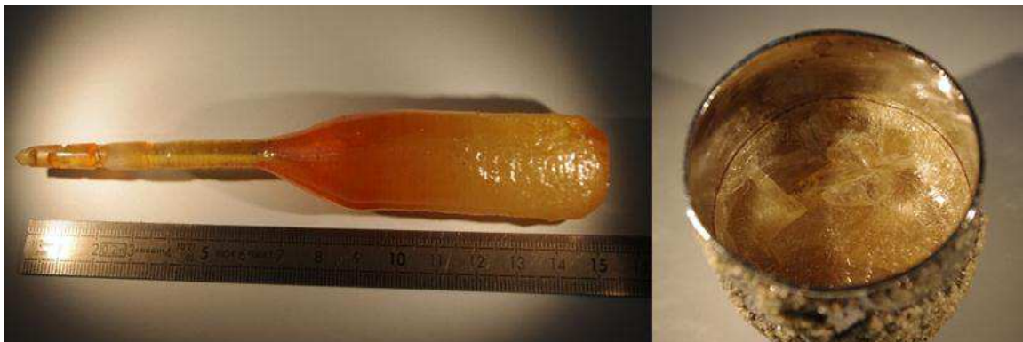
Figure 20 : Cristal de CALGOS-1 avant recuit réducteur (gauche) et bain résultant (droite).
