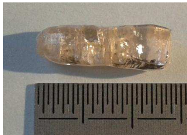
Figure 72 : Cristal de YSO : 0,5%Er, 5%Yb, 1,65%Ce élaboré au four à image.
