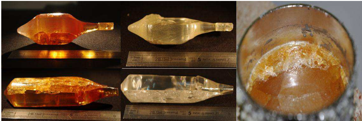
Figure 18 : Cristaux de CALGO-4 (haut) et CALGO-7 (bas) avant et après recuit réducteur et bain résultant (droite).
