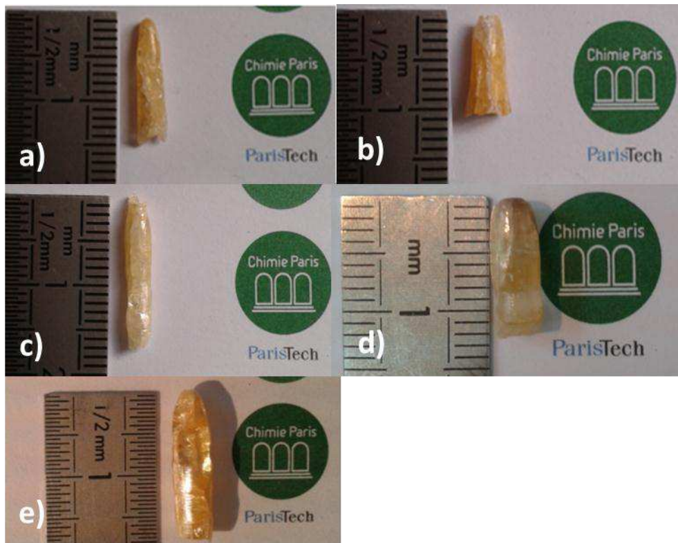
Figure 48 : Cristaux élaborés par four à image a) CALGO 5%Yb, b) CALGO:1%Yb, 1%Si, c) CALGO:1%Yb, 1%Zr, d) CALGO:1%Yb, 1%Ti, e) CALGO:1%Yb, 1%Ge.
