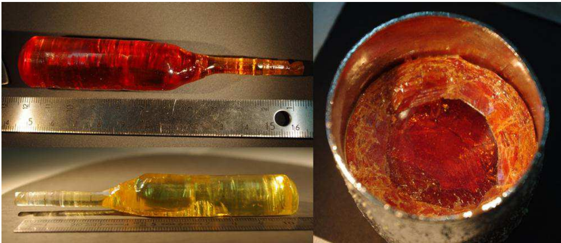
Figure 19 : Cristaux de CALGO-10 avant recuit (haut) et après recuit réducteur (bas) et bain résultant (droite).
