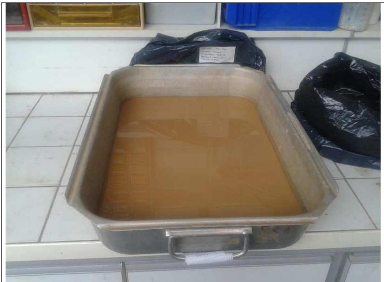
Photo 4. Les particules passantes le tamis 0,08 mm laissé sur la pailleasse pour décanter
