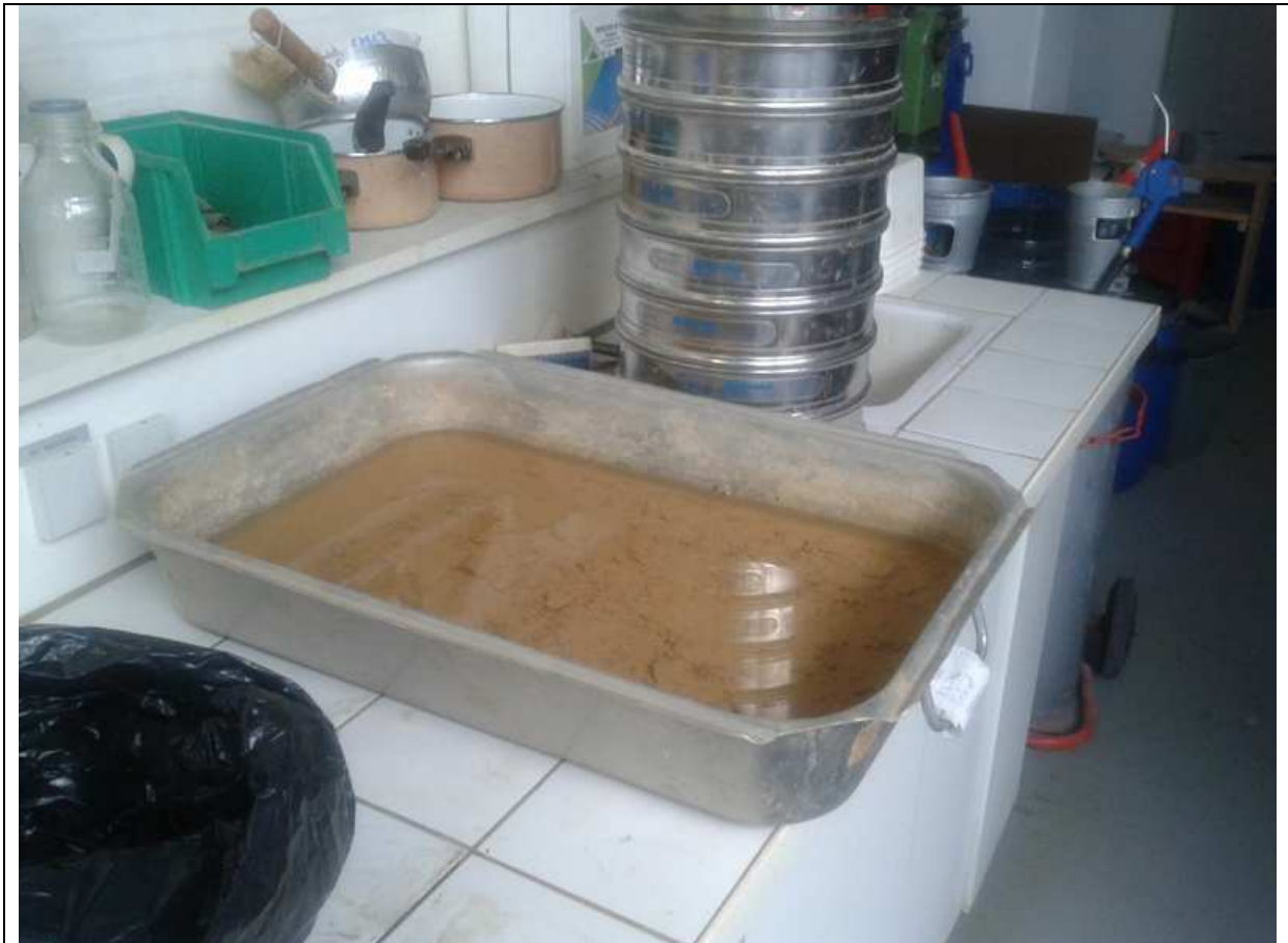
Photo 2. Echantillon imbibé avec la série des tamis
