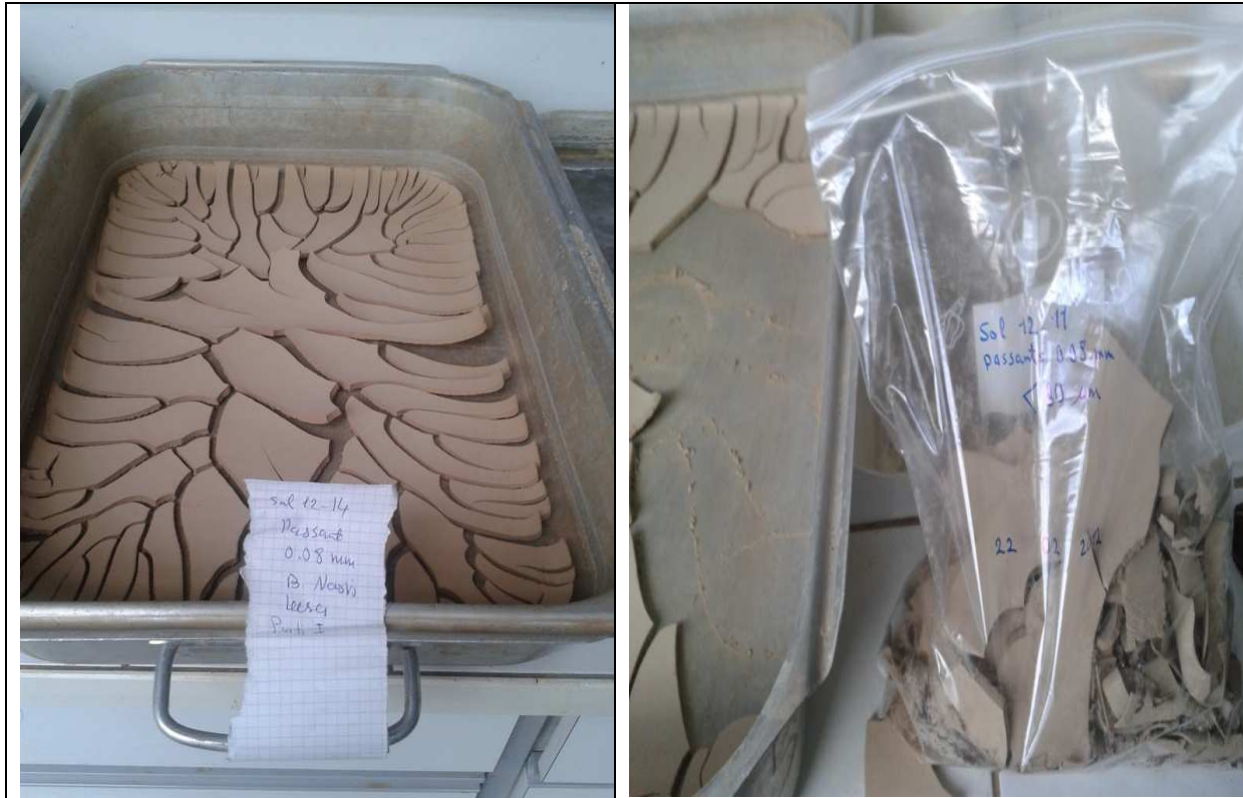
Photo 6. Les passants 0,08 mm après le séchage
