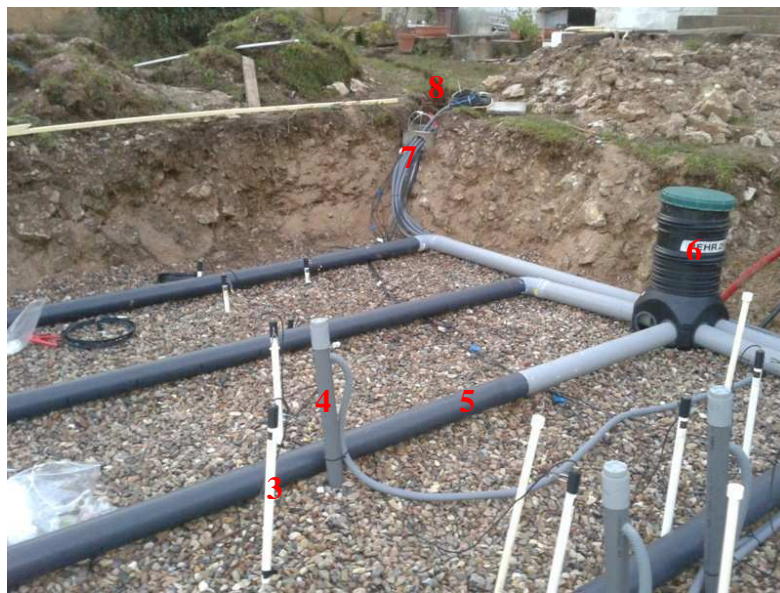
Figure 33. A-1. Etat de l'instrumentation le 20 décembre 2011. A-2. Installation d'une plaque poreuse. B. Etat de l'instrumentation le 20 janvier 2012 : 1. Le sable de granulométrie normalisée. 2. Le collecteur des tubes connectés aux plaques poreuses déjà enfouies. 3. Une canne de tensiomètre. 4. Un tube de réservation pour une sonde de teneur en eau. 5. Un tuyau d'épandage des eaux usées prétraitées. 6. La boîte de répartition. 7. Le regard pour regrouper les tubes en téflon et les câbles. 8. Le départ de la tranchée d'amenée des tubes et des câbles vers les pompes et la centrale d'acquisition dans la cave.
