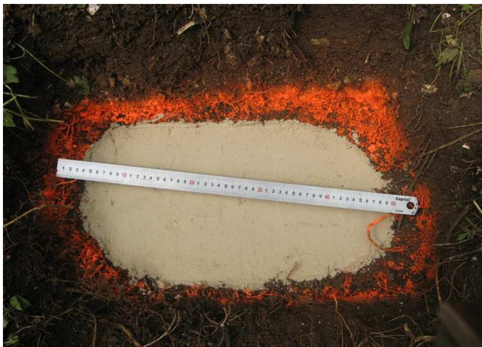
Figure 62. Le trou de l'essai de mesure du volume apparent au sable : après décapage du sol organique, marquage avant l'excavation (en haut), après l'excavation et le remplissage avec du sable à jauger (en bas).
