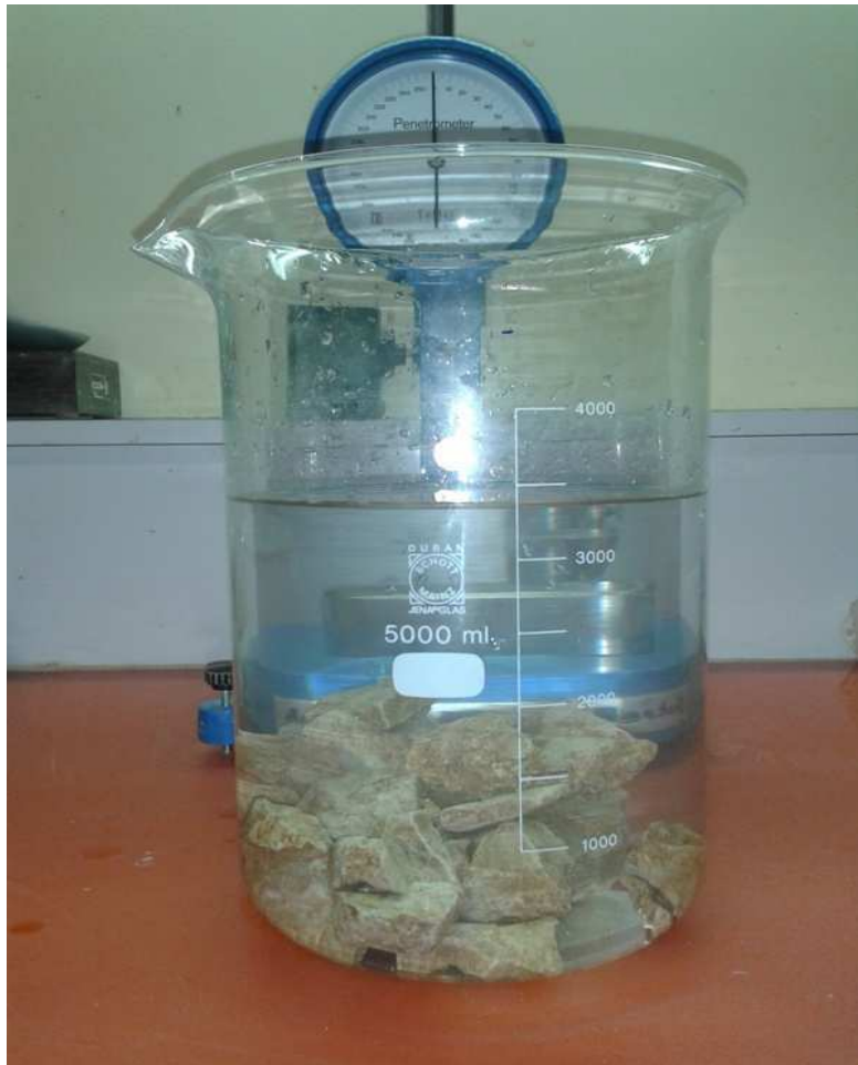
Figure 63. Détermination du volume des cailloux dans l'eau.
