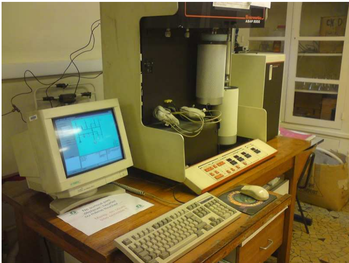
Figure 56. L'appareil BET pour la mesure de la surface spécifique, installé au Cnam.
