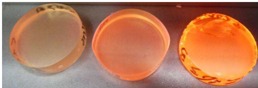
FIGURE 64 – Échantillons de scintillateurs à temps de décroissances longs. Le taux d'intégration en complexe d'euporium est croissant de droite à gauche (cliché CEA/DRT/LCAE).
