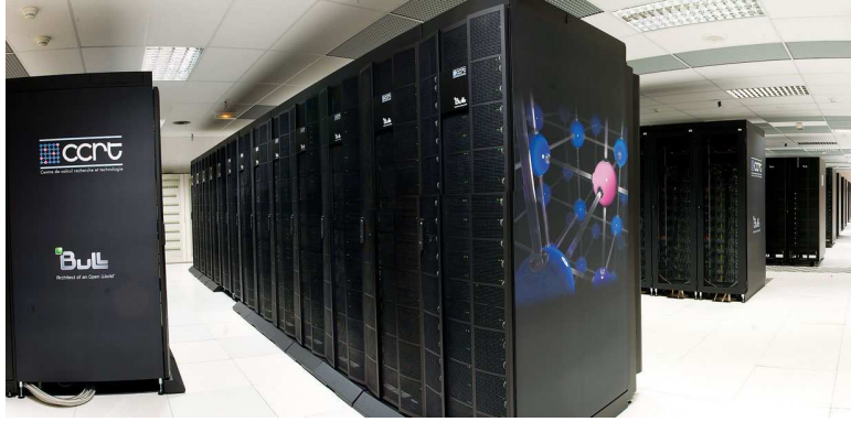
FIGURE 34 – Vue des baies de calculs de la machine TITANE utilisée pour les simulations GEANT4 (cliché CEA/DAM/DIF).
