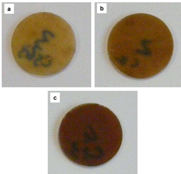
**Figure IV.20.** Photographies des composites fibres Tencel<sup>®</sup> 20 % pour différentes conditions de mélange (disques de diamètre 25 mm pour 1,5 mm d'épaisseur). (a) 100 tr/min pendant 2 minutes. (b) 150 tr/min pendant 2 minutes. (c) 150 tr/min pendant 10 minutes
