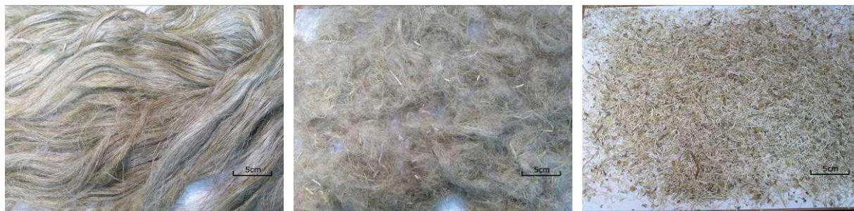
**Figure I.9.** Photographie des fractions végétales issues du teillage : filasse, étoupes et anas. La barre noire sur les photos représente 5 cm (photographies © FRD).
