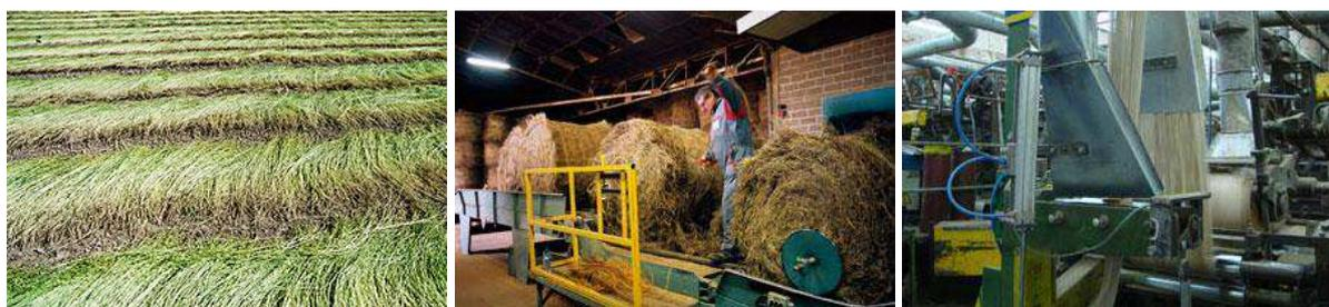
**Figure I.5.** Les étapes d'extraction du lin et de préparation à la filature : rouissage, teillage et peignage
