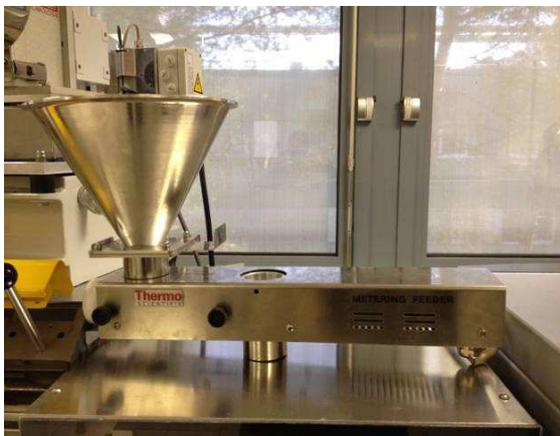
**Figure V.3.** Photographie du doseur volumétrique ThermoFischer
