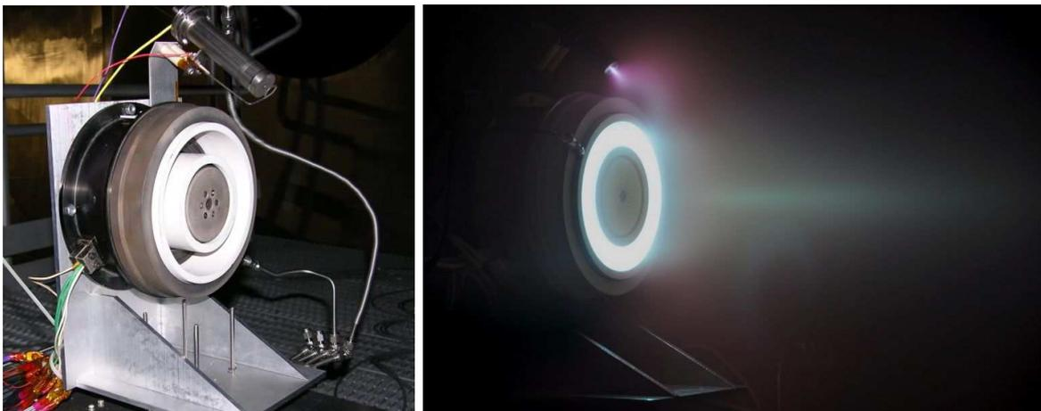
**Figure 1.4** – Photos du propulseur Hall T140 au repos et en opération.
