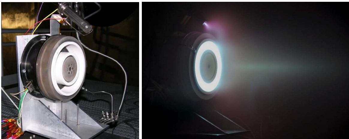
Figure 1.4 – Photos du propulseur Hall T140 au repos et en opération.
