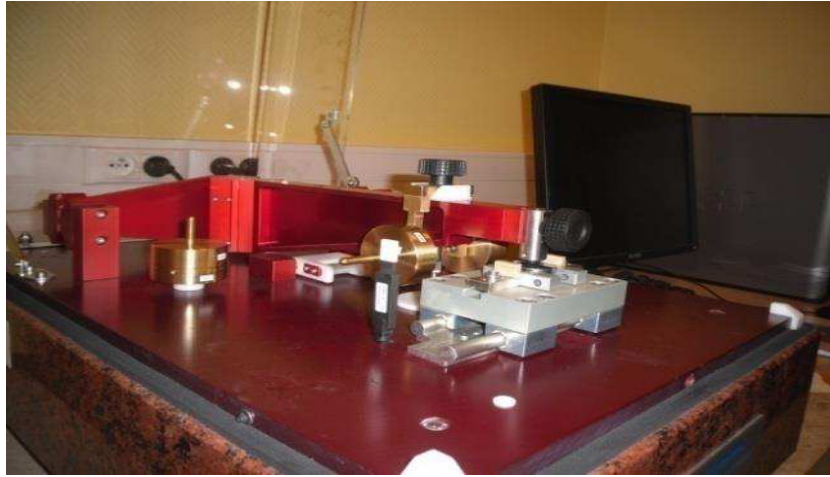
Figure II.19. Tribomètre configuration Pion/Plan CER Arts et Métiers ParisTech de Lille.
