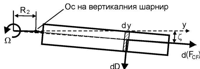
Фиг.3.5 Равновесие на аеродинамичните и центробежни сили спрямо вертикалния шарнир на хеликоптерна лопата
