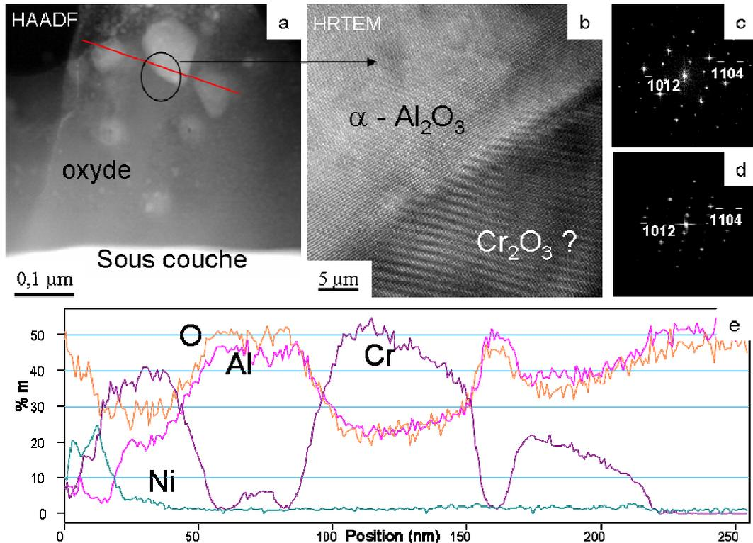
Figure 32 : Micrographies MET de l'oxyde d'un échantillon traité thermiquement sous basse pression partielle d'oxygène (a) en contraste de Z HAADF et (b) en haute résolution. (c) et (d) Transformées de Fourier associées à chacune des phases. La phase inconnue peut être indexée de la même manière que la phase  $\alpha$ , or la chromine a la même structure. (e) Profil d'analyse EDS traversant les précipités présents à la surface de l'oxyde le long du profil de la micrographie (a).
