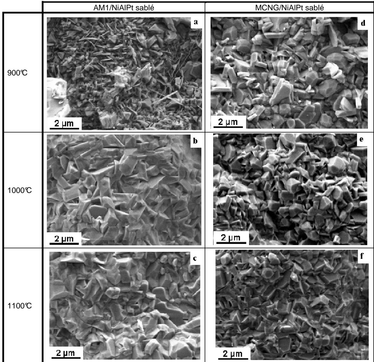
Figure 124: Micrographies MEB de surface des échantillons sablés pré-oxydés et vieillis.
