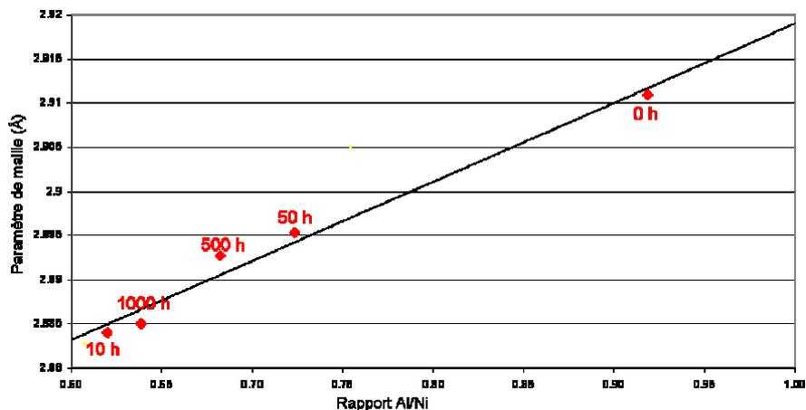
Figure 51 : Evolution du paramètre de maille (en Å) de la phase  $\beta$  en fonction du rapport Al/Ni déterminé à partir de pointés WDS effectués dans les phases proches de la surface de la ZE. La durée d'oxydation est indiquée pour chaque point.
