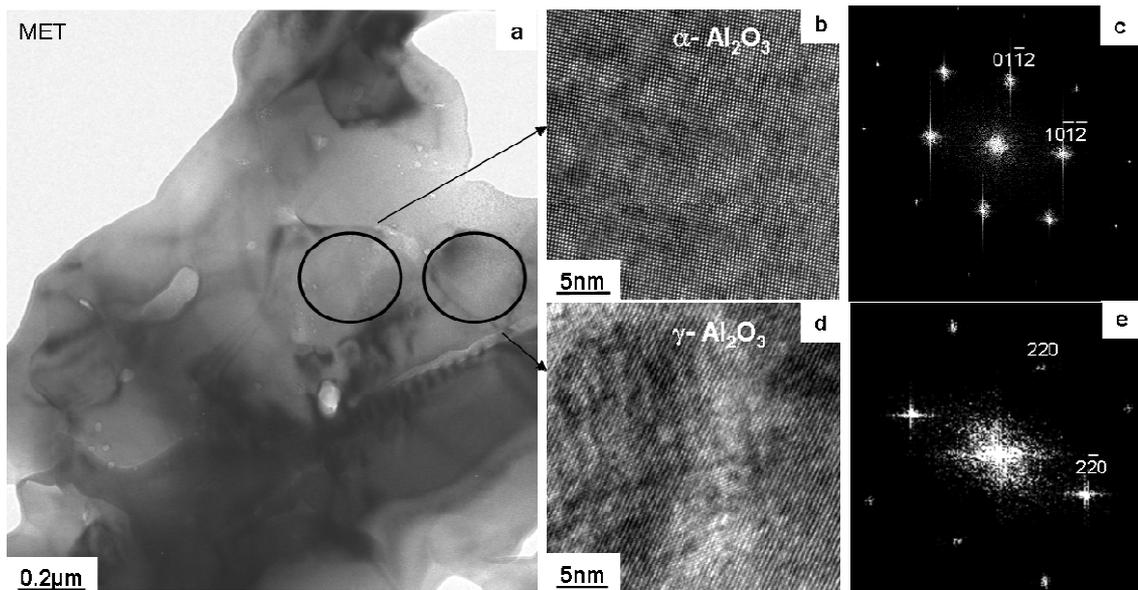
Figure 28 : Micrographies MET de l'oxyde formé sur l'échantillon sans Pt traité 50 h à 1100°C (a) en champ clair. (b) Micrographie en haute résolution d'un grain d'alumine  $\alpha$  et (c) la transformée de Fourier correspondante. (d) Micrographie en haute résolution d'un grain d'alumine  $\gamma$  et (e) sa transformée de Fourier.
