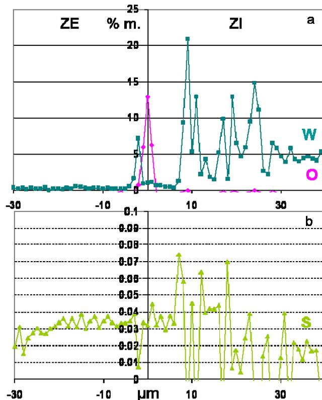
Figure 135 : Profil microsonde du soufre, du tungstène et de l'oxygène sur un échantillon AM1/NiAlPt sablé traité 1 h de manière isotherme à 1100°C (en % mass).
