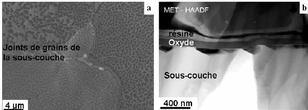
Figure 100 : Micrographies (a) MEB de surface en électrons secondaires (détecteur in-lens) et (b) MET en coupe de l'échantillon AM1/NiAlPt brut pré-oxydé à 900°C. Les différences de contraste de la micrographie (a) mettent en évidence la différence de taille et d'orientation des cavités interfaciales visibles par transparence.
