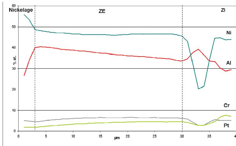
Figure 113 : Profils de concentration (%at.) dans la ZE de l'échantillon AM1/NiAlPt sablé pré-oxydé à 1000°C.
