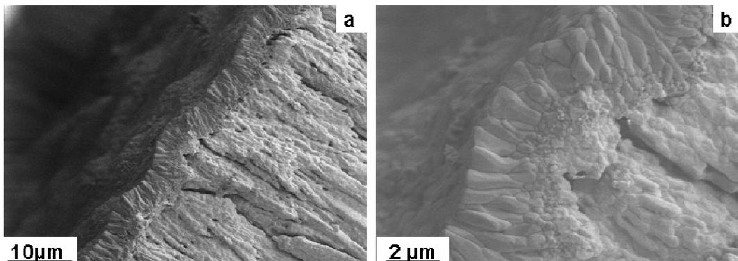
Figure 85 : Micrographies MEB de l'échantillon MCNG/NiAlPt/BT traité 1000 cycles
