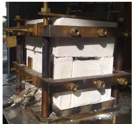
Figure 34: Insertion des capteurs S. A gauche en (1) pièce de maintien des capteurs. A droite le moule entièrement monté
