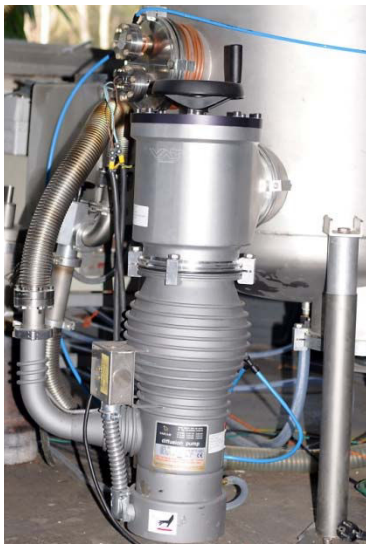
Figure 17: pompe à diffusion d'huile avec vanne Ø180.
