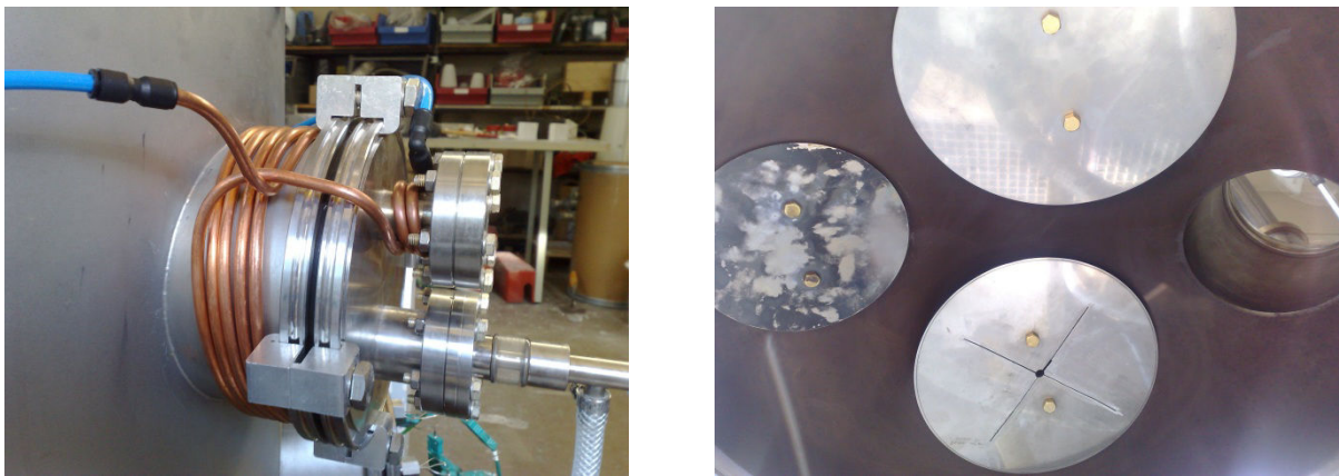
Figure 19: à gauche le circuit de refroidissement externe, à droite le bouclier thermique placé sous le couvercle
