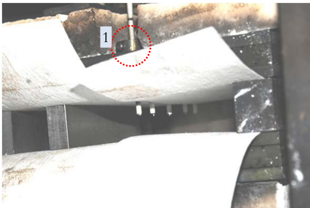
Figure 34: Insertion des capteurs S. A gauche en (1) pièce de maintien des capteurs. A droite le moule entièrement monté
