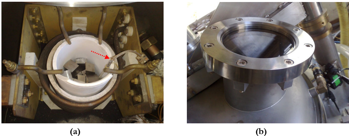
Figure 23: (a) Des barres ajustables permettent un maintien rigide du creuset, de la charge de métal et du capteur de température (flèche). (b) Le hublot par lequel il est possible de mesurer la température du bain avec un pyromètre optique.
