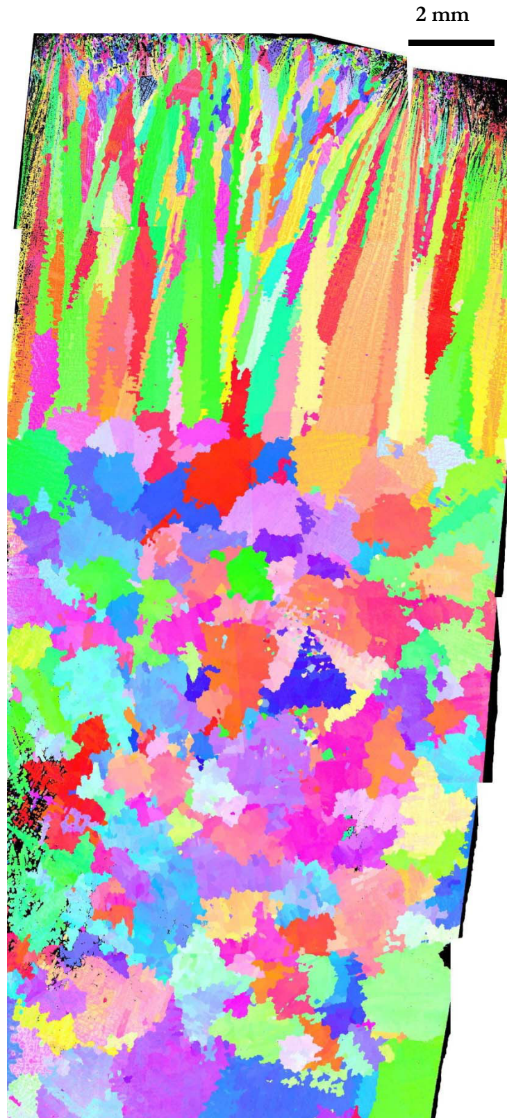
Figure 42: Structure granulaire de la plaque de 25 mm avec surchauffe de 25°C. Carte EBSD. Les zones sombres en bas à gauche sont des porosités. L'assemblage d'une dizaine de clichés pour composer cette vue globale induit des déformations et des défauts qui ne proviennent pas de la structure
