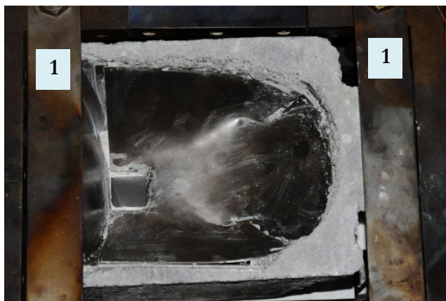
Figure 31: A gauche, le cône de coulée vu du dessus. La paroi interne métallique est insérée avant le moulage du béton. Les lamelles de laiton en 1 et 1' font partie de la chaîne de serrage du moule, sur le cône de coulée : elles permettent le serrage vertical du moule. À droite elles sont placées verticalement pour minimiser le risque de chute. En 2 les deux étages du cadre de serrage du moule. En 3 les bandes de feutre isolant encore visibles tant que le cône de coulée n'est pas monté
