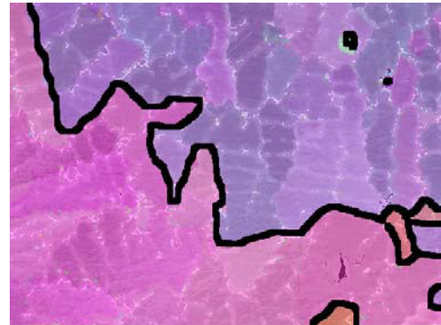
Figure 69: analyse de la coulée #4. Le joint de grain est surligné en noir.
