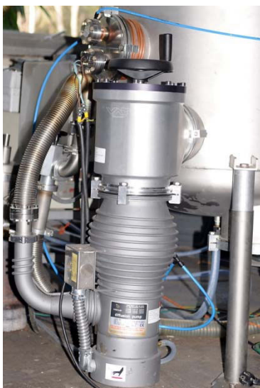
Figure 17: pompe à diffusion d'huile avec vanne Ø180.
