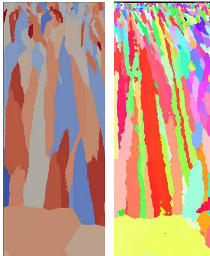
Figure 93 : comparaison qualitative des résultats de la simulation à gauche sur une coupe centrale d'un volume de section 1 mm par 1 mm et de longueur 5 mm avec les résultats expérimentaux (Structure granulaire de l'échantillon extrait de la plaque de 5 mm).
