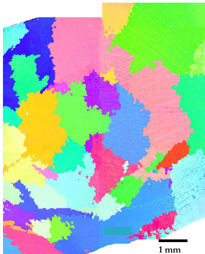
Figure 41: Structure granulaire d'un échantillon de la plaque de 10 mm avec surchauffe de 30°C. Carte EBSD.
