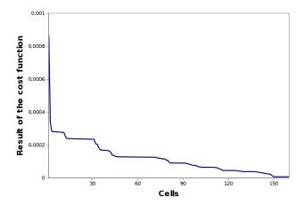
Figure 9 – Profil de la fonction de coût pour le circuit c432
