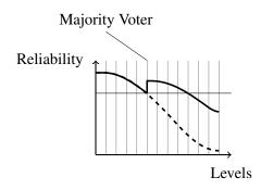
FIGURE 15 – L'insertion d'un arbitre dans un niveau aléatoire du circuit
