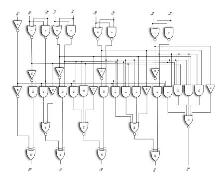
Figure 8 – Schéma en portes logiques du circuit 74283
