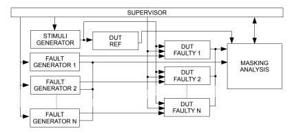
FIGURE 6 – L'architecture en parallèle proposée pour la FIFA
