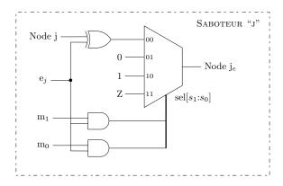
FIGURE 3 – Schéma général d'un saboteur
