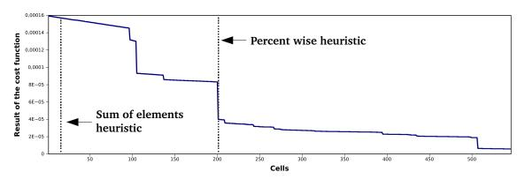
Figure 11 – L'utilisation des deux heuristiques dans le circuit c1355
