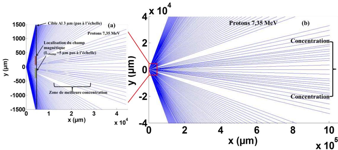
**Figure 2.51** Simulation PT pour une configuration de champ magnétique calculée pour une cible Al à 13,5 ps et une énergie de proton de 7,35 MeV. La distance source-zone de champ = 4,224 mm et la longueur de champ magnétique est de 5 μm. (a) Zoom de (b).
