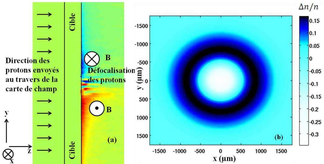
**Figure 2.5** (a) Illustration schématique d'une configuration de champ magnétique où le champ en face arrière est prédominant et dans laquelle on envoie des protons monoénergétiques de 10 MeV. (b) Déflexion 2D des protons correspondant sur un détecteur situé à 39 mm de la carte de champ.
