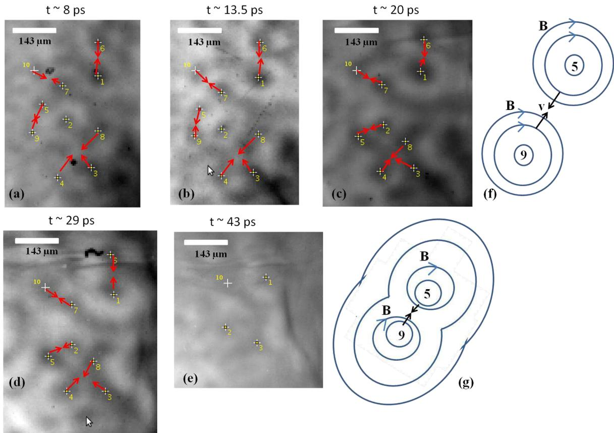
**Figure 2.42** Dynamique de coalescence des filaments dans le cas de Al pour (a) 8 ps, (b) 13,5 ps, (c) 20 ps, (d) 29 ps, (e) 43 ps et représentation de la reconnexion magnétique pour les filaments 9 et 5 à (f) 8 ps et (g) 13,5 ps.
