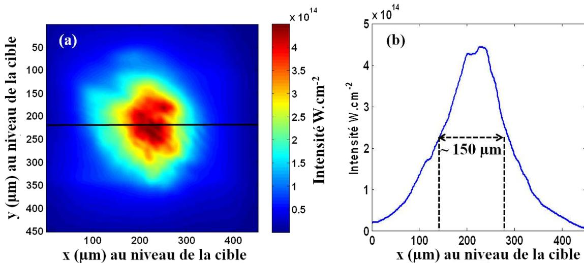
**Figure 1.6** (a) Distribution spatiale de l'intensité dans la tache focale pour une énergie sur cible de 349 J et une impulsion de 2 ns avec RPP et (b) coupe transverse de (a) pris à  $y = 220 \mu\text{m}$ .
