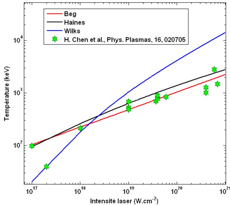
**Figure 2.1** Comparaisons entre les différentes lois théoriques ou empiriques permettant de retrouver la population électronique présente à l'intérieur de la cible. Les points expérimentaux sont tirés de la référence [33].
