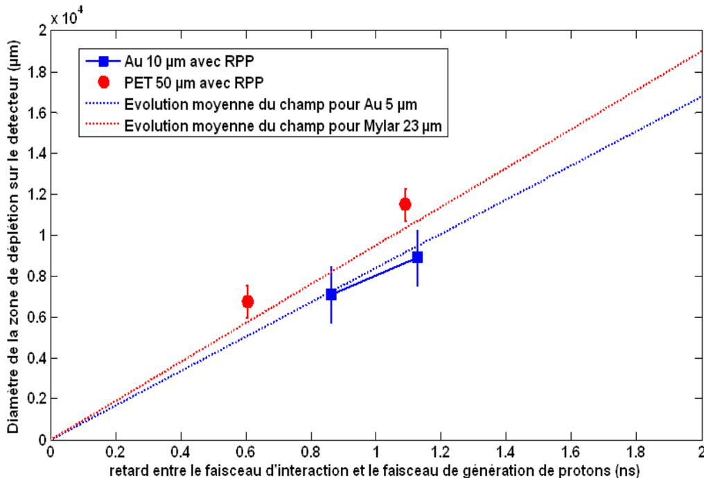
**Figure 1.24** Influence de l'épaisseur de cible sur le diamètre de la zone de déflexion sur le détecteur en fonction du retard entre le faisceau d'interaction et le faisceau de générations de protons avec RPP.  $t = 0$  est défini sur la Fig. 1.7.b.
