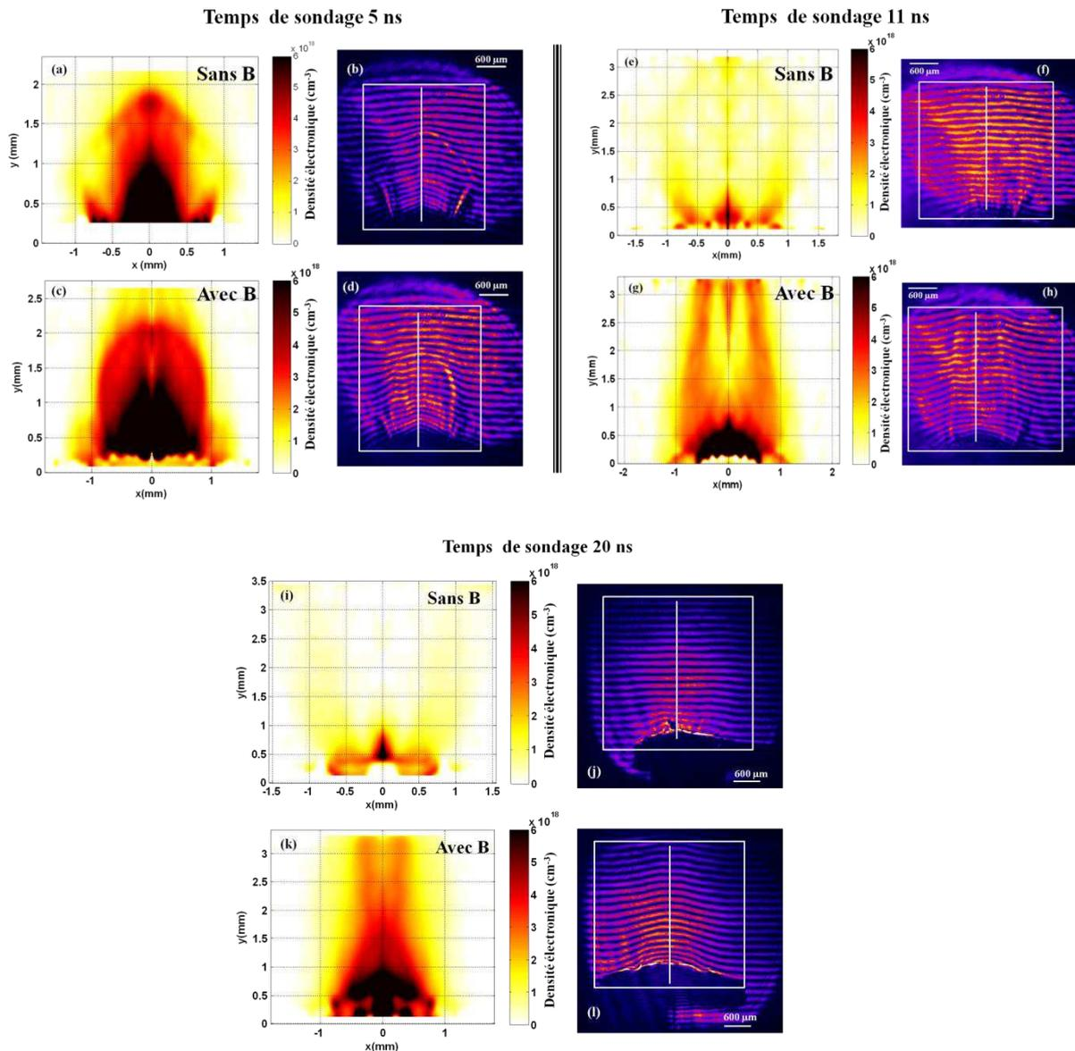
**Figure 3.19** Densité électronique calculée par inversion d'Abel dans le cas sans champ magnétique (a) à 5ns, (e) à 11 ns et (i) à 20 ns et images d'interférences correspondantes (b), (f) et (j) et dans le cas d'un champ magnétique d'environ 20 T (c) à 5 ns, (g) à 11 ns et (k) à 20 ns et et images d'interférences correspondantes (d), (h) et (l).
