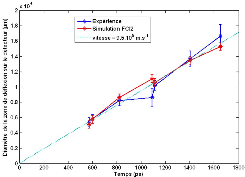
**Figure 1.29** Comparaison du diamètre de la zone de déflexion sur le détecteur entre les simulations FCI2 (chaque mesure représente une simulation) et l'expérience en fonction du temps au cours de l'interaction,  $t=0$  étant défini en Fig. 1.7.b.
