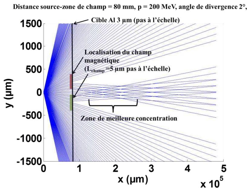
**Figure 2.55** Simulation PT pour une configuration de champ magnétique calculée pour une cible Al à 13,5 ps et une énergie de proton de 200 MeV. (a) La distance source-zone de champ = 80 mm, la divergence du faisceau est de  $2^\circ$  et la longueur de champ magnétique est de 5  $\mu\text{m}$ .
