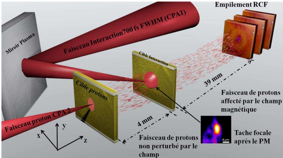
Figure 2.22 Montage expérimental.
