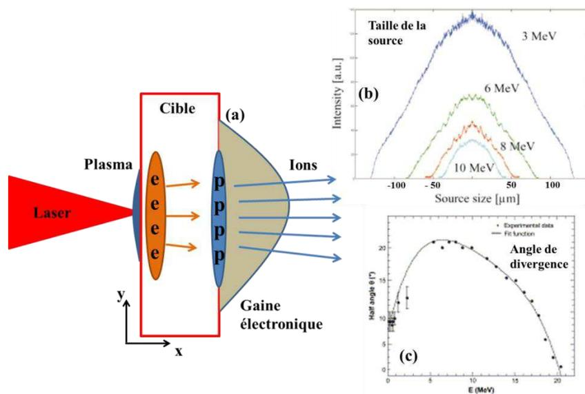
**Figure 2.35** (a) Représentation schématique de l'accélération par TNSA. (b) Extrait de [75] taille de la source de protons en face arrière de la cible pour différentes énergies de protons (c) Extrait de [74] Angle de divergence des protons en fonction de leurs énergies.
