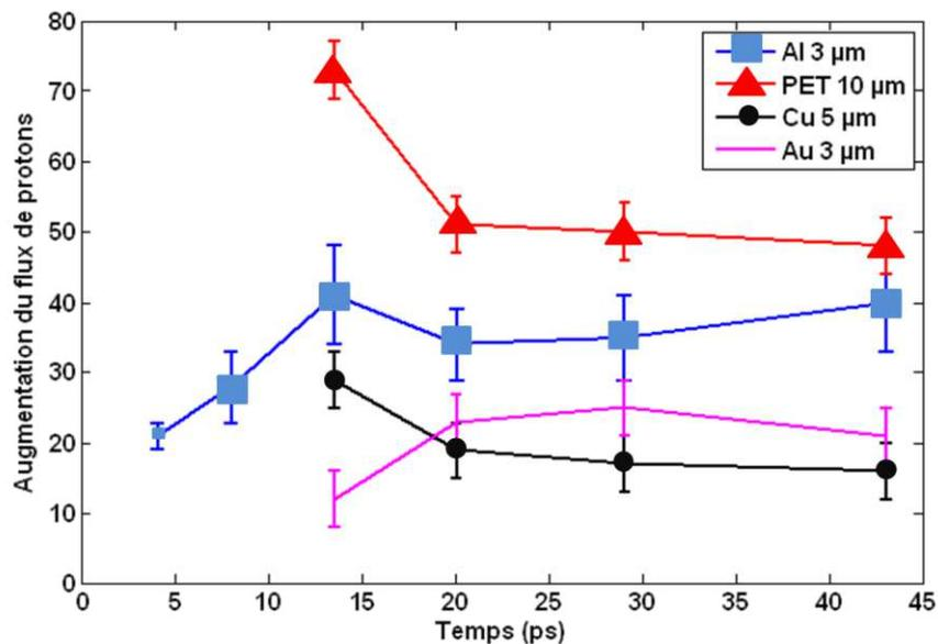
**Figure 2.49** Augmentation du flux de protons à 3.9 cm de la source en fonction du temps pour 4 différents matériaux.
