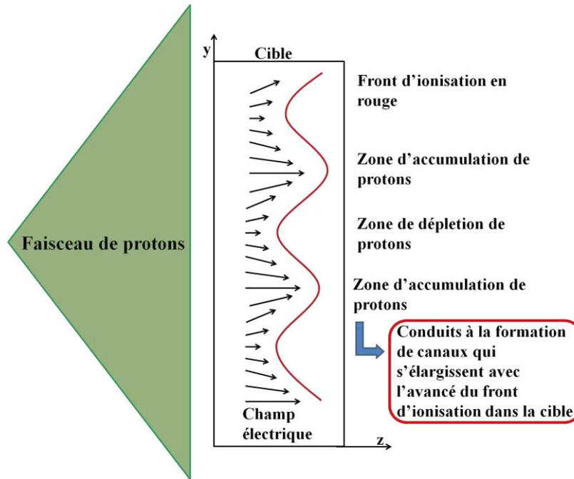
Figure 2.47 Illustration du mécanisme qui pourrait être responsable des canaux de déplétion de protons.
