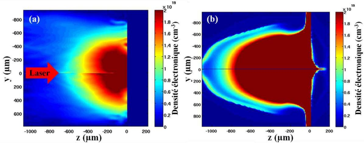
**Figure 1.26** Le laser se propage de la gauche vers la droite et irradie une cible solide de 23  $\mu\text{m}$  de Mylar à  $x = 0$   $\mu\text{m}$ . (a) Densité électronique à 1 ns reconstruite par inversion d'Abel et (b) densité électronique de la simulation FCI2 à 1,113 ns après le début de l'interaction,  $t=0$  étant défini sur la Fig. 7.b.
