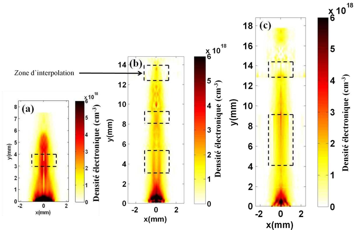
**Figure 3.25** Densité électronique calculée par inversion d'Abel pour une cible CH irradiée par un laser  $I \sim 10^{12}$   $W.cm^{-2}$  (a) 14 ns (b) 20 ns et (c) 29 ns après le début de l'interaction. Les zones en pointillées sont les zones qui ont été extrapolées.
