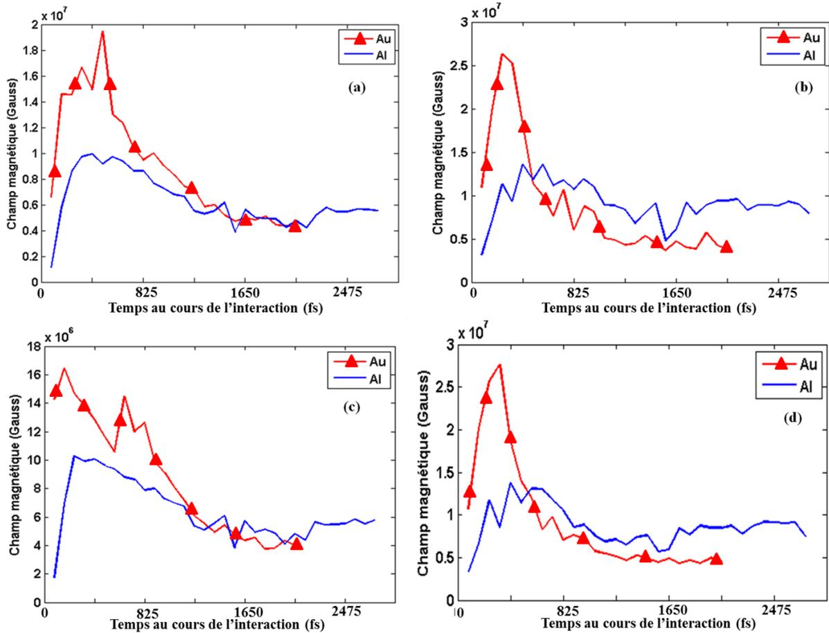
**Figure 2.10** Evolution de l'amplitude des champs magnétiques autogénérés (en valeur absolue) (a) partie haute et (c) partie basse de la Fig. 2.9 sur la face avant et (b) partie haute et (d) partie basse de la Fig. 2.9 sur la face arrière d'une cible Al et Au 3  $\mu\text{m}$ .
