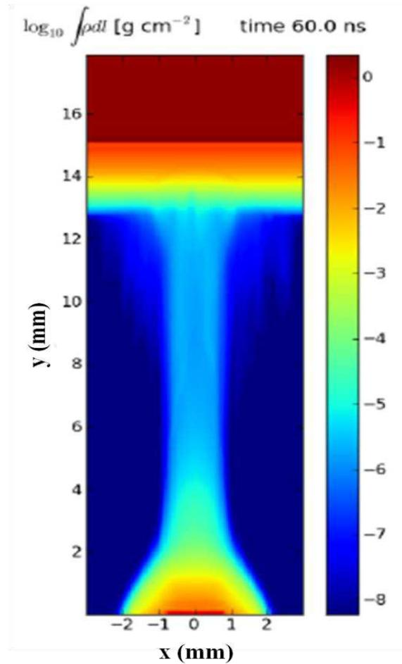
**Figure 3.41** Simulations GORGON d'un choc d'une colonne de plasma provenant de  $y = 0$  mm avec un mur situé à  $y=13$  mm pour nos conditions expérimentales. Extrait de la présentation de A.Ciardi HEDLA 2012.
