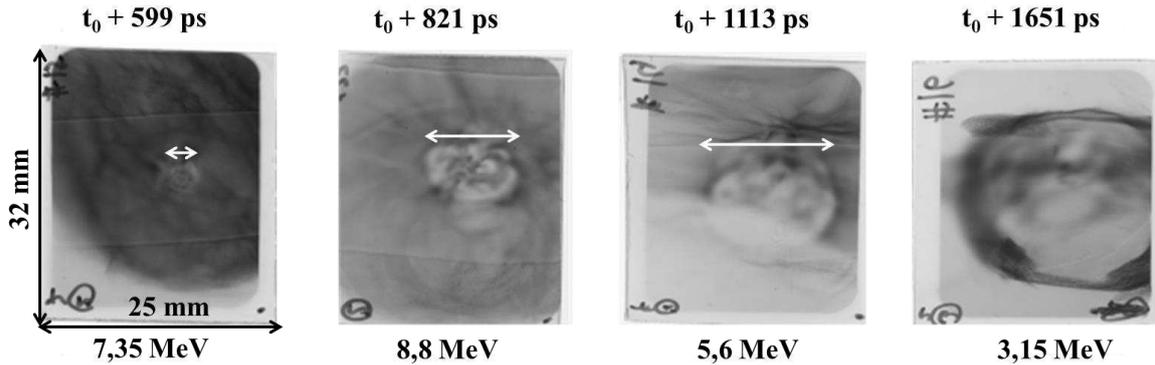
**Figure 1.17** Exemple de radiographie par protons pour différents temps de sondage explorés au cours de l'interaction pour une cible de Mylar. L'énergie de sondage des protons de la couche RCF qui est présentée est notée en dessous de l'image. Chaque RCF a pour taille réelle 32\*25 mm. La flèche blanche indique le diamètre de la zone de déplétion.
