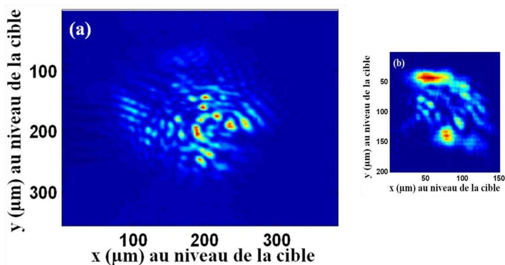
Figure 1.5 (a) Image à bas flux de la tache focale avec RPP, (b) Image à haut flux (tir pleine énergie) de la tache focale sans RPP (réponse percutielle).
