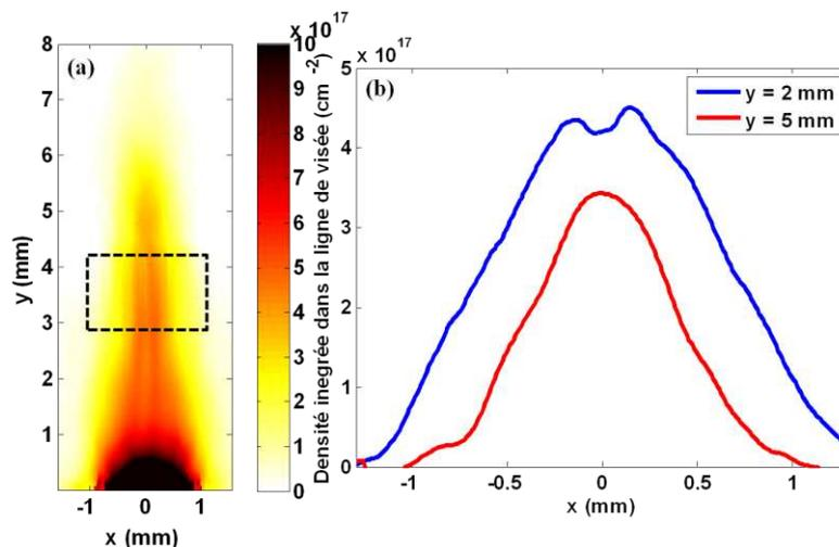
**Figure I. 5** (a) Densité intégrée sur la ligne de visée ( $\text{cm}^{-2}$ ) pour une cible de CH irradiée par un laser  $I \sim 10^{12}$   $\text{W.cm}^{-2}$  à 14 ns après le début de l'interaction (b) Coupe transverse de la densité intégrée à  $y = 2$  mm et  $y = 5$  mm.
