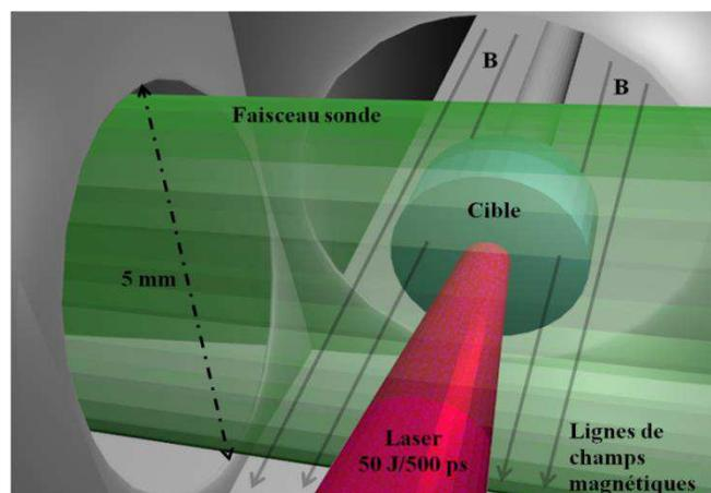
Figure 3.16 Montage expérimental.
