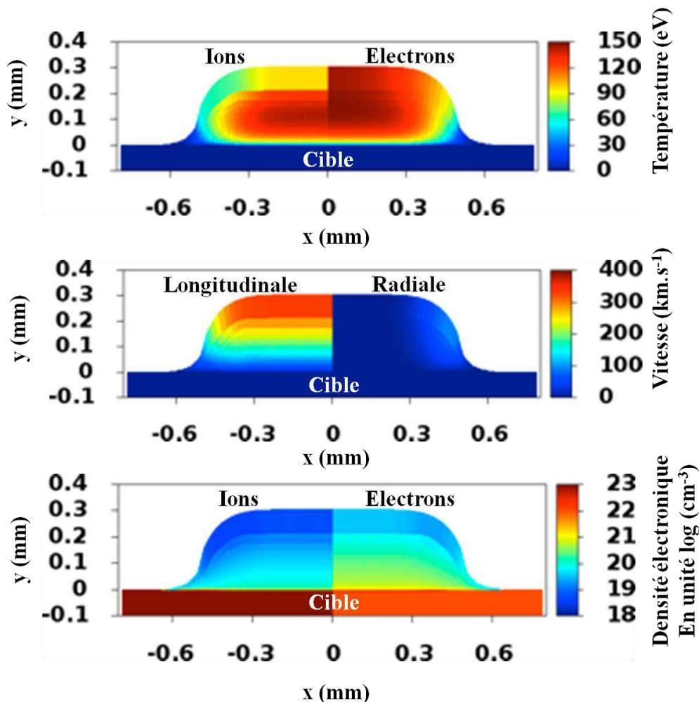
**Figure 3.27** Simulations DUED sans champ magnétique externe de l'irradiation laser d'une cible CH d'épaisseur 150  $\mu\text{m}$  par une impulsion d'énergie de  $\sim 4$  J, et de durée 400 ps FWHM produisant une intensité sur cible de l'ordre de  $10^{12}$   $\text{W}\cdot\text{cm}^{-2}$ . Toutes les cartes sont tracées à un temps de 1.2 ns après le début de l'interaction. Le laser provient du haut de la boîte et irradie la cible à  $y=0$  mm
