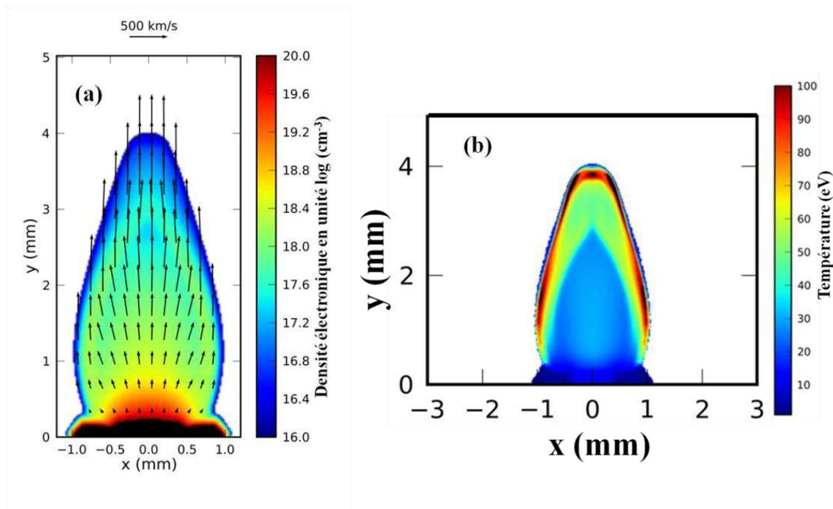
**Figure 3.32** Simulations GORGON pour 5 ns à  $I \sim 10^{12} \text{ W.cm}^{-2}$  pour un champ magnétique externe  $\sim 20 \text{ T}$  et pour une cible de C (a) densité électronique en unité  $\log(\text{cm}^{-3})$  et vecteur vitesse (le vecteur de normalisation est montré au-dessus de la figure) (b) température en eV de la plume plasma.
