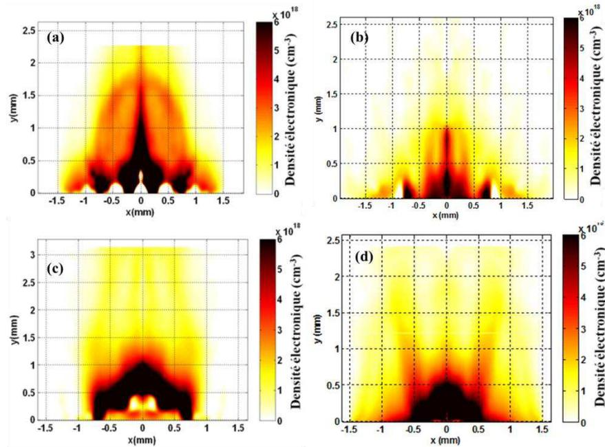
**Figure 3.22** Densité électronique déduite par inversion d'Abel pour une cible Cu irradié par un laser  $I \sim 10^{12}$   $W.cm^{-2}$  avec champ magnétique 20 T (a) à 5 ns (c) à 14 ns et sans champ magnétique (b) à 5 ns et (d) à 14 ns.
