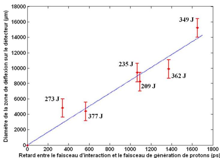
**Figure 1.21** Evolution du diamètre de la zone de déflexion de protons en fonction du retard entre le faisceau d’interaction et le faisceau de génération de protons pour le cas d’une cible Au. Les valeurs d’énergie absorbée par le plasma pour chaque tir sont notées à côté.  $t=0$  est défini sur la Fig. 1.7.b.
