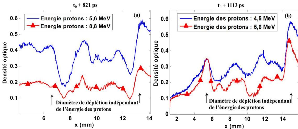
**Figure 1.18** (a) Coupe transverse à  $t = 821$  ps et (b) à  $t = 1113$  ps de la Fig. 1.17 pour différentes énergies de protons
