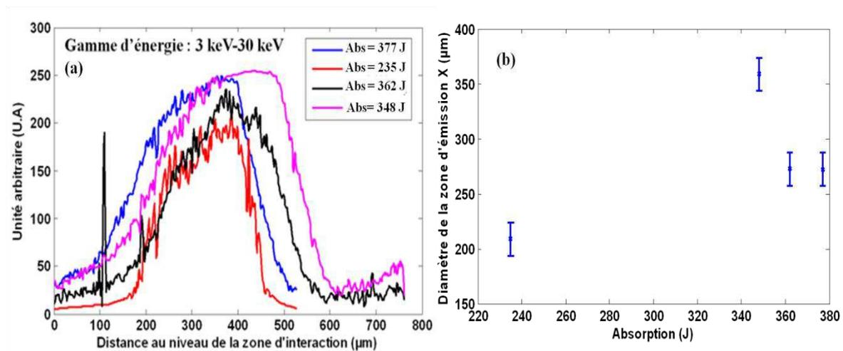
**Figure 1.15** (a) Coupe transverse de l'émission X pour une gamme d'énergie 3 keV-30 keV pour différentes valeurs d'énergie réfléchie par la cible, (b) Diamètre de l'émission X en fonction de l'absorption de l'énergie par la cible.
