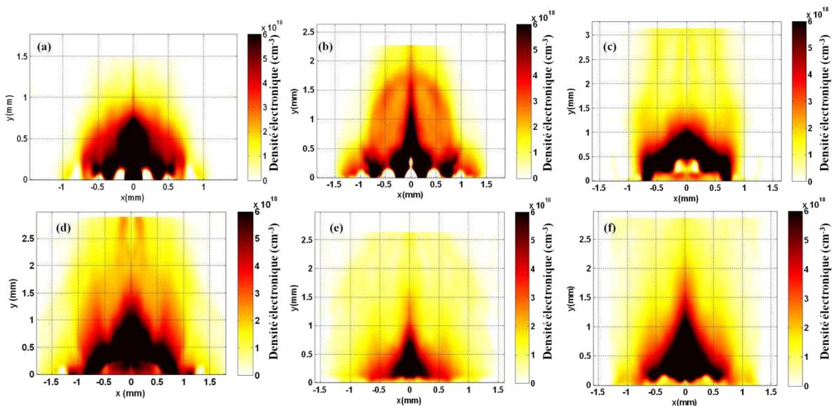
**Figure 3.23** Densité électronique déduite par inversion d'Abel pour une cible Cu irradié par un laser  $I \sim 10^{12}$   $W.cm^{-2}$  (a) 1 ns (b) 5 ns (c) 11 ns (d) 14 ns (e) 20 ns et (f) 29 ns après le début de l'interaction.
