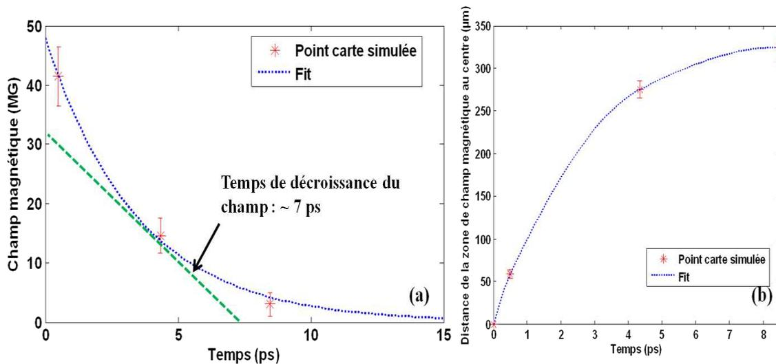
**Figure 2.31** (a) Représentation de l'évolution du champ magnétique sur la face arrière avec détermination du temps caractéristique de décroissance ( $\sim 7$  ps) (b) Evolution de la longueur de champ dans la direction parallèle à la surface de la cible.
