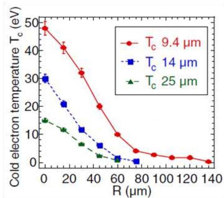
**Figure 2.16** Température des électrons froids en face arrière, après l'irradiation d'une cible d'Al d'épaisseur variable (indiquée par les symboles) par un laser de 320 fs, résultant de la bulbe plasma en fonction de la position dans la direction transverse, pour 3 épaisseurs de cibles différentes et le même matériau (Al). Figure extraite de [60].
