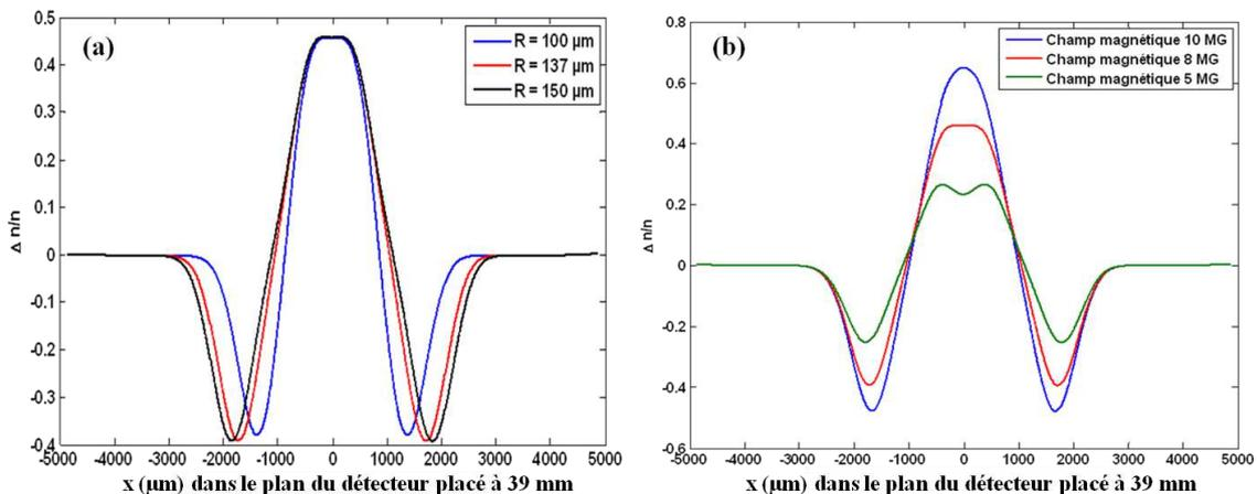
**Figure 2.29** (a) Influence de la longueur de champ magnétique sur la trajectoire des protons de 8.8 MeV, (b) Influence de l'amplitude de champ magnétique sur la trajectoire des protons de 8.8 MeV.
