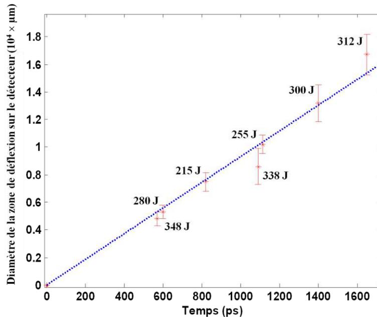
**Figure 1.19** Evolution du diamètre de la zone de déflexion de protons en fonction du retard entre le faisceau d'interaction et le faisceau de génération de protons pour le cas d'une cible de Mylar. Les valeurs d'énergie absorbée par le plasma pour chaque tir sont notées à côté.  $t = 0$  est défini sur la Fig. 1.7 .b.
