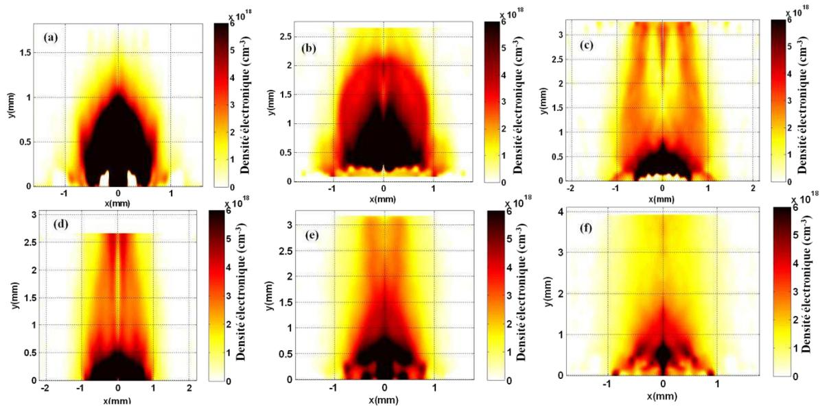
**Figure 3.21** Densité électronique déduite par inversion d'Abel pour une cible CH irradiée par un laser  $I \sim 10^{12}$   $W.cm^{-2}$  (a) 1 ns (b) 5 ns (c) 11 ns (d) 14 ns (e) 20 ns et (f) 29 ns après le début de l'interaction.
