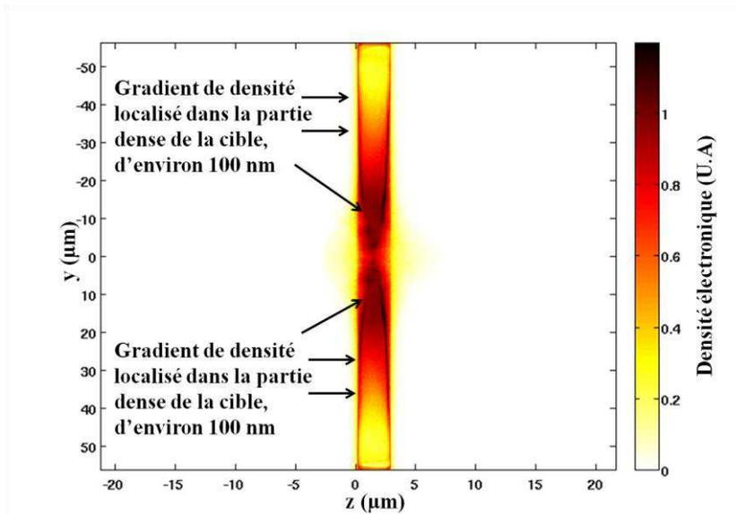
**Figure 2.17** Carte PICLS représentant la densité électronique à la fin de la simulation ( $\sim 1,65$  ps). On remarque un très fort gradient de densité (visualisation par les flèches noirs) dans la zone dense de la cible de l'ordre de  $L_n \sim 0.1 \mu\text{m}$ .
