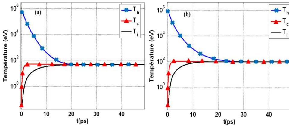
**Figure 2.14** (a) Evolution de la température des électrons froids ( $T_c$ ), des électrons chauds ( $T_h$ ) et des ions ( $T_i$ ) pour une impulsion laser de 700 fs, une intensité de  $1.10^{19} \text{ W.cm}^{-2}$ , une cible Al de  $3 \mu\text{m}$  et  $c_{ei} = 3.10^{17} \text{ W.m}^{-3} \cdot \text{K}^{-1}$  [58, 59] et (b) configuration similaire à (a) pour une intensité de  $5.10^{19} \text{ W.cm}^{-2}$ .
