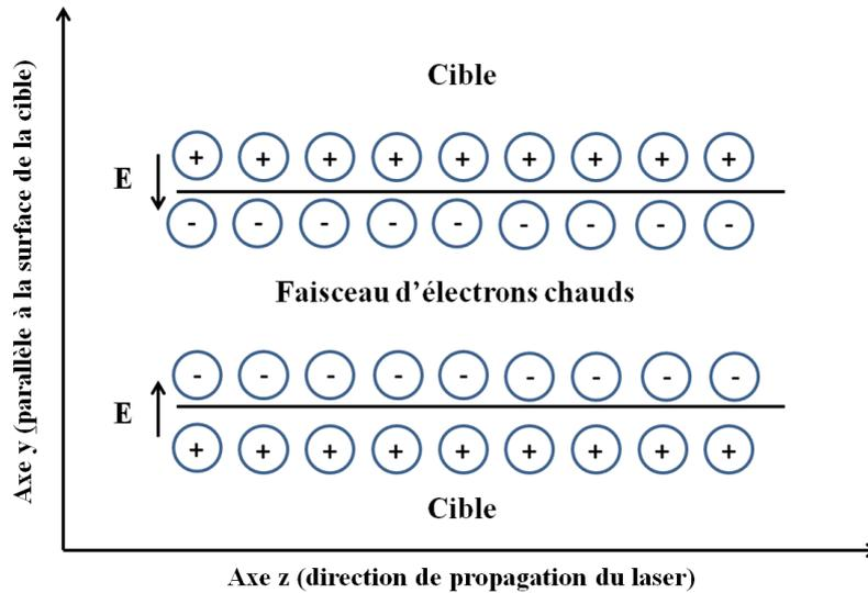
**Figure 2.45** Schéma illustrant l'émergence d'un fort champ électrostatique ionisant la cible dans le cas d'un diélectrique.
