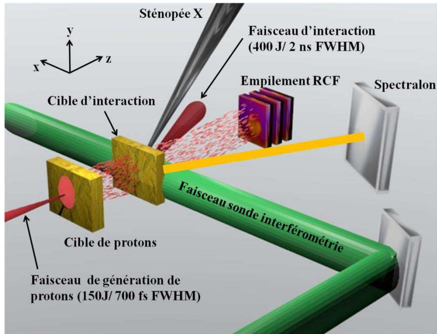
Figure 1.4 Montage expérimental.
