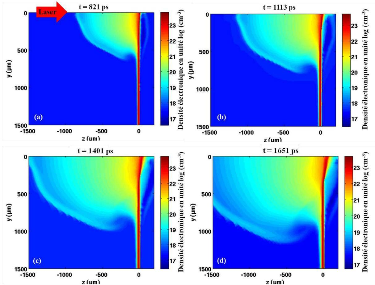
**Figure 1.25** Evolution des densités électroniques en  $\text{cm}^{-3}$  au cours du temps modélisé par FCI2 pour un demi-plan. Le laser se propage de la gauche vers la droite et irradie une cible de Mylar de  $23 \mu\text{m}$  d'épaisseur à  $x = 0 \mu\text{m}$  pour (a)  $t = 821$  ps, (b)  $t = 1113$  ps, (c)  $t = 1401$  ps et (d)  $t = 1651$  ps où  $t = 0$  est défini sur la Fig. 1.7.b.
