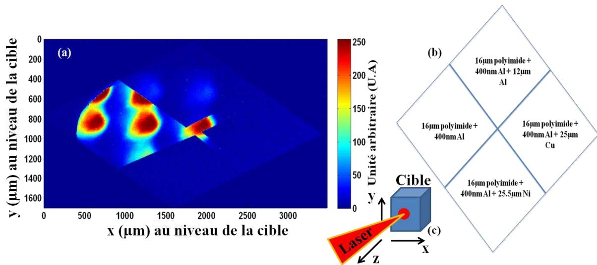
**Figure 1.10** (a) Résultat expérimental pour une cible Au à 1,5 ns après le début de l'interaction. Les distances sont données au niveau de la cible. (b) illustration des différents filtres présents en face avant de la CCD, (c) représentation du montage expérimental.
