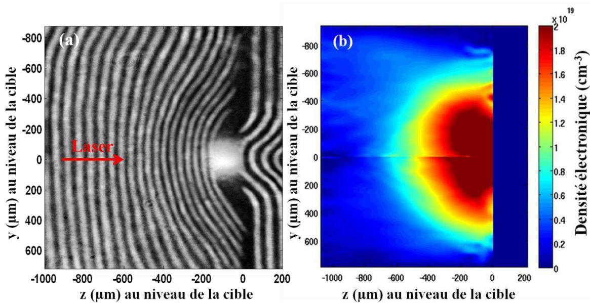
**Figure 1.11** Exemple de données expérimentales (a) interférogramme (b) densité électronique en  $\text{cm}^{-3}$  calculée par inversion d'Abel pour une cible de Mylar  $23 \mu\text{m}$  à  $t = 1 \text{ ns}$  après le début de l'interaction,  $t=0$  étant défini sur la Fig. 1.7.b.
