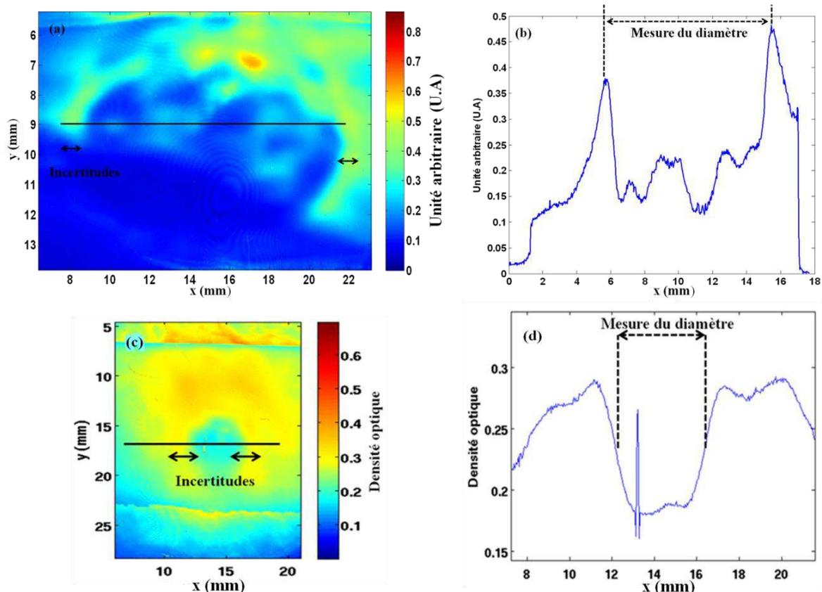
**Figure 1.22** Visualisation de l'incertitude de mesure pour le cas (a) d'une cible de Mylar sondée à  $t=1113$  ps après le début de l'interaction,  $t=0$  étant défini en Fig. 1.7.b (b) coupe transverse de (a), et (c) pour une cible Au sondée à 562 ns après le début de l'interaction ;  $t=0$  étant défini en Fig. 1.7.b (d) coupe transverse de (c). Ces mesures sont données au niveau du RCF.
