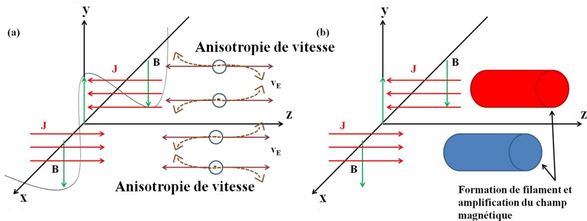
**Figure 2.39** Représentation schématique de l'instabilité de Weibel ou de filamentation de courant. (a) Petite anisotropie de la distribution de vitesse des électrons (lignes pointillées), dans la direction transverse à la perturbation du champ B (b) entraînant la formation de filament et de l'amplification du champ magnétique.
