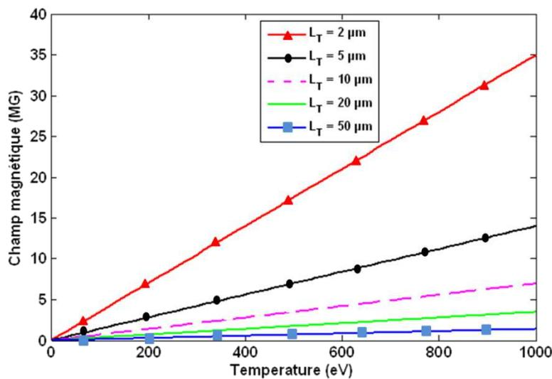
**Figure 2.18** Amplitude de champ magnétique (MG) en fonction de la température pour différentes longueurs de gradient de température, avec  $L_n = 0.1 \mu\text{m}$ .
