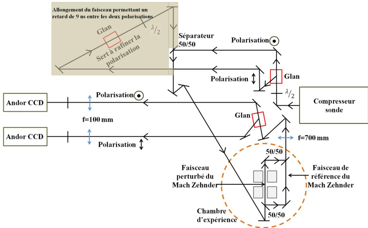
Figure 3.18 Schéma expérimental de la ligne de diagnostic.
