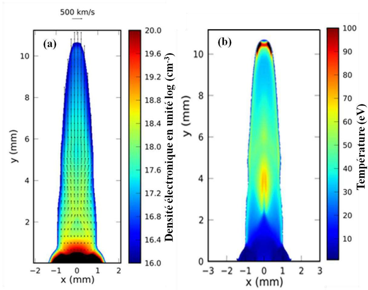
**Figure 3.34** Simulations GORGON à 15 ns pour  $I \sim 10^{12} \text{ W.cm}^{-2}$  et un champ magnétique externe  $\sim 20 \text{ T}$  et pour une cible de C (a) densité électronique en unité  $\log(\text{cm}^{-3})$  et vecteur vitesse (le vecteur de normalisation est montré au-dessus de la figure) (b) température en eV de la plume plasma.
