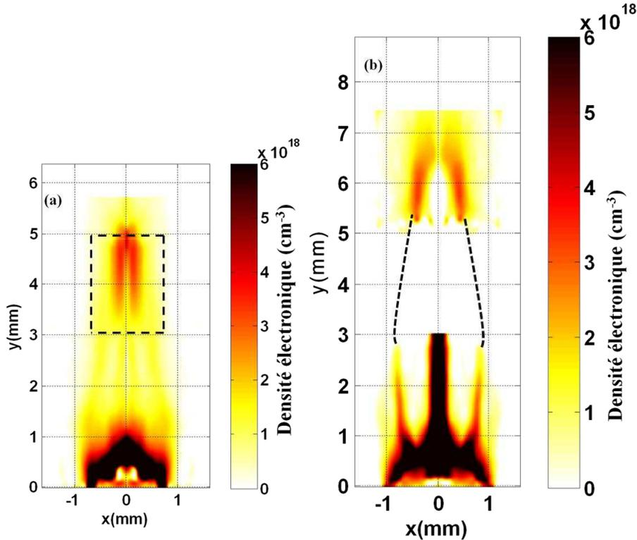
**Figure 3.26** Densité électronique calculée par inversion d'Abel pour une cible Cu irradié par un laser (a)  $I \sim 10^{12}$   $\text{W.cm}^{-2}$  et (b)  $I \sim 10^{13}$   $\text{W.cm}^{-2}$  11 ns après le début de l'interaction. Les zones en pointillées sont les zones qui ont été extrapolées.
