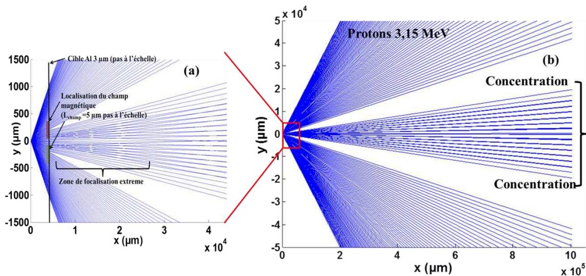
**Figure 2.50** Simulation PT pour une configuration de champ magnétique calculée pour une cible Al à 13,5 ps et une énergie de proton de 3,15 MeV. . La distance source-zone de champ = 4,814 mm et la longueur de champ magnétique est de 5 μm. (a) Zoom de (b).
