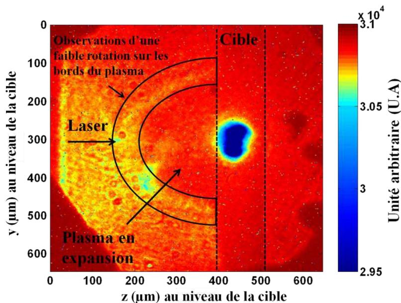
**Figure 1.12** Exemple de polarimétrie sur une cible Au  $5 \mu\text{m}$ ,  $1 \text{ ns}$  après le début de l'interaction.
