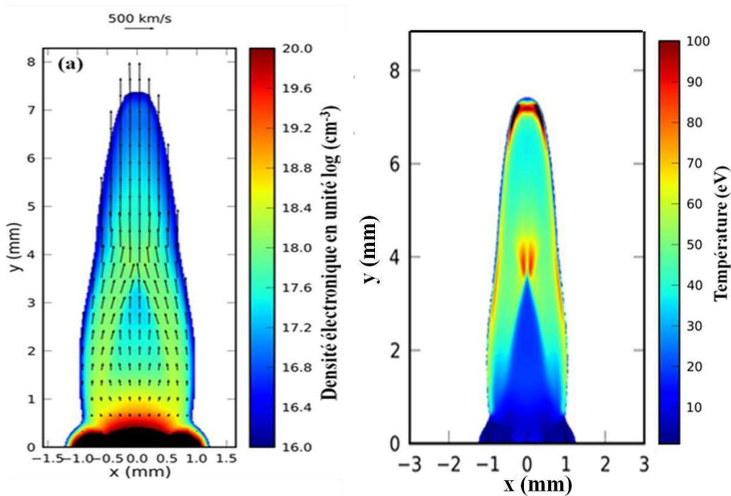
**Figure 3.33** Simulations GORGON pour 10 ns à  $I \sim 10^{12} \text{ W.cm}^{-2}$  pour un champ magnétique externe  $\sim 20 \text{ T}$  et pour une cible de C (a) densité électronique en unité  $\log(\text{cm}^{-3})$  et vecteur vitesse (le vecteur de normalisation est montré au-dessus de la figure) (b) température en eV de la plume plasma.
