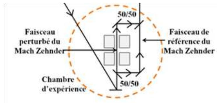
Figure I.1 Intérféromètre Mach Zehnder.
