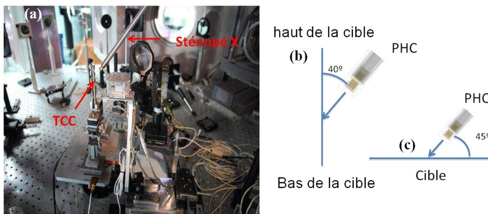
**Figure 1.9** (a) Implantation du sténopé X dans la chambre d'expérience, (b) angle du sténopé X par rapport à la normale verticale (vue de côté), (c) angle du sténopé X par rapport à la normale horizontale (vue du dessus).
