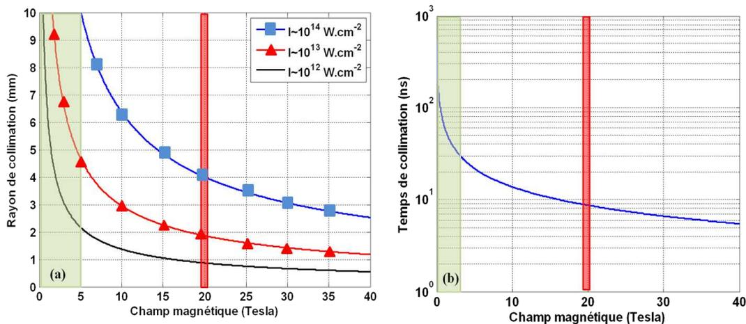
**Figure 3.13** (a) Rayon de collimation en fonction du champ magnétique externe appliqué, pour différentes valeurs d'intensités laser et (b) temps de collimation en fonction du champ magnétique externe appliqué.
