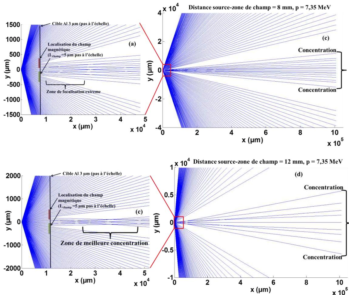
**Figure 2.54** Simulation PT pour une configuration de champ magnétique calculée pour une cible Al à 13,5 ps et une énergie de proton de 7,35 MeV. (a) La distance source-zone de champ = 8 mm et la longueur de champ magnétique est de 5 μm (b) propagation du faisceau à ~ 1 m de la zone de champ. (c) La distance source-zone de champ = 12 mm et la longueur de champ magnétique est de 5 μm (b) propagation du faisceau à ~ 1 m de la zone de champ.
