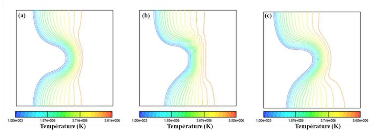
**Figure 1.2** Simulations CHIC représentant les iso températures (Kelvin) dans le cas où on utilise la théorie de (a) Braginskii sans effet Righi-Leduc (b) on traite le flux de chaleur par conductivité effective, (c) ou via la formulation tensorielle de l'effet Righi-Leduc. Chaque figure est un carré de 20  $\mu\text{m}$  par 20  $\mu\text{m}$ . Extrait de [27].
