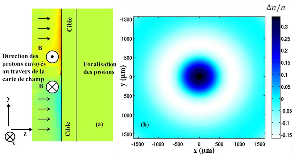
**Figure 2.6** (a) Illustration schématique d'une configuration de champ magnétique où le champ en face avant est prédominant et dans laquelle on envoie des protons monoénergétiques de 10 MeV. (b) Déflexion 2D des protons correspondant sur un détecteur situé à 39 mm de la carte de champ.
