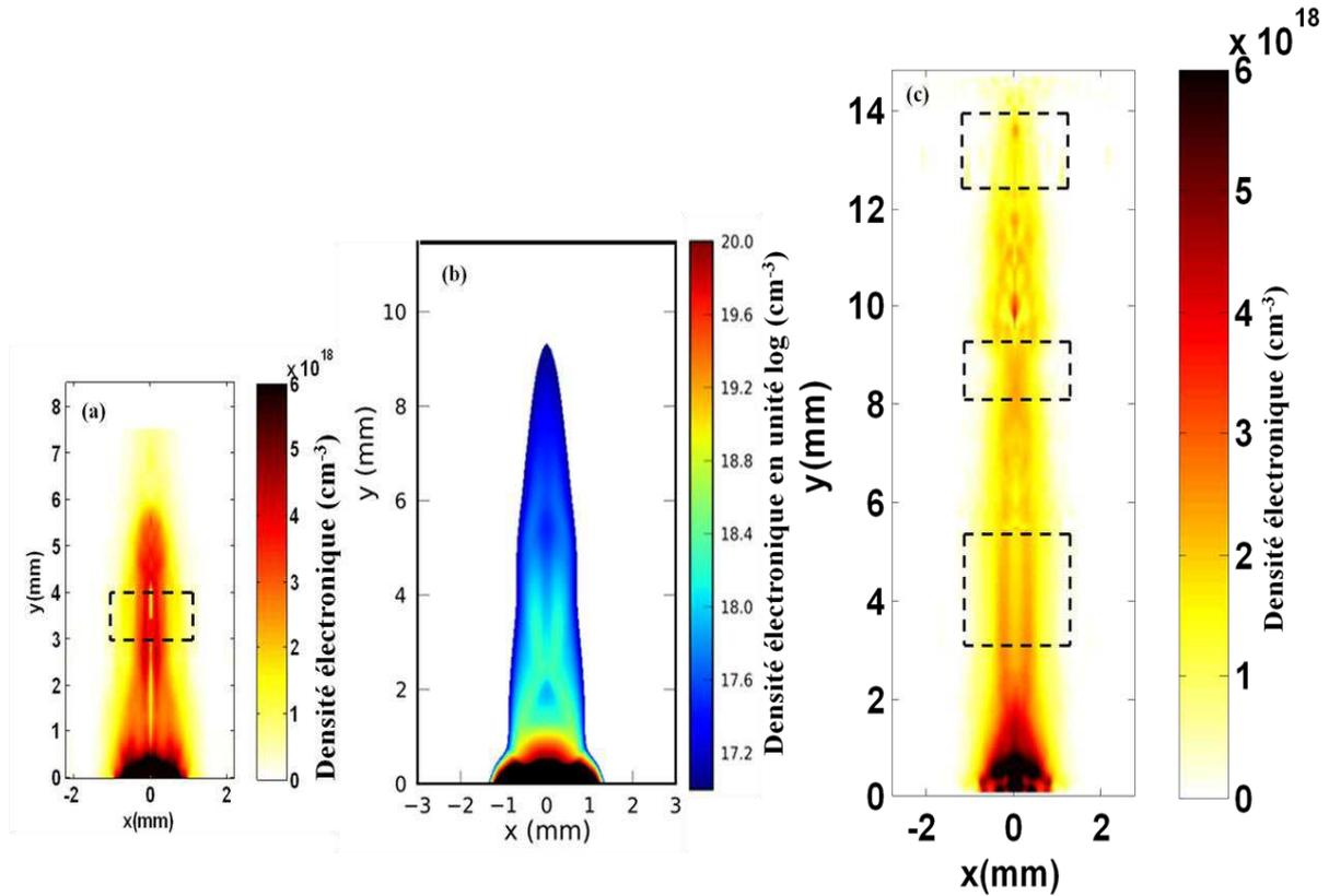
**Figure 3.31** Comparaisons entre données expérimentales et simulations GORGON à temps longs. (a) jet reconstruit à 14 ns, (b) Simulations GORGON à 15 ns et (c) jet reconstruit à 20 ns. Les zones en pointillées sont les zones qui ont été extrapolées.
