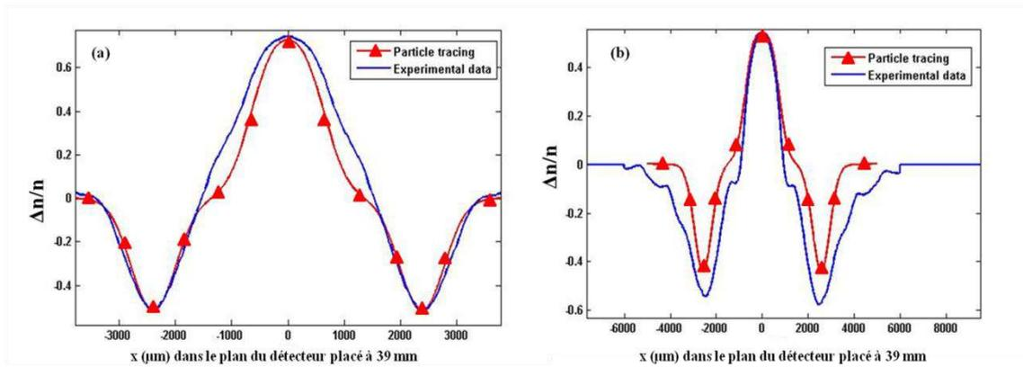
**Figure 2.33** Comparaisons entre les données expérimentales et les cartes simulées au moyen du code de déflectométrie (cf. chapitre 1) pour Al 3  $\mu m$  avec un champ magnétique uniquement présent en face avant : (a) à  $t=13,5$  ps, (b) à  $t=20$  ps.
