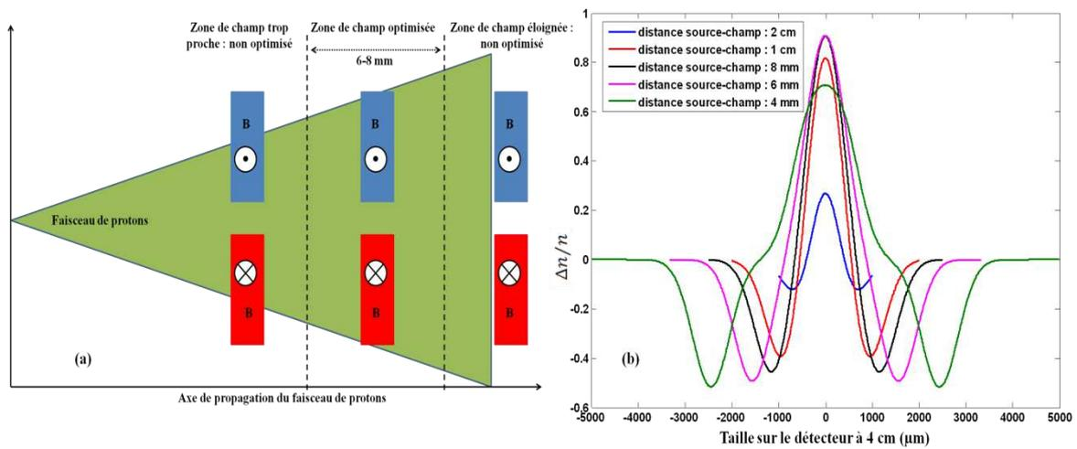
**Figure 2.53** (a) Représentation schématique de l'optimisation de la distance source-champ (b) Simulations de la variation de densité  $\frac{\Delta n}{n}$  en fonction de la distance source-champ pour la configuration de champ Al à 13,5 ps et des protons de 7,35 MeV.
