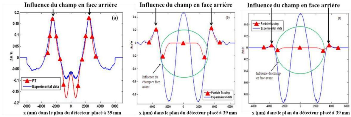
**Figure 2.30** Comparaisons entre les données expérimentales et les cartes simulées pour Al 3  $\mu\text{m}$  avec un champ magnétique uniquement présent en face arrière : (a) à  $t=0-1$  ps, (b) à  $t=4$  ps et (c) à  $t=8$  ps.
