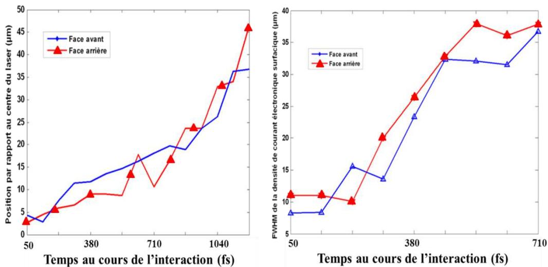
**Figure 2.12** (a) Evolution de la position du maximum de densité électronique surfacique au cours de la simulation et (b) évolution de la FWHM de la densité de courant électronique surfacique au cours de la simulation pour une cible Au.
