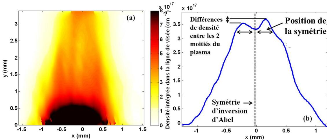
**Figure I.3** (a) Densité intégrée sur la ligne de visée ( $\text{cm}^{-2}$ ) pour une cible de CH irradiée par un laser  $I \sim 10^{12} \text{ W.cm}^{-2}$  et à  $t \sim 10 \text{ ns}$  après le début de l’interaction (b) Coupe transverse de la densité intégrée à  $y = 2.7 \text{ mm}$  où la différence de mesures entre les deux maxima de densité détermine les incertitudes que nous allons avoir.
