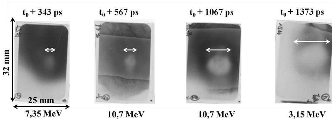
**Figure 1.20** Exemple de radiographie par protons à travers une cible d’Au de 3  $\mu\text{m}$  d’épaisseur pour différents temps au cours de l’interaction. L’énergie des protons de la couche RCF qui est présentée est notée en dessous de l’image. Chaque RCF a pour taille 32\*25 mm. La flèche blanche indique le diamètre de la zone de déplétion.
