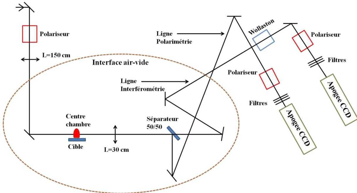
Figure 1.13 Dispositif expérimental concernant la polarimétrie et l'interférométrie.
