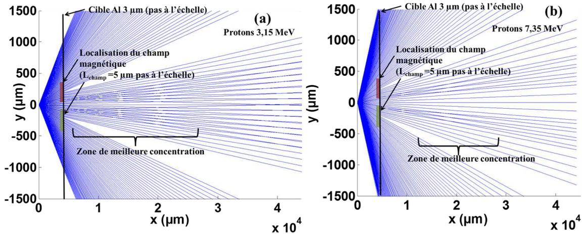
**Figure 2.37** Simulation PT pour une configuration de champ magnétique calculée pour une cible Al à 13,5 ps et (a) une énergie de proton de 3,15 MeV et (b) de 7,35 MeV. La distance source-zone de champ est de 4,814 μm pour le cas 3,15 MeV et de 4,224 mm pour le cas 7,35 MeV, la longueur de champ magnétique est de 5 μm et la distance-zone de champ détecteur est de 4 cm.
