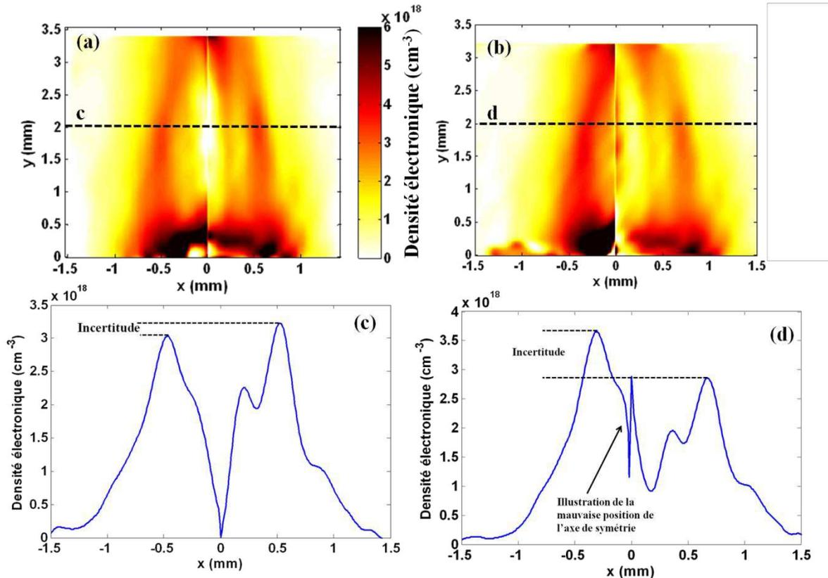
**Figure I.7** Illustration de l'importance de l'axe de symétrie. (a) Inversion d'Abel où l'axe de symétrie est à peu près bien placé et (c) coupe transverse à  $y = 2$  mm associée. (b) Inversion d'Abel où l'axe de symétrie est légèrement décalé ( $\sim 100 \mu\text{m}$ ) par rapport à (a) et (d) coupe transverse à  $y = 2$  mm associée.
