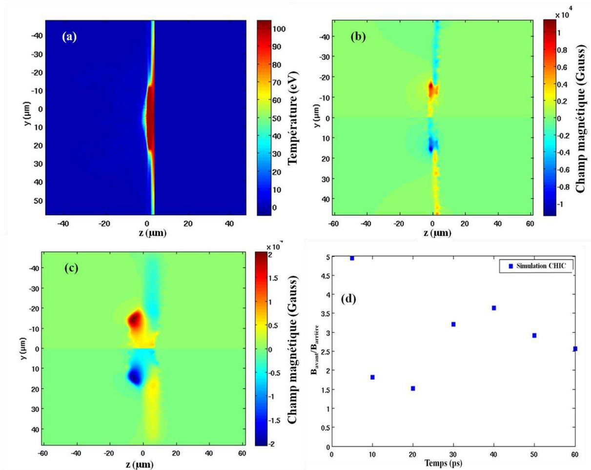
**Figure 2.19** a) Distribution spatiale de la température pour une cible Al  $3\ \mu\text{m}$ . Simulation CHIC représentant le champ magnétique autogénéré en utilisant en paramètres d'entrée la carte de densité de la Fig. 2.17 et la carte de température de a) pour b)  $t = 10$  ps, c)  $t = 40$  ps. d) Évolution du rapport  $B_{\text{avant}}/B_{\text{arrière}}$  en fonction du temps pour la simulation CHIC.
