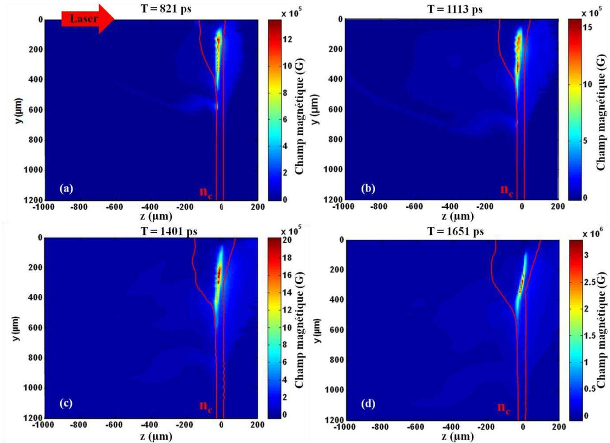
**Figure 1.27** Evolution des champs magnétiques en Gauss au cours du temps modélisé par FCI2 pour un demi-plan. Le laser se propage de la droite vers la gauche et irradie une cible de Mylar de  $23 \mu\text{m}$  d'épaisseur à  $x = 0 \mu\text{m}$  pour (a)  $t = 821 \text{ ps}$ , (b)  $t = 1113 \text{ ps}$ , (c)  $1401 \text{ ps}$  et (d)  $t = 1651 \text{ ps}$  où  $t = 0$  est défini sur la Fig. 1.7.b.
