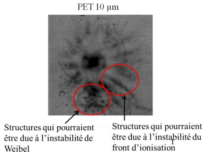
**Figure 2.44** Observations expérimentales de structures magnétiques à petite échelle en périphérie de la structure magnétique à grande échelle pour une cible de PET  $10\ \mu\text{m}$  à 13.5 ps après le début de l'interaction.
