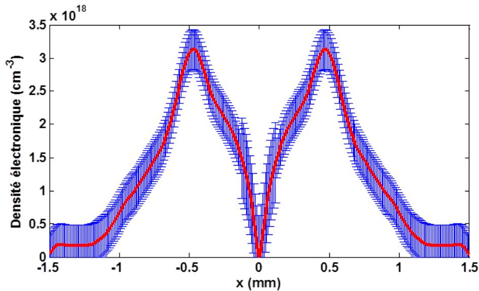
**Figure I. 9** Coupe transverse à  $y = 1,8$  mm du demi plan gauche de la Fig. I.6.a symétrisée avec visualisation des incertitudes liées à l'inversion d'Abel. La morphologie globale n'est pas modifiée par rapport à nos analyses de cartes de phases.
