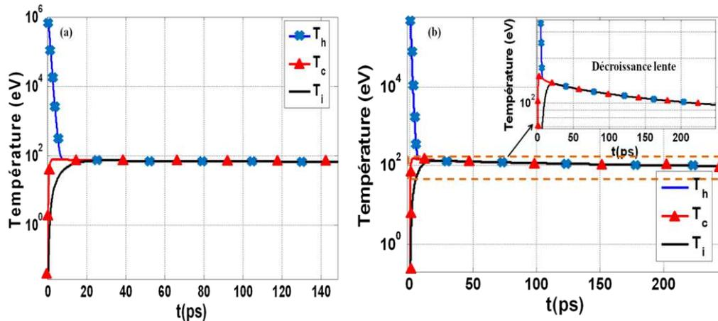
**Figure 2.15** (a) Evolution de la température des électrons froids ( $T_c$ ), des électrons chauds ( $T_h$ ) et des ions ( $T_i$ ) pour une impulsion laser de 700 fs, une intensité de  $1.10^{19} \text{ W.cm}^{-2}$ , une cible Au de  $3 \mu\text{m}$  et  $c_{ei} = 3.10^{16} \text{ W.m}^{-3}.\text{K}^{-1}$  et (b) configuration similaire à (a) pour une intensité de  $5.10^{19} \text{ W.cm}^{-2}$ .
