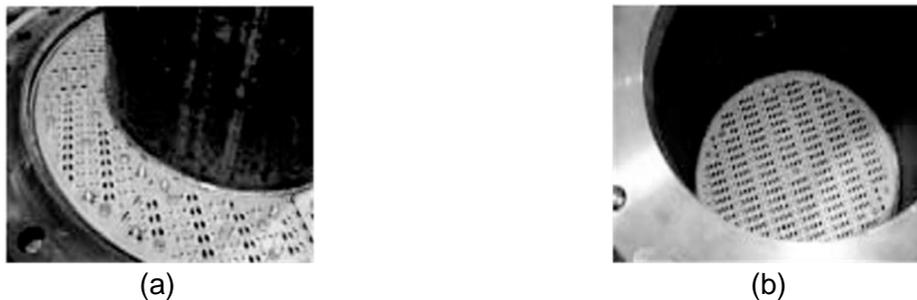
Figure 2.4 : Colonne de distillation diabatique bitube, (a) section d'épuisement, (b) section de rectification
