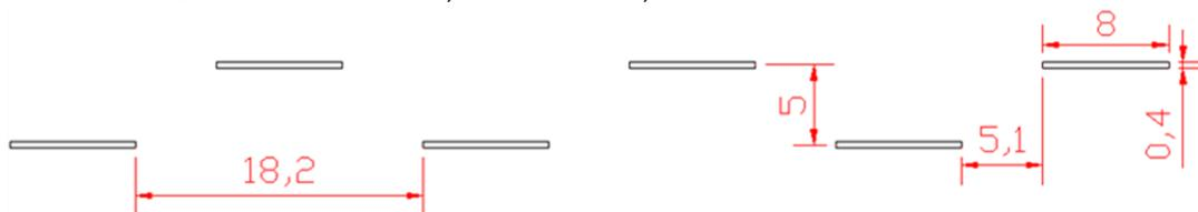
Figure 3.10 : Caractéristiques géométriques des fentes rectangulaires horizontales
