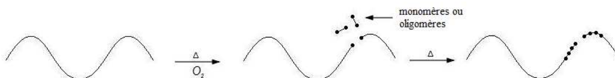
Figure III-11. Schématisation d'une dépolymérisation activée par une coupure de chaîne
