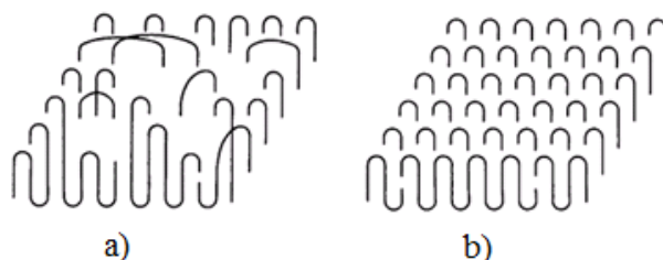
Figure I-8. Modèle de formation des lamelles a) Repliement aléatoire, b) Repliement adjacent
