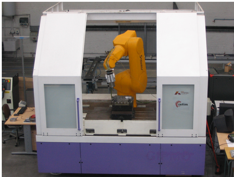
FIGURE 2: Robot Staubli 6 axes équipé d'une électrobroche UGV
