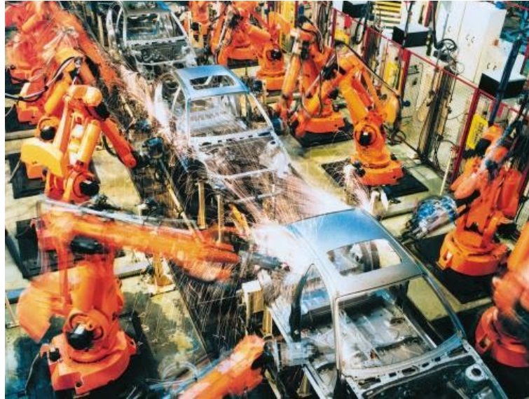
FIGURE 1.1: Une ligne de soudage par points à l'aide des robots
