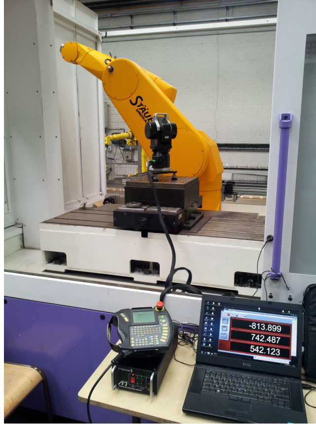
FIGURE 3.4: Installation expérimentale du dispositif de mesure Laser
