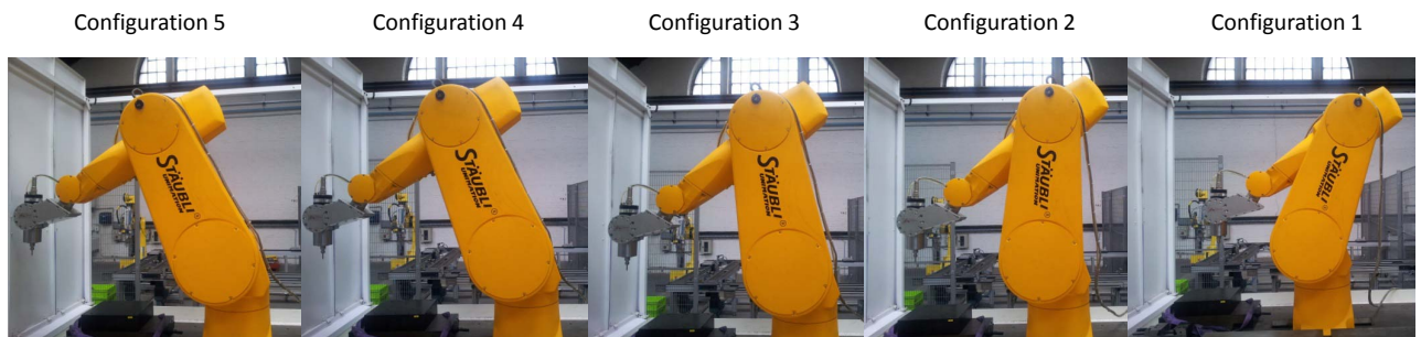
FIGURE 4.26: Différentes configurations utilisées avec le chargement du robot (broche montée)
