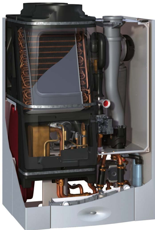
Figure 10 : Chaudière hybride de 1 ère génération (Mégalis Condens Hybride) : Combinaison innovante et compacte d'une chaudière gaz à condensation et d'une pompe à chaleur
