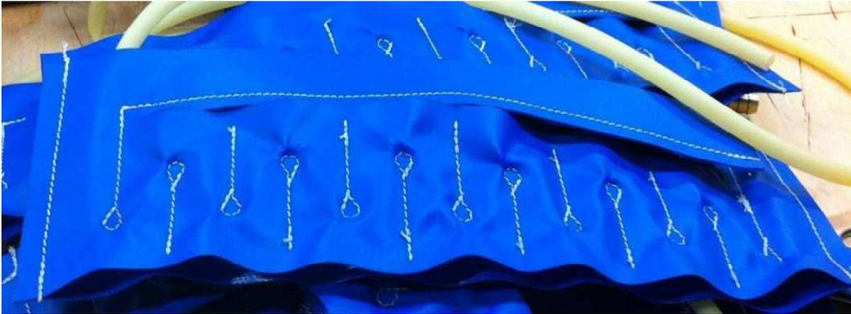
**Fig. III-1 : Muscle pneumatique Otherlab.**
