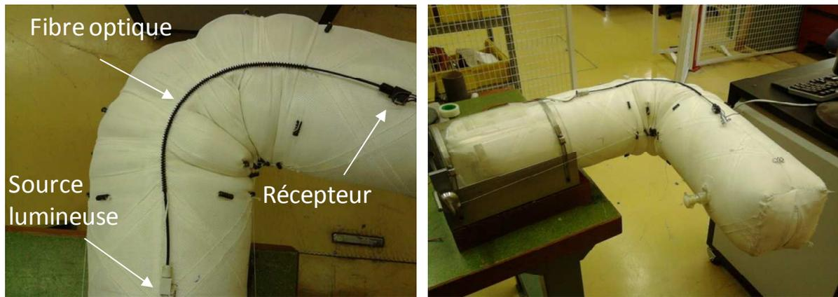
**Fig. III-8: Capteur optique monté sur une articulation.**
