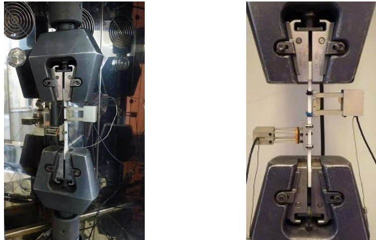
Figure 13 : Éprouvette ISO 527 Type 1A placée entre les deux mors de la machine de traction avec son enceinte climatique (à gauche) et les extensomètres à couteaux placés sur cette même éprouvette (à droite)
