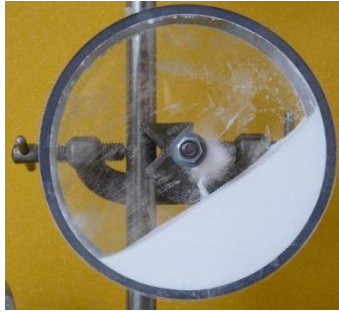
Figure 25 : Mesure des angles de rupture et de repos à l'aide d'un tambour tournant
