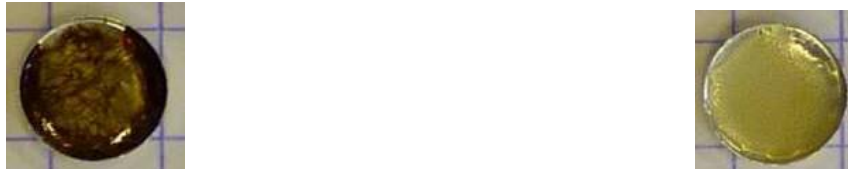
Figure 37 : Creuset contenant le PPA après calorimétrie différentielle à balayage de la poudre de PPA sous air (à gauche) et sous flux d'argon (droite)
