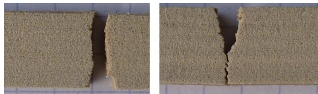
Figure 61 : Faciès de rupture observés sur les éprouvettes de PEEK_B consolidées dans le plan XZ
