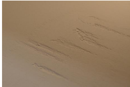
Figure 33 : Photographie d'une couche de poudre de PEKK_B présentant des arrachements de matière (photographie Poly-Shape)
