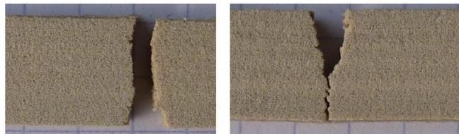
**Figure 61 : Faciès de rupture observés sur les éprouvettes de *PEEK\_B* consolidées dans le plan XZ**
