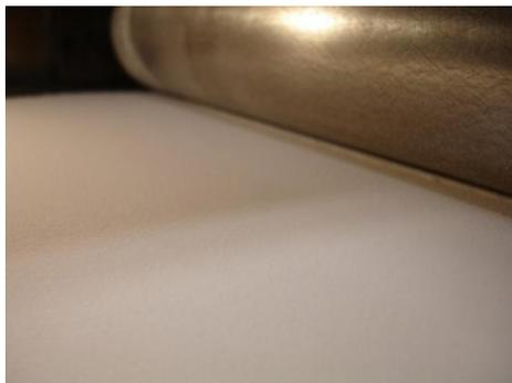
**Figure 31 : Photographie d'une couche de PEEK\_A déposée à l'ambiante (photographie Poly-Shape)**
