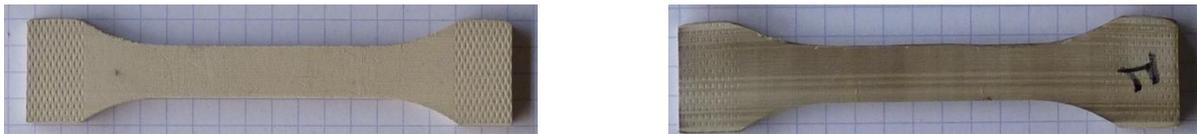
**Figure 51 : Photographie des éprouvettes *PEEK\_A\_20MPa* à gauche et *PEEK\_A\_40MPa* à droite (la longueur des deux éprouvettes est de 85 mm), fabriquée en XZ (orientées sur la tranche)**
