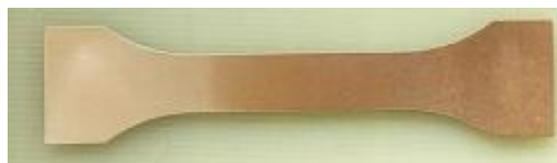
Figure 38 : Eprouvette polie d'EOS *PEEK* HP3® sens Z (la hauteur des éprouvettes est de 85 mm)
