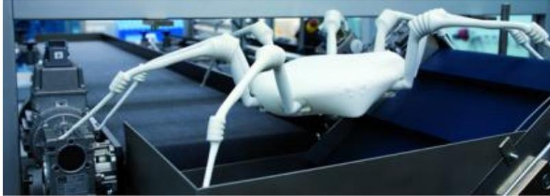
**Figure 45 : Exemples d'applications du procédé de fabrication additive par frittage sélectif par laser dans les domaines de la robotique**
