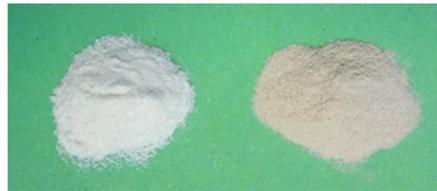
**Figure 47 : Évolution de la couleur de la poudre de *PEKK\_B* (à gauche poudre neuve et à droite poudre utilisée une fois)**
