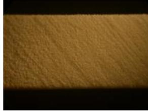
Figure 4 : Photographie d'une éprouvette fabriquée à 45°
