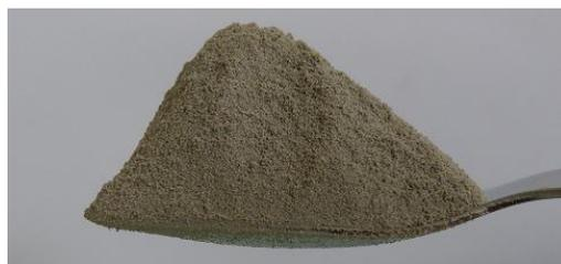
**Figure 10 : Photographie de la poudre de PEEK C dans une spatule**
