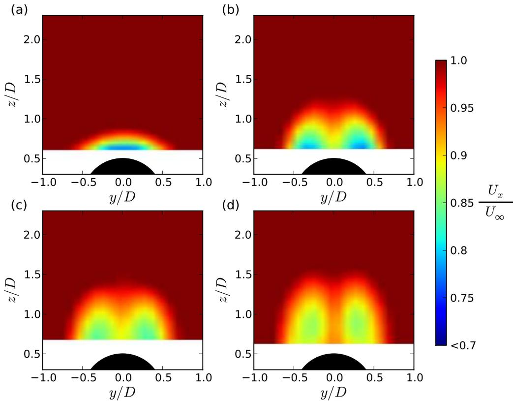
**Fig. 2.14** – Champs PIV de la vitesse dans la direction  $x$  à l'arrière du cylindre pour quatre inclinaisons : (a)  $\alpha = 0.0^\circ$ , (b)  $\alpha = 3.6^\circ$ , (c)  $\alpha = 6.3^\circ$  et (d)  $\alpha = 8.3^\circ$ .
