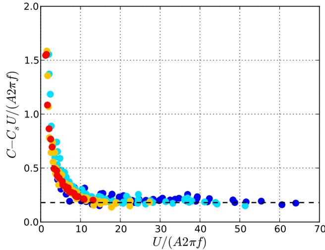
**Fig. 6.16** – Coefficient d’amortissement fluide  $C_0$  en fonction du ratio entre la vitesse d’oscillation latérale  $A2\pi f$  et la vitesse de l’écoulement axial  $U$ . (---) Droite  $C = C_0$  avec  $C_0 = 0.18 \pm 0.04$  (●)  $A = 2.7$  mm, (●)  $A = 5.4$  mm, (●)  $A = 7.5$  mm et (●)  $A = 16.0$  mm.
