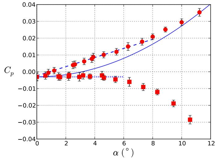
**Fig. 2.12** – Coefficients de pression  $C_p$  à une distance  $x = 0.46$  m de la pointe amont du cylindre. (●) pression à l’avant du cylindre ( $\theta = 0^\circ$ ), (■) pression de base ( $\theta = 180^\circ$ ), (—) Principe d’indépendance  $C_p(\theta = 0^\circ) = \sin^2\alpha$ , (⋯) valeur de la pression pour le cylindre à l’horizontale  $C_p = C_p(\alpha = 0^\circ)$ , (--) régression linéaire  $C_p = 0.16\alpha(\text{rad})$ .
