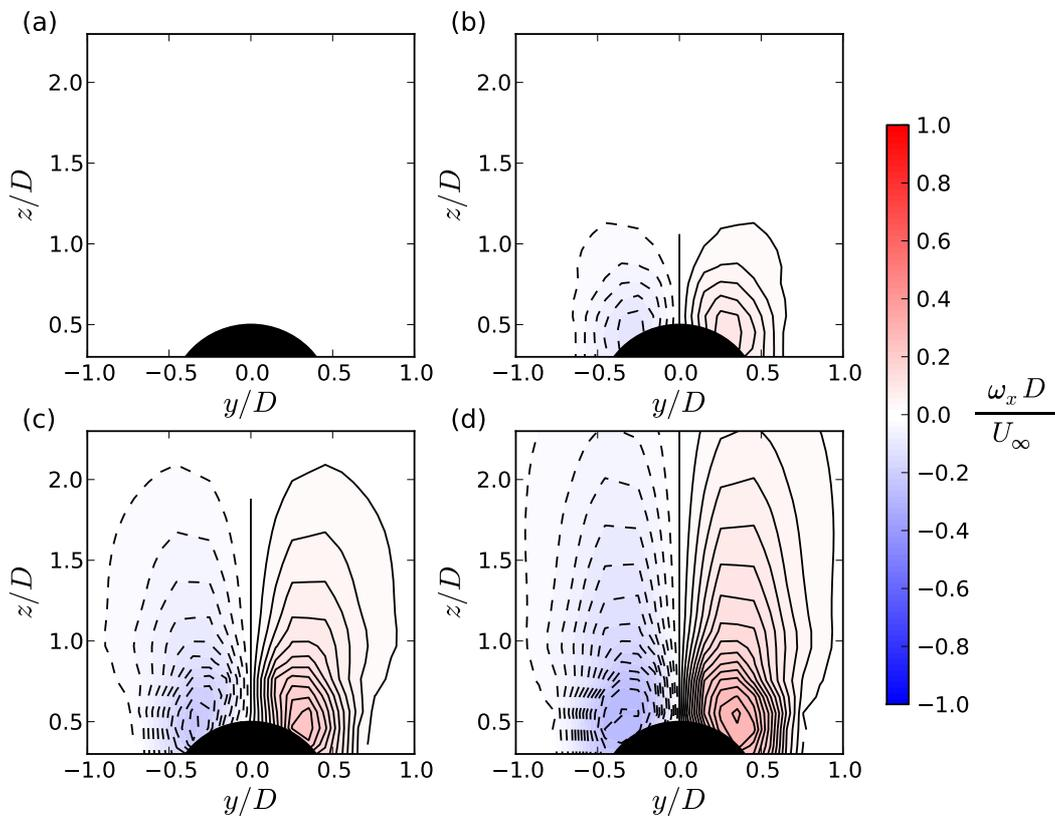
**Fig. 4.8** – Champs PIV de la vorticité dans la direction  $x$  à l'arrière du cylindre pour quatre inclinaisons : (a)  $\alpha = 0.0^\circ$ , (b)  $\alpha = 3.6^\circ$ , (c)  $\alpha = 6.3^\circ$  et (d)  $\alpha = 8.3^\circ$ .
