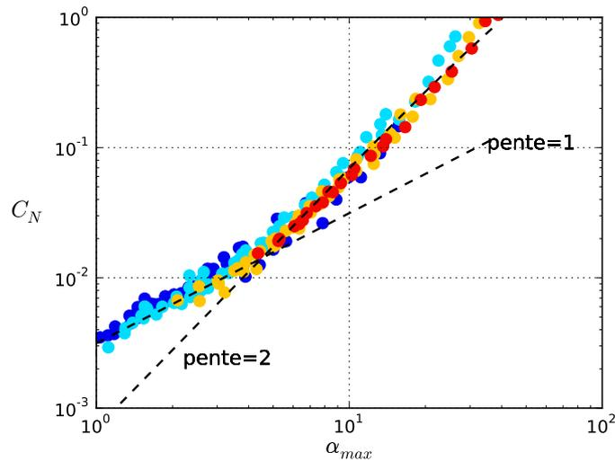
**Fig. 6.18** – Coefficient de force normale  $C_N$  en fonction de l'angle apparent maximal en échelle log. (---) Droites de pente 1 et 2, (●)  $A = 2.7$  mm, (●)  $A = 5.4$  mm, (●)  $A = 7.5$  mm et (●)  $A = 16.0$  mm.
