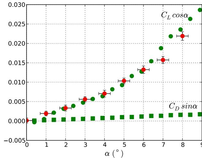
**Fig. 2.5** – Composantes de portance  $C_L \cos \alpha$  et de traînée  $C_D \sin \alpha$  de la force normal  $F_N$  tel que  $C_N = C_L \cos \alpha + C_D \sin \alpha$ . (●) composante de portance mesurée avec la balance bidimensionnelle, (●) composante de portance mesurée avec la balance de précision et (■) composante de traînée mesurée avec la balance bidimensionnelle.
