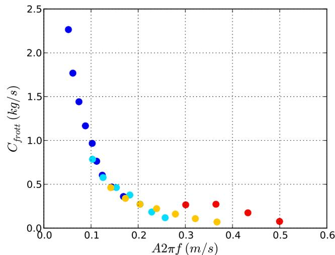
**Fig. 6.8** – Coefficient de frottement  $C_{frott}$  en fonction de l'amplitude de la vitesse d'oscillation  $A2\pi f$ . Mesures effectuées sur le système en air. (●)  $A = 2.7$  mm, (●)  $A = 5.4$  mm, (●)  $A = 7.5$  mm et (●)  $A = 16.0$  mm.
