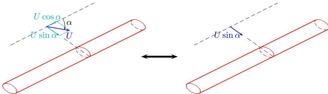
**Fig. 1.4** – Principe d'indépendance : équivalence entre le système constitué par un cylindre incliné d'un angle  $\alpha$  par rapport à l'écoulement de vitesse  $U$  et celui constitué par un cylindre en écoulement transverse de vitesse  $U \sin \alpha$ .
