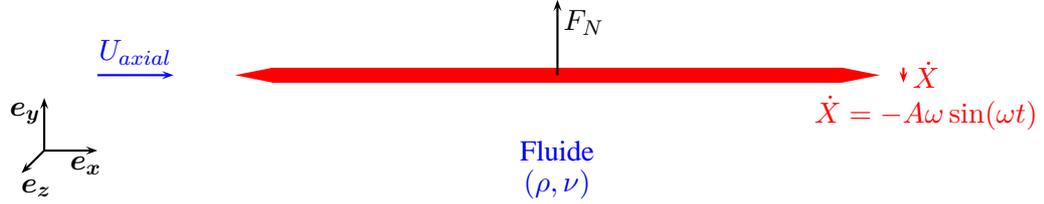
**Fig. 1.1** – Cylindre oscillant en écoulement axial : Schéma du système et notations.
