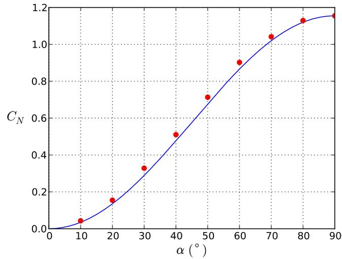
**Fig. 1.3** – (—) Principe d'indépendance  $C_N(\alpha) = C_D^{\alpha=90^\circ} \sin^2 \alpha$  et (•) résultats expérimentaux de Relf & Powell.
