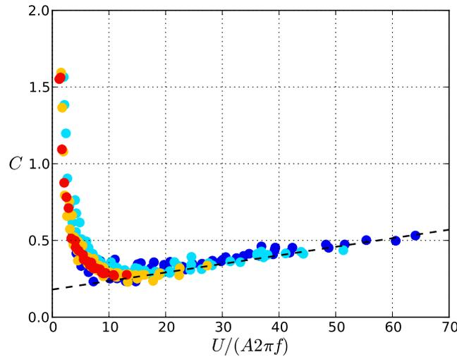
**Fig. 6.15** – Coefficient d’amortissement  $C$  en fonction du ratio entre la vitesse de l’écoulement axial  $U$  et l’amplitude de la vitesse latérale  $A2\pi f$ . (---) Droite  $C = C_s \frac{U}{A2\pi f} + C_0$ , ( $\bullet$ )  $A = 2.7$  mm, ( $\bullet$ )  $A = 5.4$  mm, ( $\bullet$ )  $A = 7.5$  mm et ( $\bullet$ )  $A = 16.0$  mm.
