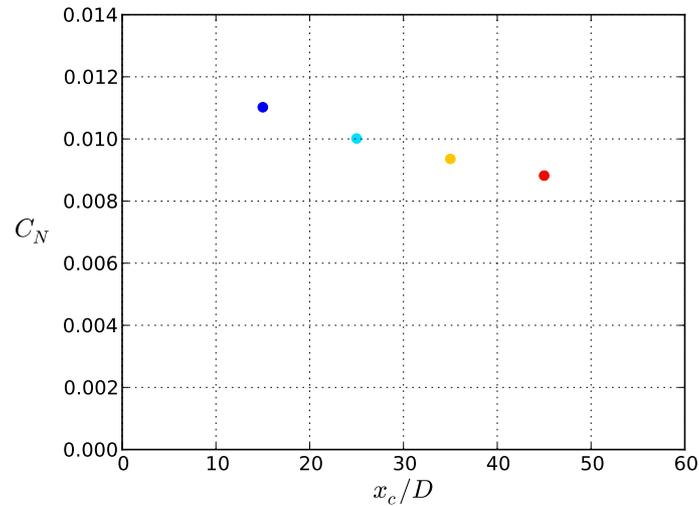
**Fig. 4.15** – Coefficient de force normale locale obtenu par intégration des distributions de pression de la figure 4.14 en fonction de la distance à la pointe amont du cylindre  $x_c/D$  pour une inclinaison du cylindre  $\alpha = 5^\circ$ .
