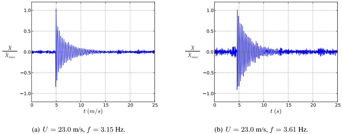
**Fig. 3.10** – Signal d'accélération pour deux fréquences d'oscillation différentes et une vitesse d'écoulement axial  $U = 23.0 \text{ m/s}$ .
