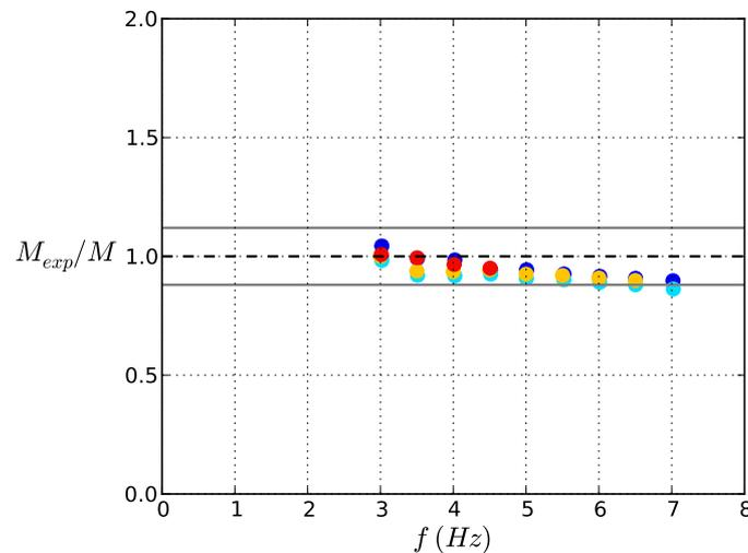
**Fig. 6.9** – Ratio entre la masse totale du système déduite de la force d'inertie  $M_{exp}$  et la masse réelle du système  $M$  en fonction de la fréquence d'oscillation  $f$ . Mesures effectuées sur le système en air. (---) Droite  $M_{exp}/M = 1.0$ , (—) droites  $1.0 \pm 12\%$ , (●)  $A = 2.7$  mm, (●)  $A = 5.4$  mm, (●)  $A = 7.5$  mm et (●)  $A = 16.0$  mm.
