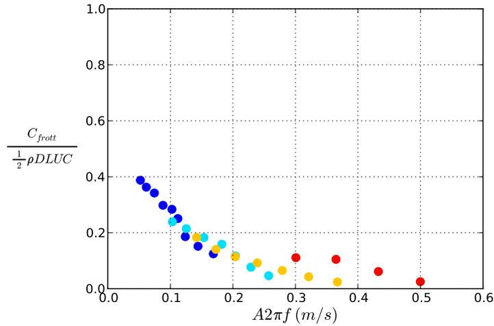
**Fig. 6.14** – Rapport entre le coefficient de frottement  $C_{frott}$  mesuré pour le système en air et la dissipation fluide  $\frac{1}{2}\rho DLUC$  en fonction de l'amplitude de la vitesse d'oscillation  $A2\pi f$  pour une vitesse d'écoulement axial  $U = 3.9$  m/s. (●)  $A = 2.7$  mm, (●)  $A = 5.4$  mm, (●)  $A = 7.5$  mm et (●)  $A = 16.0$  mm.
