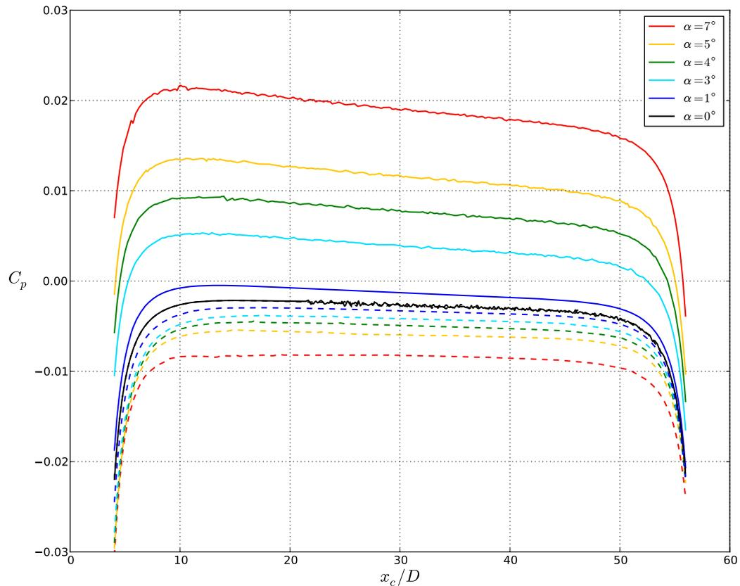
**Fig. 4.12** – Coefficient de pression  $C_p$  en fonction de la distance à la pointe amont du cylindre  $x_c/D$ . Traits pleins : avant du cylindre ( $\theta = 0^\circ$ ) et traits pointillés : arrière du cylindre ( $\theta = 180^\circ$ ).
