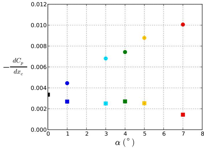
**Fig. 4.13** – Déficit de pression par  $m$  le long du cylindre dans la zone où le déficit est linéaire en fonction de l’inclinaison du cylindre. Ronds : avant du cylindre ( $\theta = 0^\circ$ ) et carrés : arrière du cylindre ( $\theta = 180^\circ$ ).
