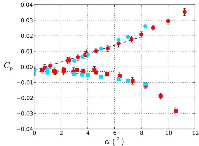
**Fig. 4.6** – Coefficients de pression  $C_p$  à une distance  $x = 0.46$  m de la pointe amont du cylindre. Pression (●) expérimentale et (●) numérique à l'avant du cylindre ( $\theta = 0^\circ$ ), pression de base ( $\theta = 180^\circ$ ) (■) expérimentale et (■) numérique, (⋯) valeur de la pression pour le cylindre à l'horizontale  $C_p = C_p(\alpha = 0^\circ)$ , (--) régression linéaire  $C_p = 0.16\alpha(\text{rad})$ .
