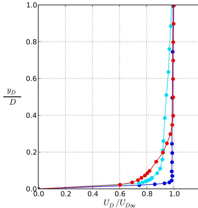
**Fig. 2.13** – Vitesse  $U_D$  mesurée au fil chaud en fonction de la distance  $y_D$  au cylindre à une distance  $x = 0.5$  m de la pointe amont du cylindre. (●) profil réalisé sur le cylindre horizontal ( $\alpha = 0^\circ$ ), (●) profil réalisé sur le cylindre incliné à  $\alpha = 5^\circ$  et sur l'avant du cylindre ( $\theta = 0^\circ$ ), (●) profil réalisé sur le cylindre incliné à  $\alpha = 5^\circ$  et sur l'arrière du cylindre ( $\theta = 180^\circ$ ).
