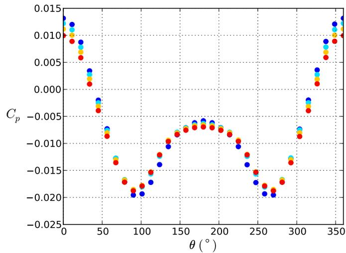
**Fig. 4.14** – Distributions de pression  $C_p(\theta)$  à différentes distances à la pointe amont du cylindre pour une inclinaison du cylindre de  $5^\circ$ . (●)  $x_c/D = 15$ , (●)  $x_c/D = 25$ , (●)  $x_c/D = 35$ , (●)  $x_c/D = 45$
