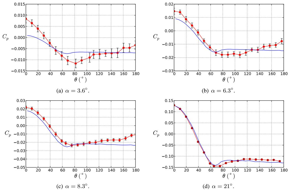
**Fig. 2.11** – Coefficient de pression  $C_p$  en fonction de l'angle azimutal  $\theta$  à une distance  $x/D = 23$  de la pointe amont du cylindre et à  $Re = 24000$  pour quatre inclinaisons  $\alpha$ . (—) Principe d'indépendance :  $C_p(\theta) = C_p^{\alpha=90^\circ}(\theta) \sin^2 \alpha$ , (•) coefficients de pression mesurés avec le dispositif présenté en figure 2.4.
