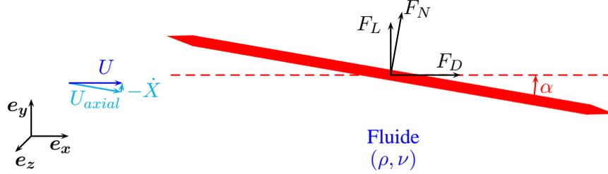
**Fig. 1.2** – Schéma du problème statique et notations.
