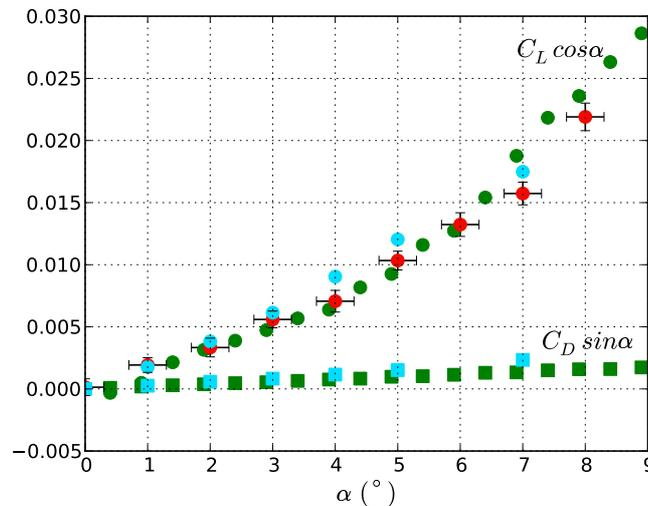
**Fig. 4.2** – Composantes de portance  $C_L \cos \alpha$  et de traînée  $C_D \sin \alpha$  de la force normale  $F_N$  telle que  $C_N = C_L \cos \alpha + C_D \sin \alpha$ . (●) composante de portance mesurée avec la balance bidimensionnelle, (●) composante de portance mesurée avec la balance de précision, (●) composante de portance obtenue par les calculs CFD, (■) composante de traînée mesurée avec la balance bidimensionnelle, (■) composante de traînée obtenue par les calculs CFD.
