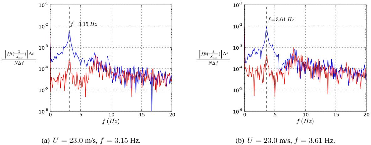
**Fig. 3.11** – (—) FFT du signal d'accélération sur 6 s pour deux fréquences d'oscillation différentes et une vitesse d'écoulement axial  $U = 23.0 \text{ m/s}$ , en eau stagnante et pour différentes vitesses d'écoulement axial, et (—) FFT sur le signal sur 6 s en écoulement sans lâcher pour évaluer le bruit et l'excitation par la turbulence.
