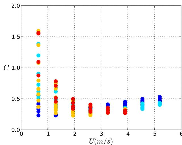
**Fig. 6.13** – Coefficient d'amortissement en fonction de la vitesse de l'écoulement axial. (●)  $A = 2.7$  mm, (●)  $A = 5.4$  mm, (●)  $A = 7.5$  mm et (●)  $A = 16.0$  mm.
