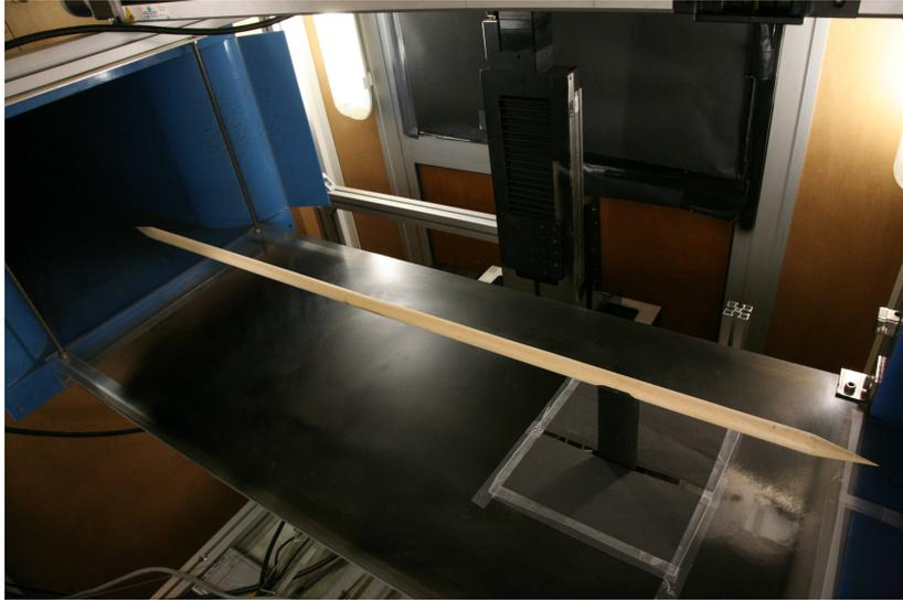
**Fig. 2.2** – Photo du cylindre dans la soufflerie pour le montage utilisé pour la mesure simultanée des forces de traînée et de portance à l’aide d’une balance bidimensionnelle pour lequel le cylindre est maintenu par un profil NACA.
