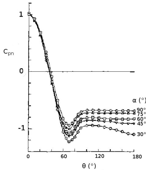
**Fig. 1.6** – Coefficients de pression  $C_{pn} = (p - p_0)/(\frac{1}{2}\rho U_N^2)$  normalisés par la vitesse normale  $U_N = U \sin \alpha$  mesurés par Smith *et al.* [68] pour différentes inclinaisons  $\alpha$  entre  $30^\circ$  et  $90^\circ$  à  $Re_N = \frac{DU_N}{\nu} = 6950$ .
