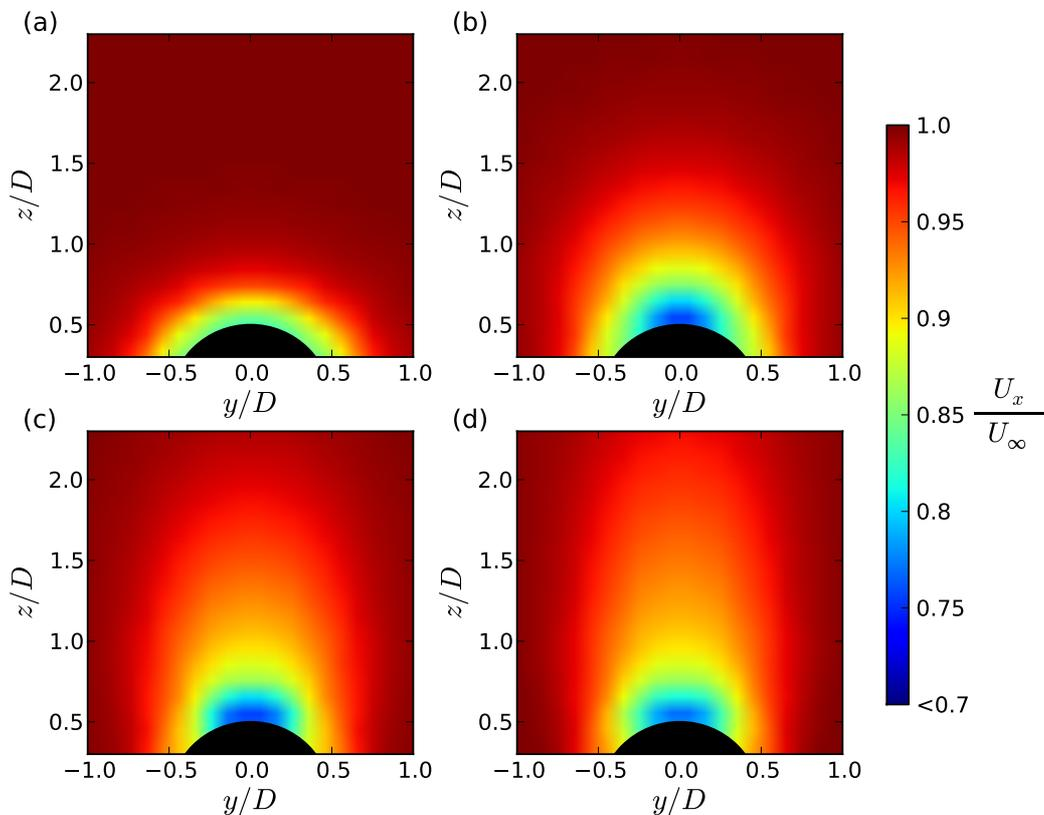
**Fig. 4.7** – Champs PIV de la vitesse dans la direction  $x$  à l'arrière du cylindre pour quatre inclinaisons : (a)  $\alpha = 0.0^\circ$ , (b)  $\alpha = 3.6^\circ$ , (c)  $\alpha = 6.3^\circ$  et (d)  $\alpha = 8.3^\circ$ .
