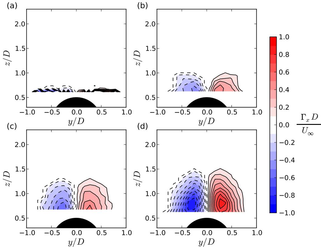
**Fig. 2.15** – Champs PIV de la vorticit  dans la direction  $x$    l'arri re du cylindre pour quatre inclinaisons : (a)  $\alpha = 0.0^\circ$ , (b)  $\alpha = 3.6^\circ$ , (c)  $\alpha = 6.3^\circ$  et (d)  $\alpha = 8.3^\circ$ .
