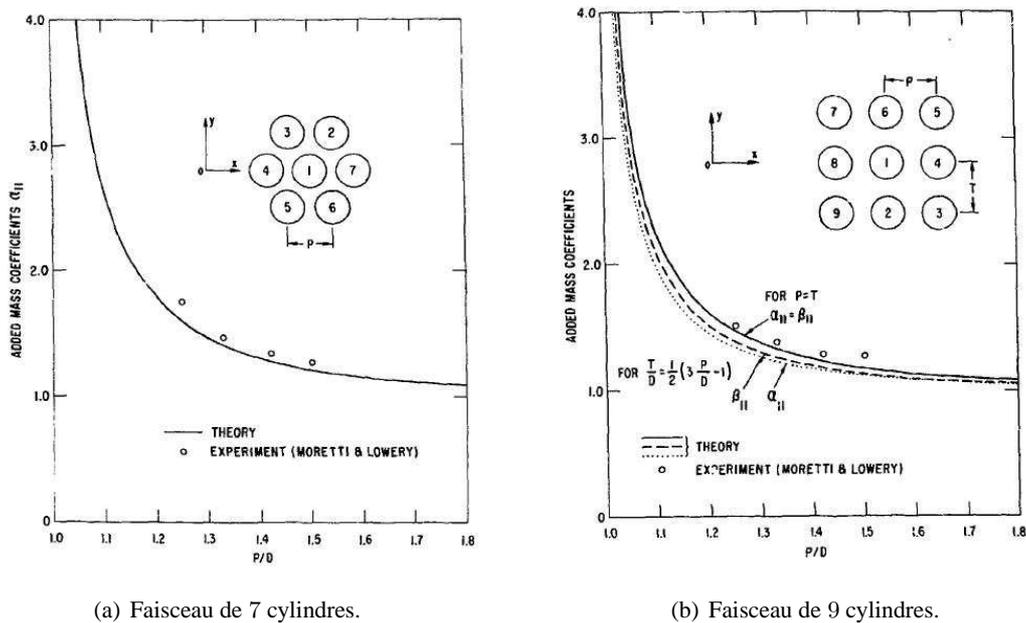
**Fig. 5.1** – Valeurs expérimentales et numériques du coefficient de masse ajoutée pour le cylindre central en fonction du rapport entre l'espacement  $P$  des centres des cylindres et le diamètre des cylindres  $D$  d'après Chen [12].
