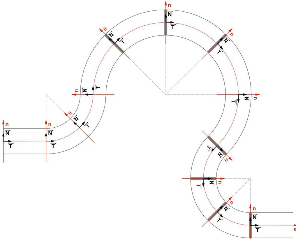
FIG. 2.2 – Chenal vu en plan et paramétrage curviligne.  $\vec{T}$  vecteur tangent,  $\vec{N}$  vecteur normal. L'axe de l'abscisse curviligne  $s$  (ligne médiane) coupe les axes des positions transversales  $n$  à  $n = 0$ .
