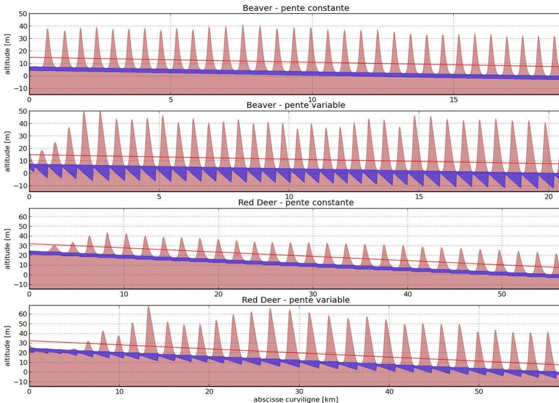
FIG 4.17 – Profondeur du chenal et érosion des flancs de vallée le long d'un profil longitudinal de la Beaver et de la Red Deer (simulations à 90 000 itérations). **En bleu**, la profondeur du chenal, **en orangé**, sous le chenal, le substratum, au dessus du chenal, les hauteurs de flanc de vallée érodé ; les lignes rouges représentent le fond de vallée, qui correspond à la résolution altimétrique des cartes topographiques utilisées.
