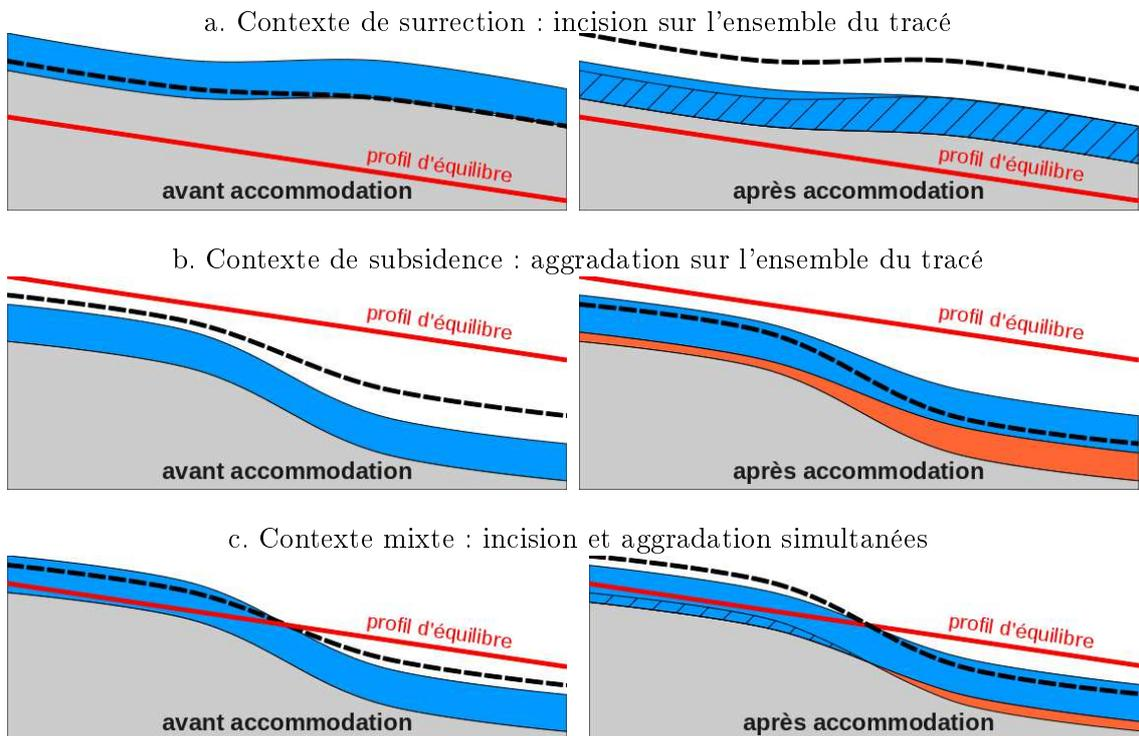
FIG 1.5 — Accommodation du profil longitudinal du chenal vers le profil d'équilibre par érosion (a), par aggradation (b) ou par érosion et aggradation (c) (la valeur de  $\alpha_{acc}$  utilisée est 1/3). Les courbes en tirets interrompus sur les vignettes *avant* (respectivement *après*) représentent la surface de l'eau sur la vignette *après* (respectivement *avant*). Les zones hachurées représentent des érosions, les zones brunes des dépôts de fond de chenaux.
