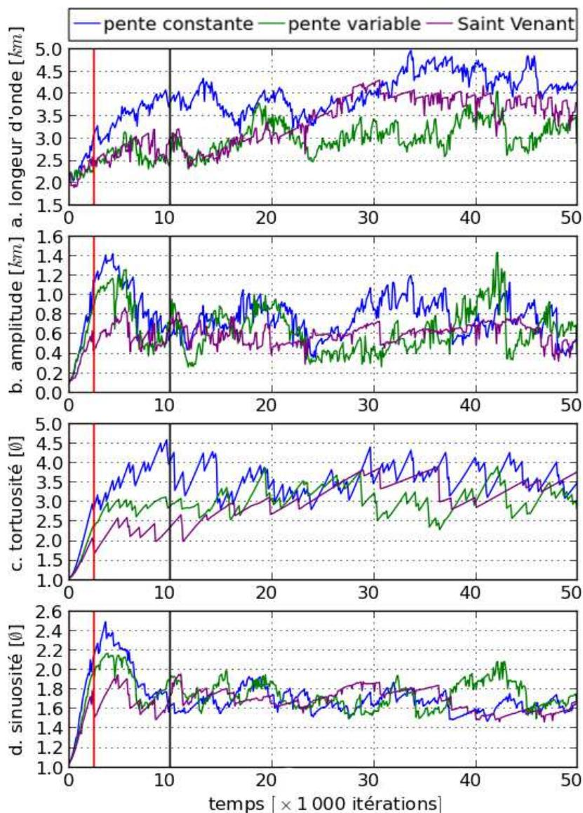
FIG 5.10 – Évolution des paramètres décrivant un tracé méandrique : (a1) la longueur d'onde, (a2) l'amplitude, (b) la sinuosité et (c) la tortuosité (en bleu le modèle à pente constante et en vert celui à pente variable). Le trait rouge (itération 2 500) correspond à la dernière itération présentée sur la figure 5.7. Le trait noir (itération 10 000) correspond à la fin du graphique statistique précédent (figure 5.8).
