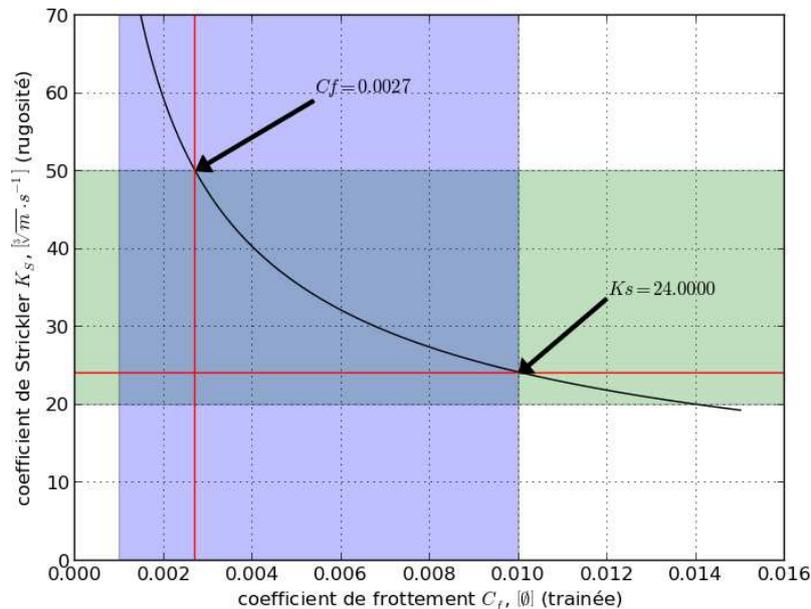
FIG 5.3 – Coefficient de Strickler en fonction du coefficient de friction (courbe en noir), pour un cours d'eau ayant une pente moyenne de 0,001 ; un débit de  $1000 \text{ m}^3 \cdot \text{s}^{-1}$  et une largeur de  $50 \text{ m}$ . Les zones bleues et vertes représentent les zones de validité respectives de  $C_f$  et  $K_S$  en rivières naturelles.
