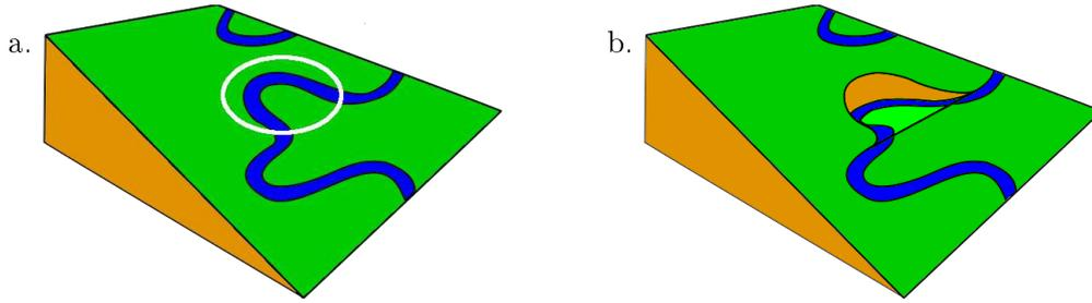
FIG 3.3 – Traduction géométrique du bridage de la pente destiné à éviter les remontées de la surface libre induisant un arrêt de l'écoulement. Tracés d'un chenal : (a) avant bridage, le cercle blanc isolant la portion à corriger, (b) après bridage (l'échelle verticale est exagérée). On peut voir que la boucle dont la surface libre remontait le plan incliné circule désormais horizontalement en s'enfonçant dans la plaine. Lorsque la surface libre rejoint le plan incliné, la correction cesse.
