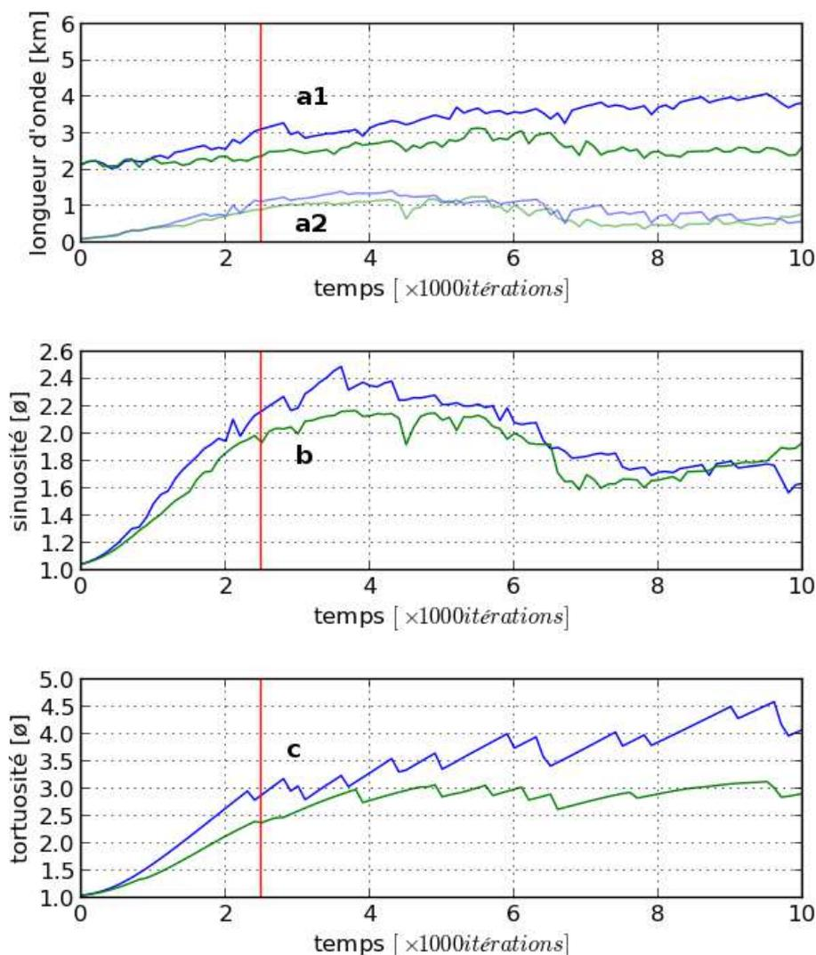
FIG 3.7 – Évolution à court terme des paramètres décrivant le tracé méandrique : **(a1)** la longueur d'onde, **(a2)** l'amplitude, **(b)** la sinuosité et **(c)** la tortuosité (**en bleu** le modèle à pente constante et **en vert** celui à pente variable). Le **trait rouge** (itération 2 500) correspond à la dernière itération présentée sur la figure 3.6.
