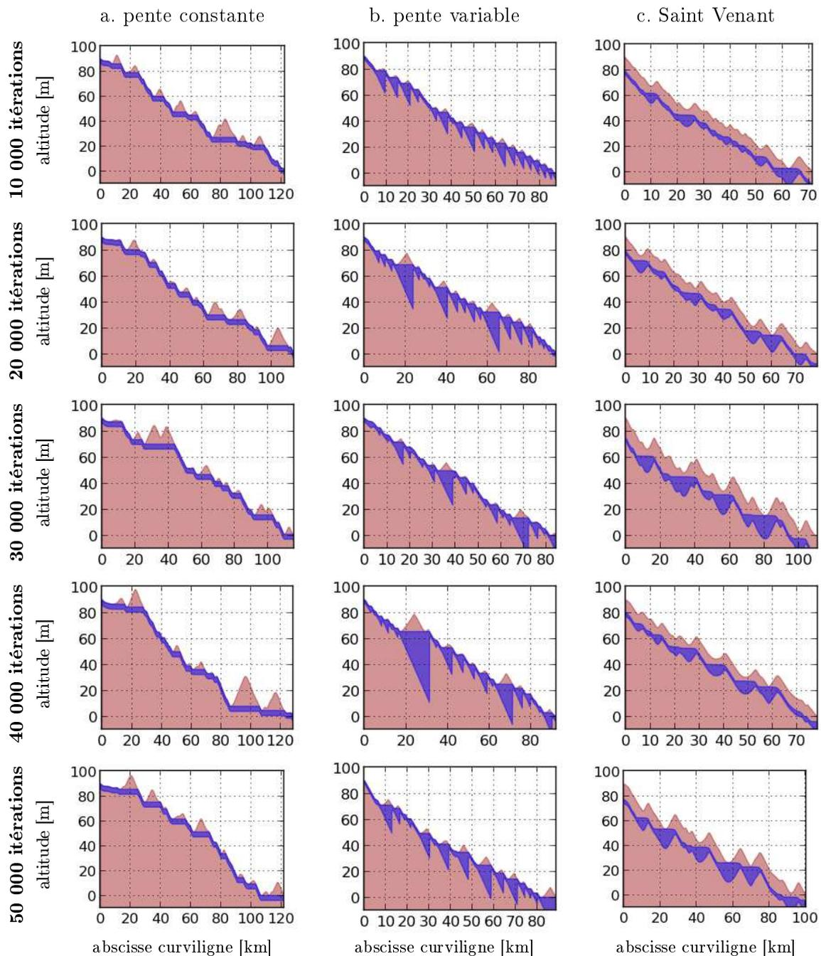
FIG 5.11 – Comparaison des profils des simulations à pentes constante, à pente variable et Saint Venant, toutes les 10 000 itérations. **En bleu**, la profondeur du chenal, **en orangé**, sous le chenal, le substratum, au dessus du chenal, les berges érodées.
