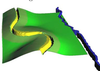
FIG 1.7 — Rupture de levée et avulsions dans Flumy. Évolution de la rupture d'une levée à l'intérieur du domaine, (a), (b) et (c), et exemple d'avulsion en amont du domaine d'étude (d). la dimension verticale est exagérée.
