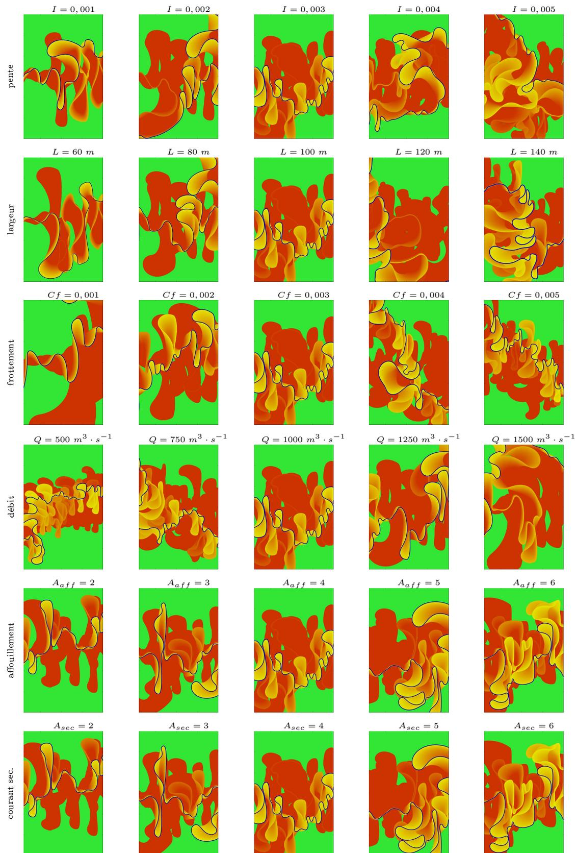
FIG. B.1 – Modèles à pente constante. **Axe vertical**, le paramètre dont on étudie la variation, **Axe horizontal**, valeurs croissantes de ce paramètre. Les plaines ( $20 \times 30\text{ km}$ ) sont représentées à l'itération 50 000. Les écoulements se font d'ouest en est. Les dépôts de migration deviennent progressivement rouge après 10 000 itérations.
