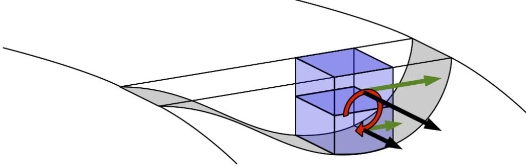
FIG 2.4 – Couple centrifuge dans une colonne d'eau, à l'origine du développement des courants secondaires. **En noir**, les vitesses dans les moitiés supérieure et inférieure, **en vert**, les pseudo-forces centrifuges associées, **en rouge**, le couple induit sur la colonne d'eau par ces pseudo-forces centrifuges.
