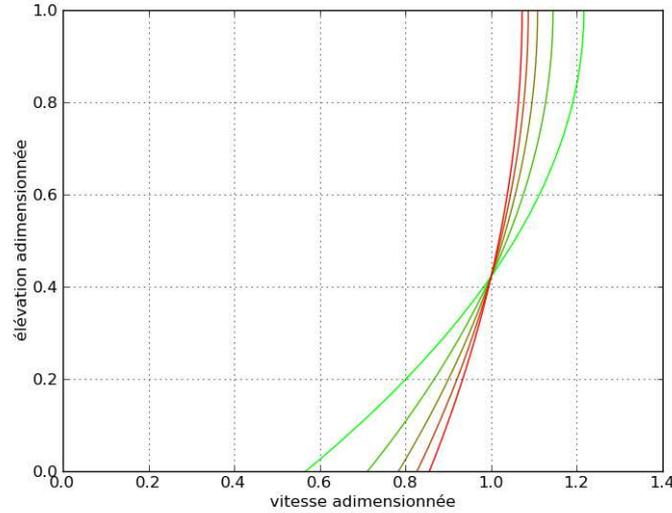
FIG 2.3 – Profils verticaux quadratiques de la vitesse longitudinale en fonction du coefficient de frottement compris entre  $\frac{1}{900}$  (en vert) et  $\frac{1}{100}$  (en rouge) couvrant ainsi la gamme classique en rivière naturelle ([Engelund 74]).
