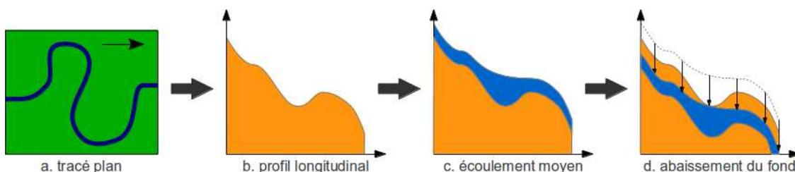
FIG 5.2 – Construction du fond pour le modèle Saint Venant. Considérant le tracé plan (a), un profil est déterminé pour le fond (b). Après calcul de l'écoulement moyen (c), le fond est translaté (d) pour garantir que la surface ne dépasse pas la topographie.
