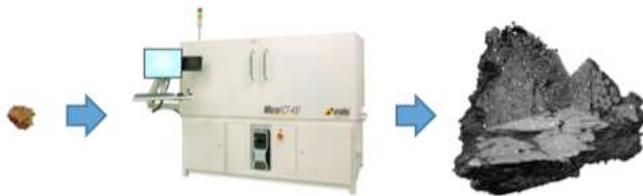
Figure II.3: Analyse en micro-tomographie à rayons X et reconstruction tridimensionnelle d'un agrégat de sol.
