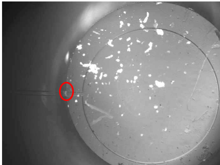
Figure III-II-2. Photographie du réservoir échantillon rempli de particules à l'origine du bouchage créé en sortie de réservoir (encerclé).
