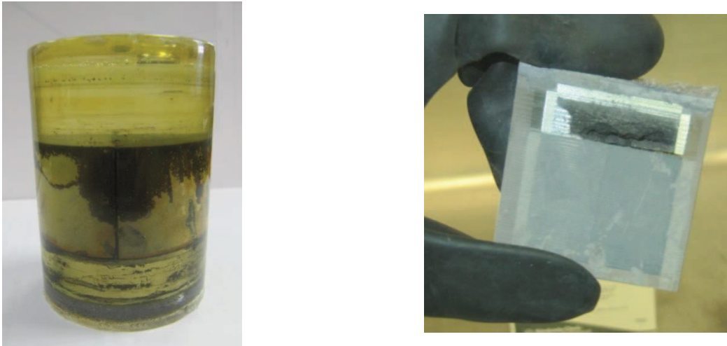
Figure 3.12. Echantillon avant réalisation des découpes grossières réalisées à la scie à fil, à gauche (étape 8) et échantillon non résiné avant découpes fines dans la BAG, à droite (étape 9)
