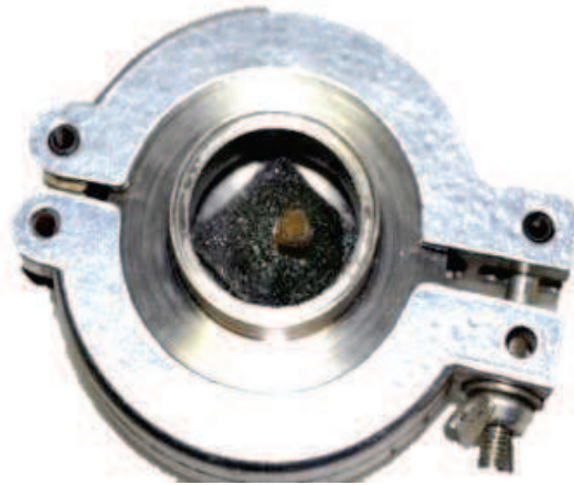
Figure 3.15. Cellule Raman, dispositif permettant d'éviter l'oxydation des phases pendant les analyses Raman
