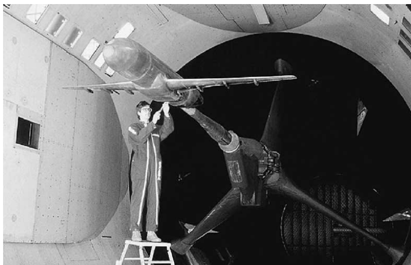
Figure 2 - 14 : Essais dans une soufflerie d'A320 à la soufflerie S1 de l'ONERA/Modane [50]
