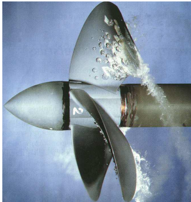
Figure 2 – 6 : Cavitation à bulles suivie d'un nuage de poches [26]
