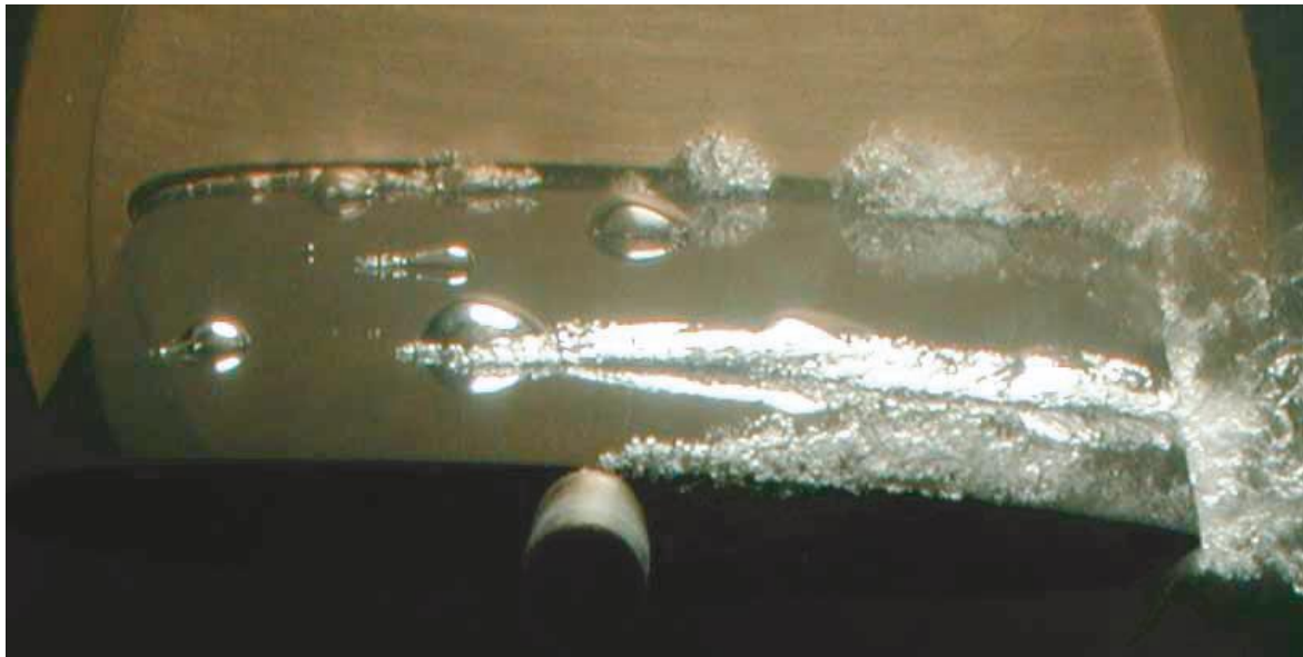
Figure 2 - 2 : Cavitation à bulles convectées [10]
