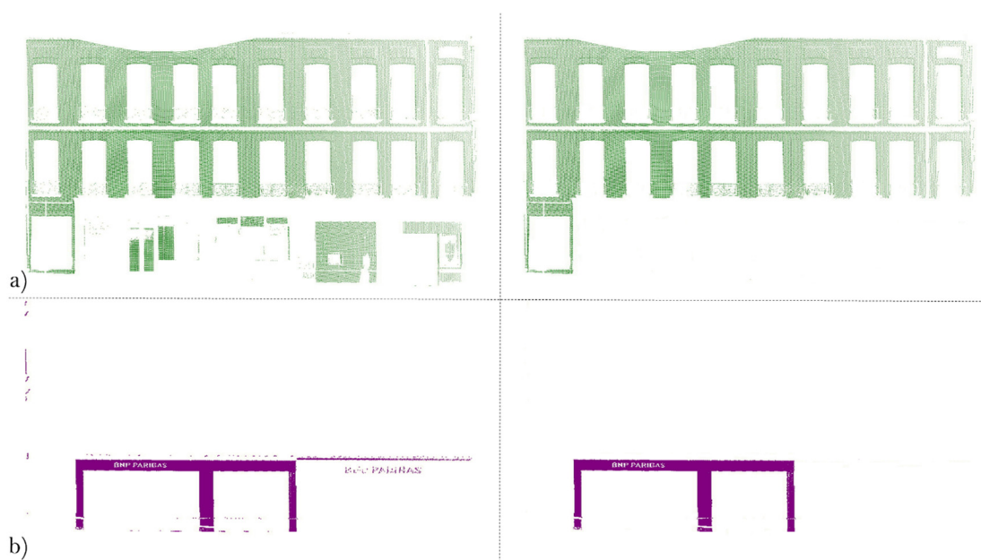
Figure 9.9 Exemple d'erreurs de connectivité : plan détecté (à gauche) ; plan recherché (à droite)
