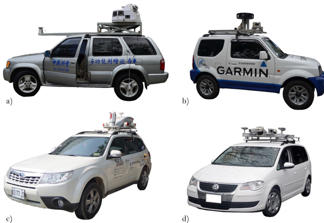
Figure 2.1 Exemple de systèmes commerciaux : a) Lynx Mobile Mapper M1 de Chung Hsing Surveying ; b) Garmin Corporation de Taïwan ; c) Riegl VMX-250 de SGS ; d) MMS série X de Mitsubishi Electric
