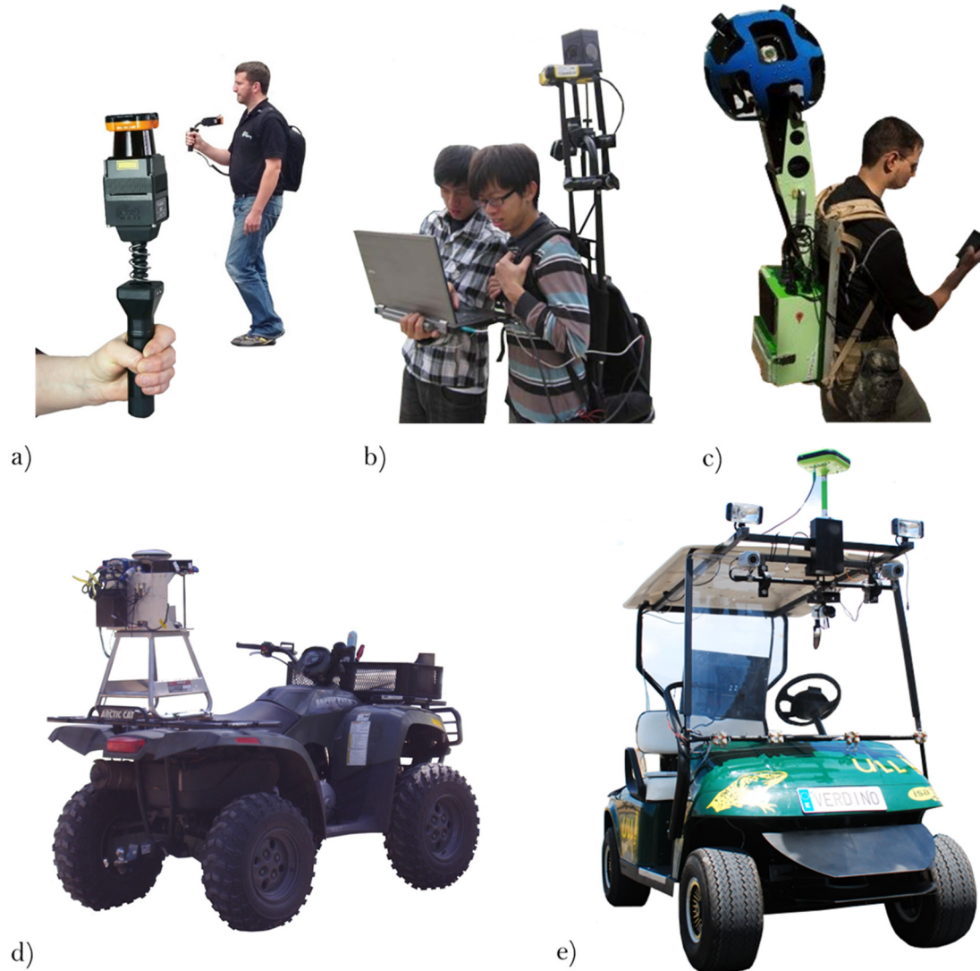
Figure 2.2 Quelques récents et « légers » systèmes mobiles de cartographie : a) ZEB1 de 3DLaserMapping ; b) BackPack Mobile Mapping System [Liao et al., 2013] ; c) Trekkeur de Google Street View ; d) Système mobile de l'Université de Floride ( FLREC Geomatics ) ; e) VERDINO2 de l'Université La Laguna de Ténérife
