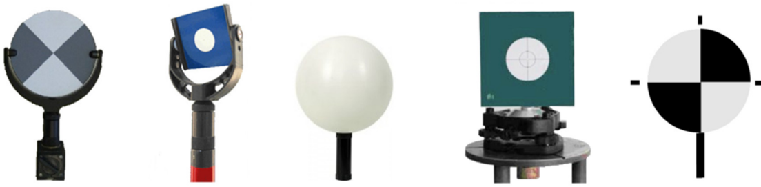
Figure 6.3 Différents types de cibles propres pour les constructeurs du scanner
