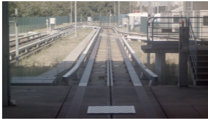
FIGURE 2.11 – Capture d'image avec une mire d'étalonnage devant le train sur le plan de roulement
