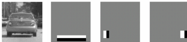
(a) Meilleures caractéristiques de Haar pour la détection des voitures.
