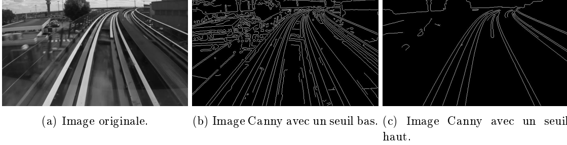
FIGURE 3.4 – Extraction des contours de la voie d'OrlyVal avec le filtre de Canny en fonction du seuillage appliqué.
