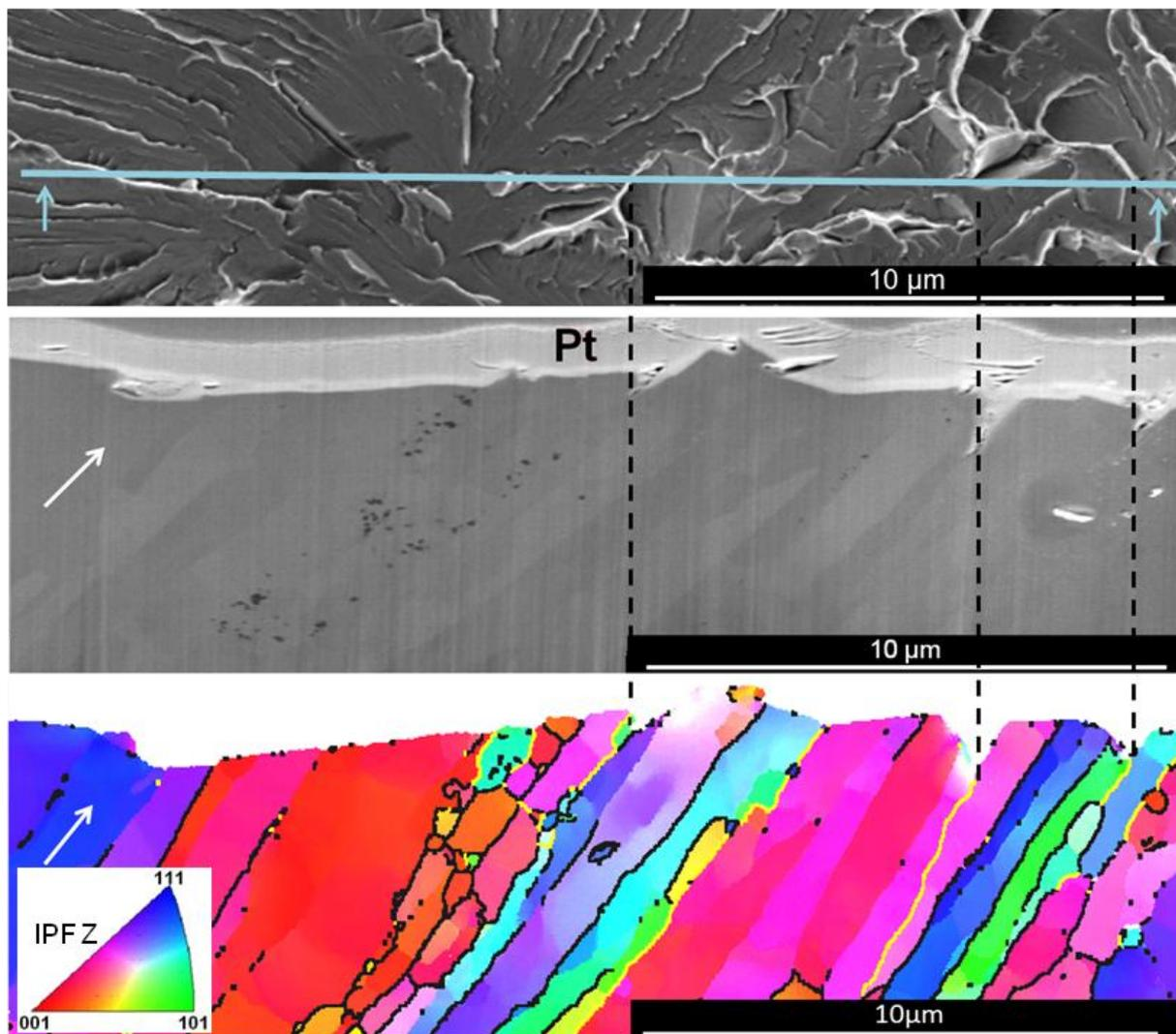
Figure IV-64 : Lamme prélevée au FIB, cartographie EBSD et position de la ligne de découpe sur la facette de clivage de la nuance F43. Sur la cartographie, les joints de grains marqués en noir présentent des désorientations  $> 15^\circ$  et les jaunes des désorientations  $> 50^\circ$ . Les trois traits en pointillés marquent les frontières de la facette de clivage marquées par la présence de ligaments ductiles.
