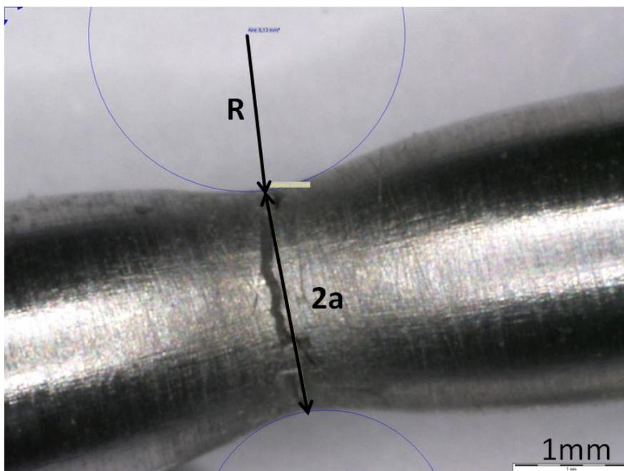
Figure V-2 : Mesure du rayon de striction  $R$  et du diamètre de striction  $2a$  sur une éprouvette de traction en sens axial issue de la nuance J27 et testée à  $-120^{\circ}\text{C}$  à la vitesse de  $10^{-3}$  s $^{-1}$ .
