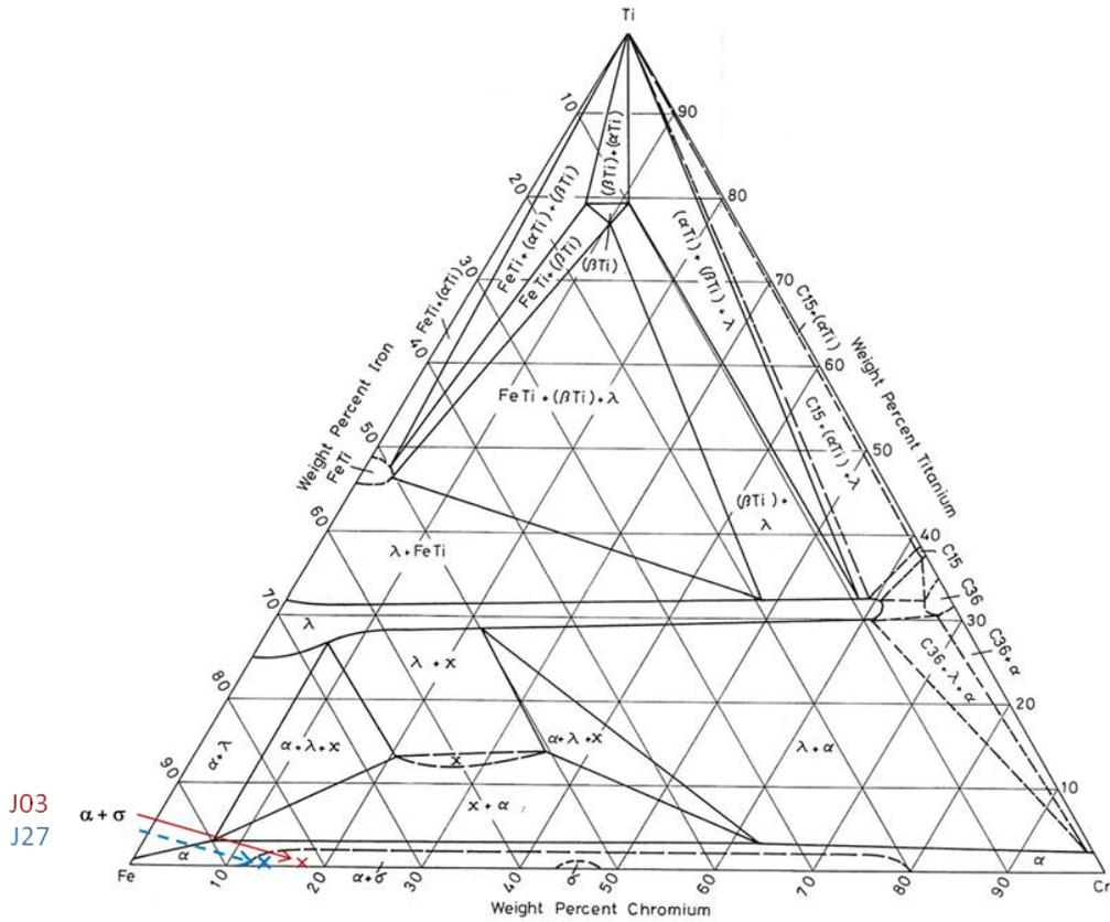
Figure III-3 : Diagramme de phases Fe-Cr-Ti à 550°C. La phase ternaire  $\chi$  est de type Fe<sub>32</sub>Cr<sub>17</sub>Ti<sub>9</sub>, la phase  $\sigma$  de type FeCr, et la phase de Laves  $\lambda$  de type Fe<sub>2</sub>Ti [Raghavan-1987]. Le point marqué par une flèche rouge correspond à la teneur en chrome et en titane de la nuance J03, et le point indiqué par la flèche bleue en pointillés correspond à la teneur en chrome et en titane de la nuance J27.
