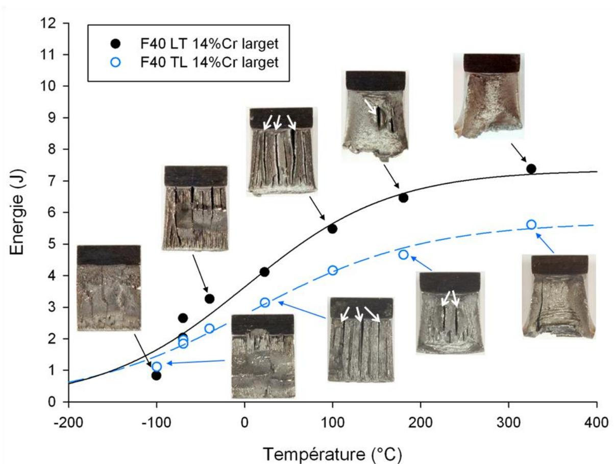
Figure I-13 : Courbes en énergie à rupture et vues macroscopiques des faciès de rupture de la nuance F40 à 14%Cr filée sous forme de larget, sollicitée en sens LT et TL. Les flèches indiquent des fissures de délaminage.
