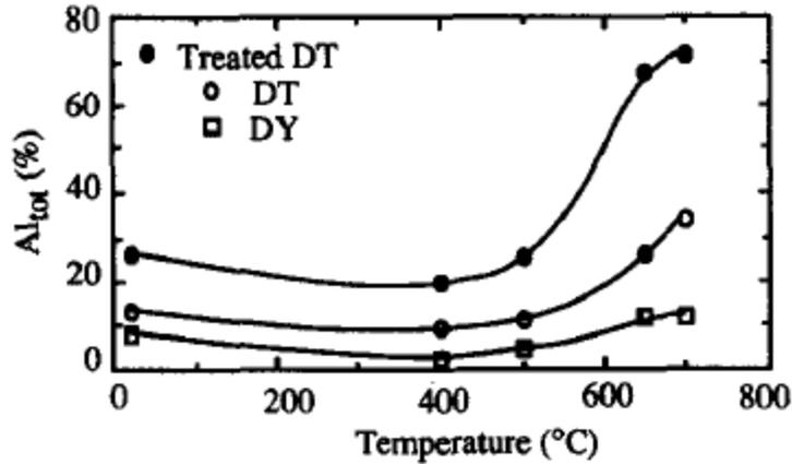
Figure III-23 : Evolution de l'allongement à la rupture des nuances d'acier DT, DT traité et DY ODS en fonction de la température. La nuance DT traitée est la seule à ne pas contenir de phase  $\chi$  [Zakine-1996].
