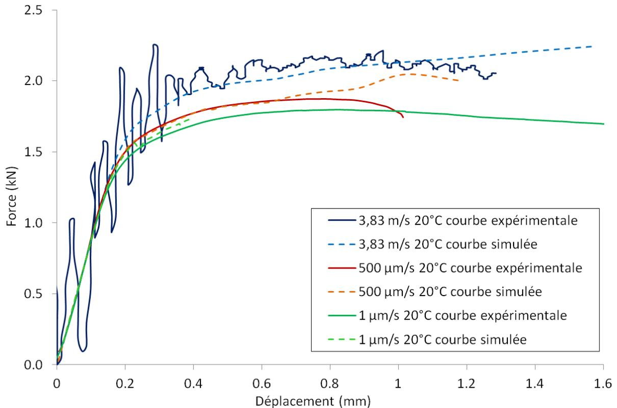
**Figure V-22 : Simulations numériques et réponses expérimentales correspondant aux essais de flexion menés à la température de 20°C et aux vitesses de 1  $\mu\text{m/s}$ , 500  $\mu\text{m/s}$  et 3,83 m/s.**
