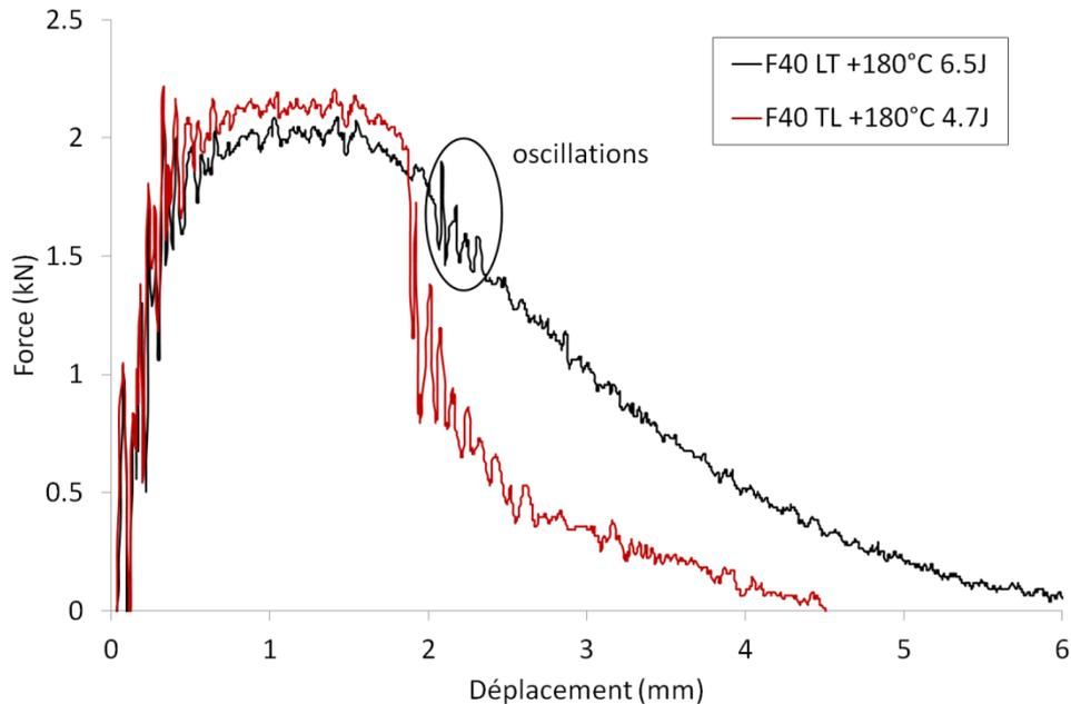
**Figure II-35 : Courbes force-déplacement de la nuance F40 testée en résilience en sollicitation LT et TL à +180°C. Des oscillations sont présentes sur la courbe correspondant au sens LT, probablement à cause de la formation de fissures de délaminage.**
