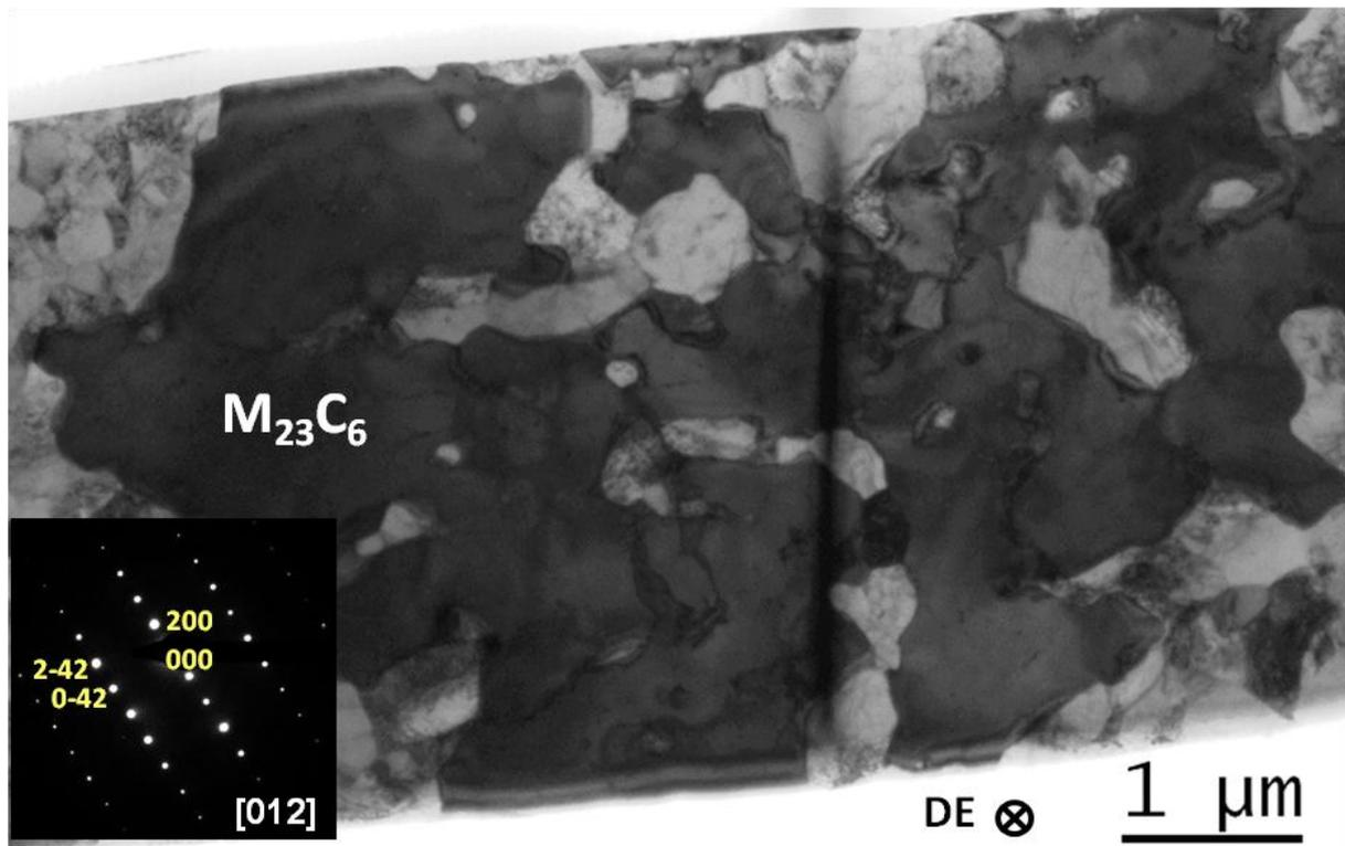
Figure III-50 : Cliché MET et cliché de diffraction d'un carbure de type  $(Cr,Fe,W)_{23}C_6$  observé dans la nuance J03 vieillie à 600°C pendant 5000 heures. Le carbure apparaît en contraste sombre sur le cliché, les contrastes clairs à l'intérieur du carbure correspondent à la matrice. La direction d'extrusion (DE) est représentée.
