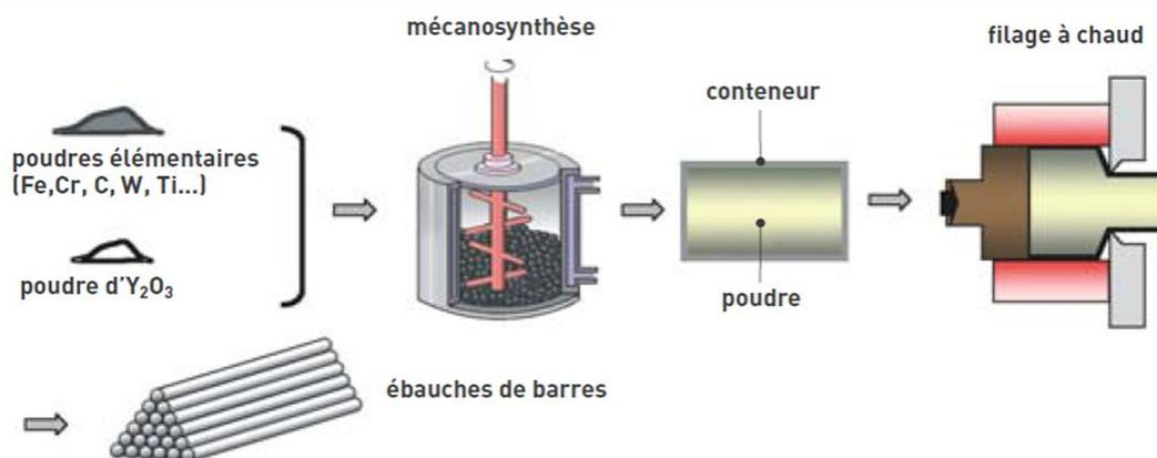
Figure I-11 : Schématisation du procédé de fabrication de barres en acier ODS par filage à chaud [Clefs CEA-2007].
