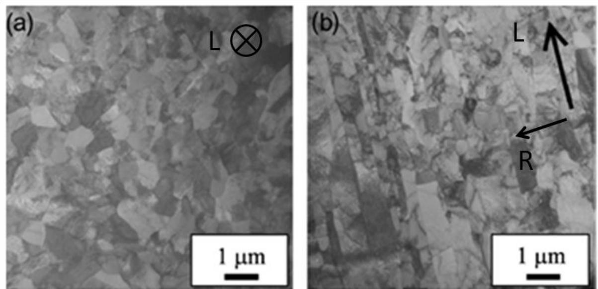
Figure II-6 : Microstructure de l'acier ODS J05 à 14%Cr a) dans le plan radial et b) dans le plan longitudinal [Steckmeyer-2010]. Le symbole L correspond à la direction de filage, et R à la direction radiale.
