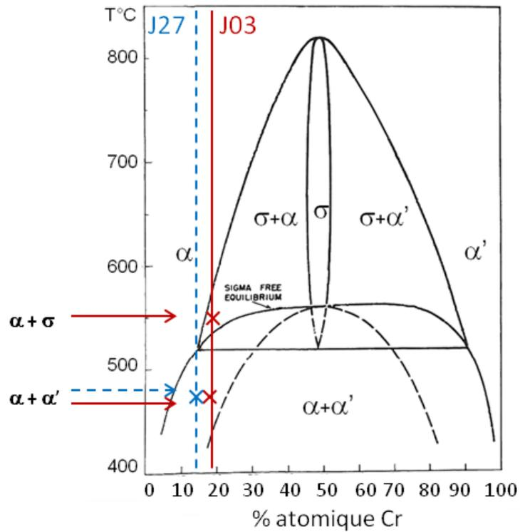
Figure III-1 : Diagramme de phases Fe-Cr, la phase  $\alpha$  correspond au Fe( $\alpha$ ), la phase  $\alpha'$  correspond au Cr( $\alpha$ ), et la phase  $\sigma$  est de type FeCr [Williams-1958]. Le trait rouge correspond à la teneur en chrome de la nuance J03, et le trait bleu en pointillés correspond à la teneur en chrome de la nuance J27.
