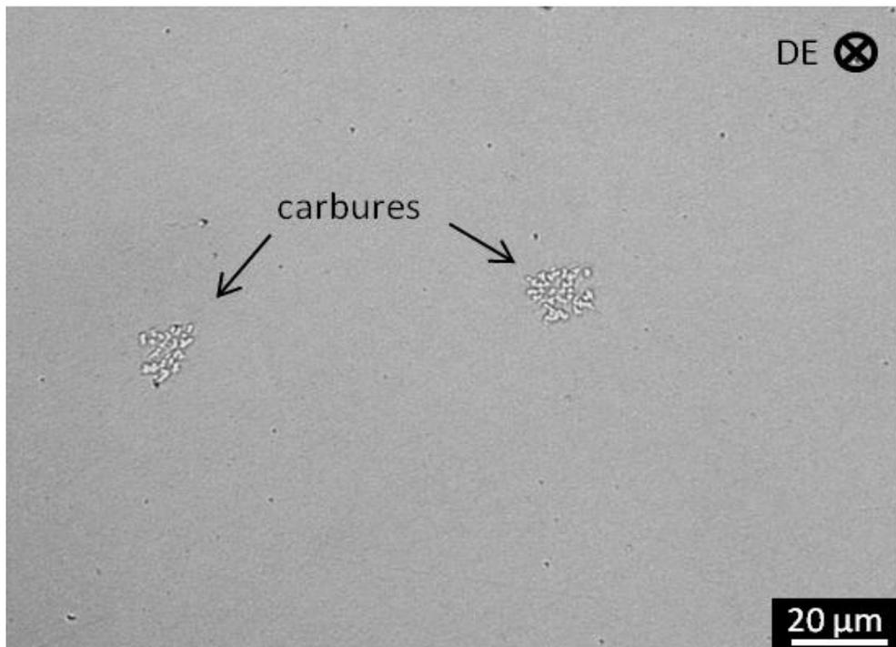
Figure III-41 : Carbures observés au microscope optique dans la nuance J03 à l'état vieilli à 500°C pendant 5000 heures. La direction d'extrusion (DE) est représentée.
