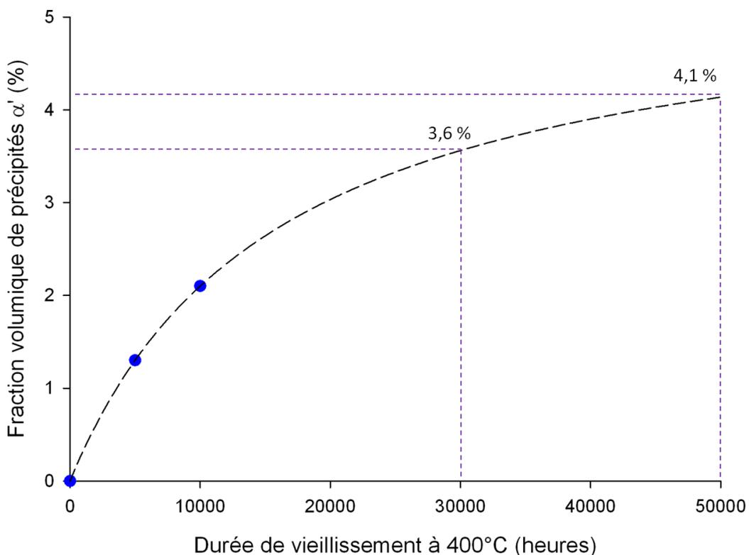
Figure VI-1 : Evolution de la fraction volumique des précipités  $\alpha'$  lors du vieillissement thermique à 400°C entre 5000 heures et 10000 heures, et estimations de ces valeurs pour des durées de 30000 et 50000 heures.
