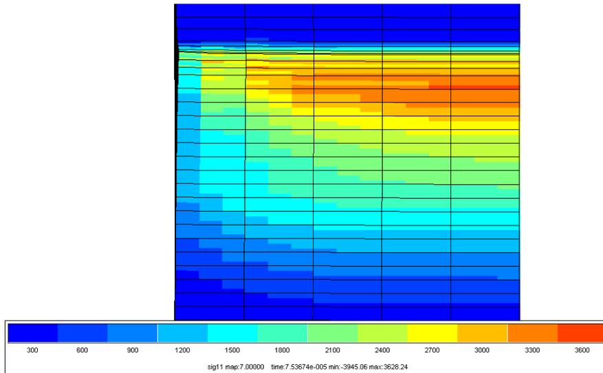
Figure V-33 : Champs de contrainte  $\sigma_{xx}$  à l'instant de la rupture de l'éprouvette mini-Charpy sollicitée à la vitesse de 3,83 m/s à la température de  $-100^{\circ}\text{C}$ .
