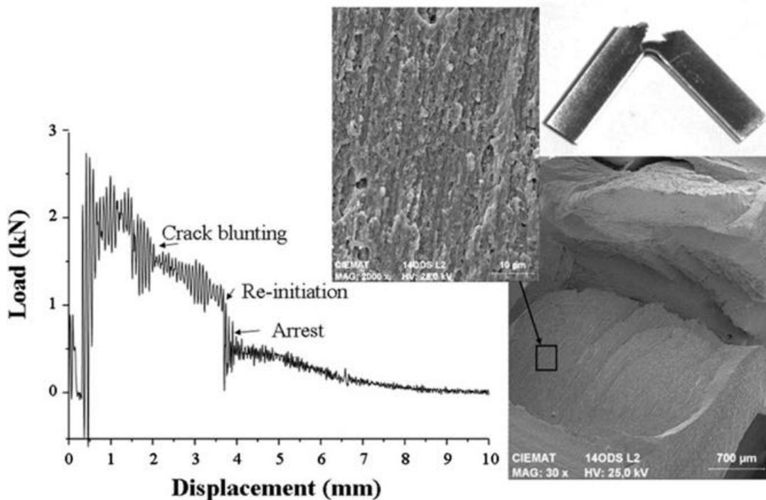
Figure IV-9 : Courbe force-déplacement et faciès de rupture d'une éprouvette issue de la nuance d'acier ODS à 14%Cr J27 testée en résilience à 20°C en sollicitation LT [Garcia-2012].
