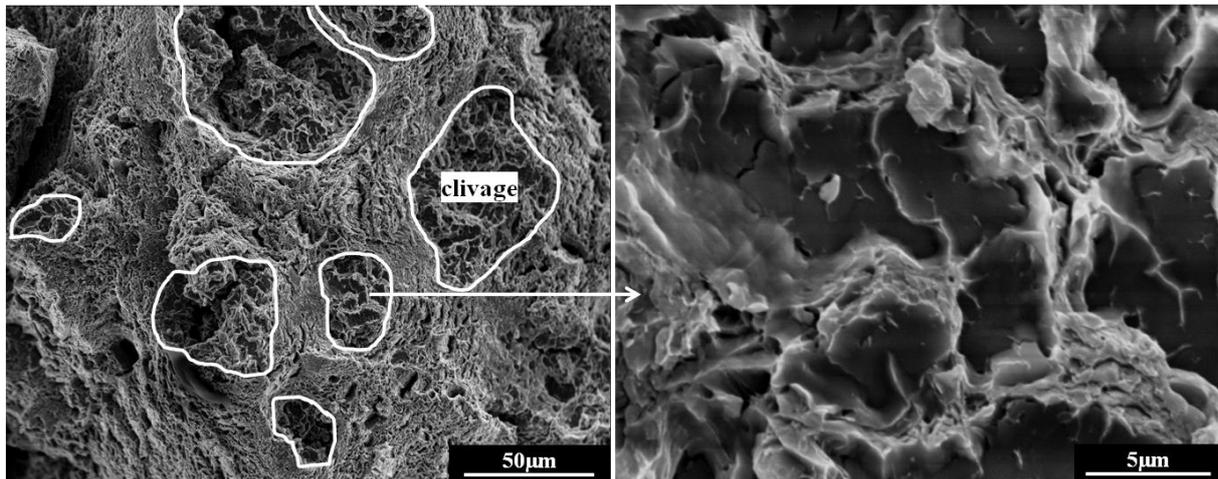
Figure III-29 : Micrographies du faciès de rupture en traction de la nuance J03, à la température d'essai de 20°C, du matériau vieilli à 600°C pendant 5000 heures. Des facettes de clivage sont repérées sur le faciès de rupture.
