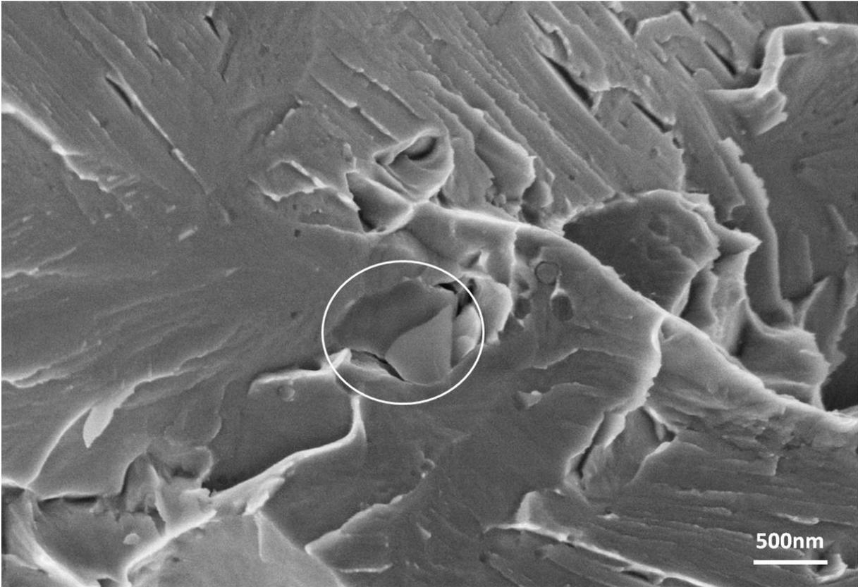
Figure IV-60 : Particule localisée sur le site d'amorçage de la rupture par clivage sur la nuance J27 testée en résilience à -100°C en sollicitation LT.
