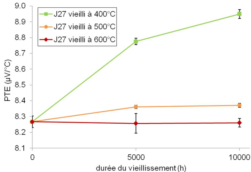
**Figure III-65 : Evolution du pouvoir thermoélectrique (PTE) de la nuance J27 en fonction de la température et de la durée du vieillissement thermique. Les barres d'erreurs correspondent aux valeurs des écart-type.**
