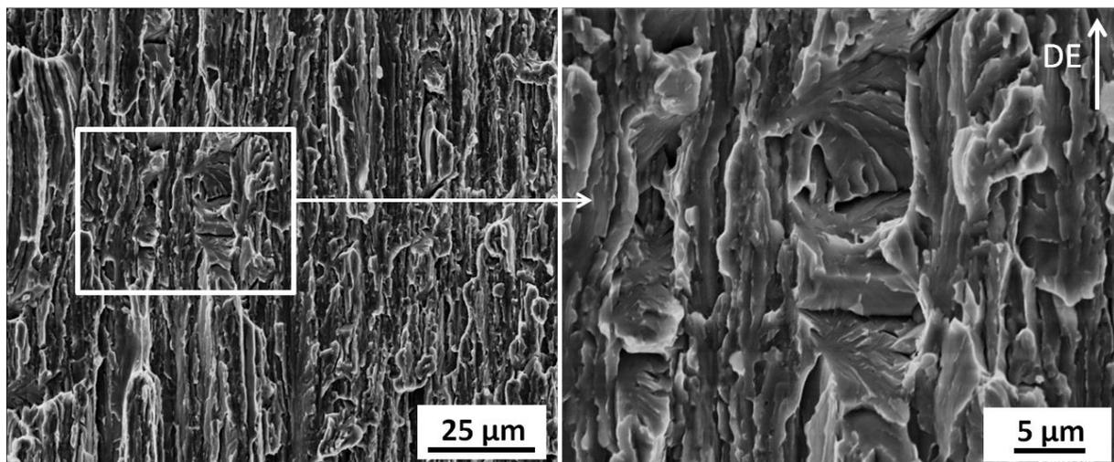
Figure IV-28 : Observations au MEB d'une zone rompue par bifurcation sur la nuance F43 testée à  $-130^\circ\text{C}$ . La direction d'extrusion (DE) est représentée.
