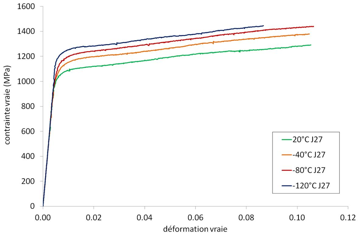
Figure V-1 : Contrainte vraie en fonction de la déformation vraie de la nuance J27 sollicitée en sens axial à la vitesse de  $10^{-3}$  s $^{-1}$ .
