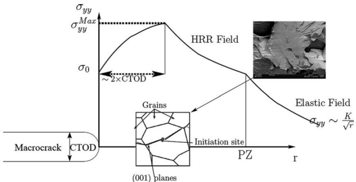
Figure IV-44 : Schéma représentant l'évolution de la contrainte d'ouverture  $\sigma_{yy}$  en avant d'une fissure émoussée, la plasticité étant confinée en pointe de la fissure. Le site d'amorçage est situé à une distance égale à  $2 \times CTOD$  à partir de la pointe de la fissure, ce qui correspond à la zone où la contrainte est maximale.
