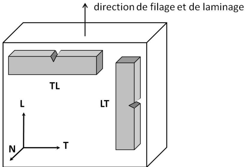
Figure I-12 : Schéma de prélèvement des éprouvettes de résilience en sens LT et TL dans le larget référencé F40.
