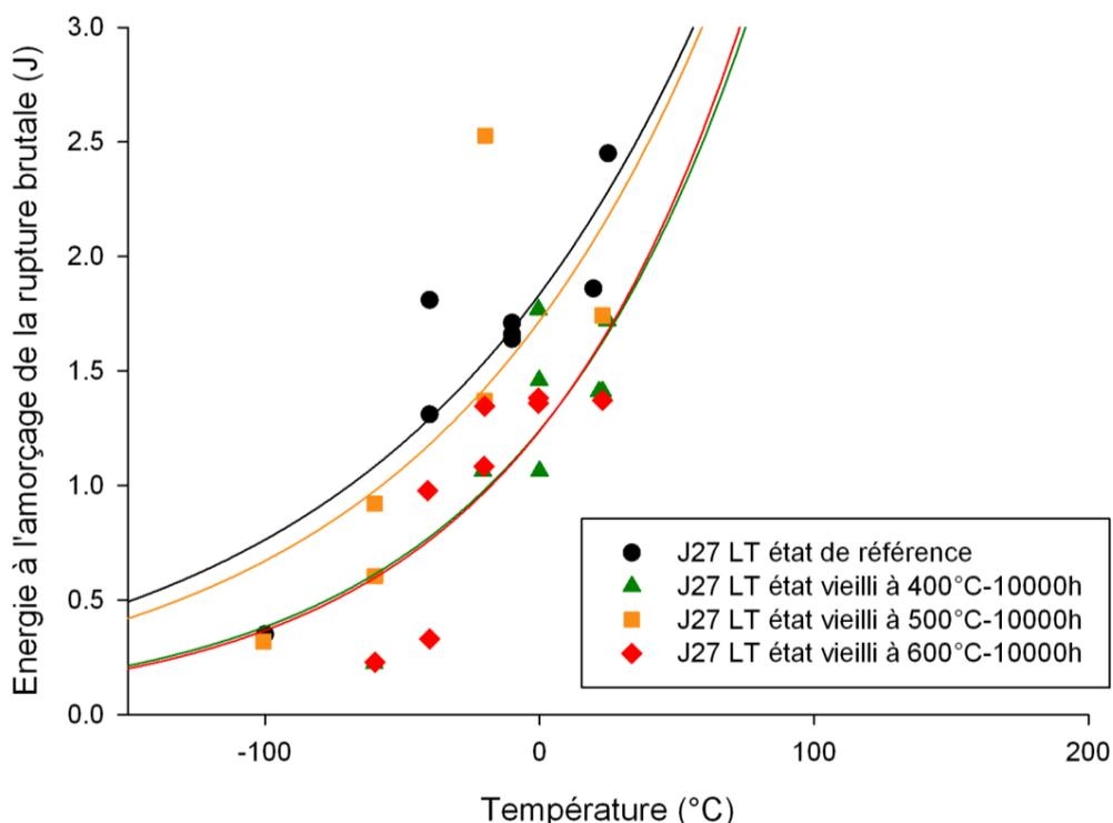
**Figure III-57 : Evolution de l'énergie à l'amorçage de la rupture brutale de la nuance J27 à l'état de référence et aux états vieillis à 400°C, 500°C et 600°C pendant 10000 heures en sollicitation LT.**
