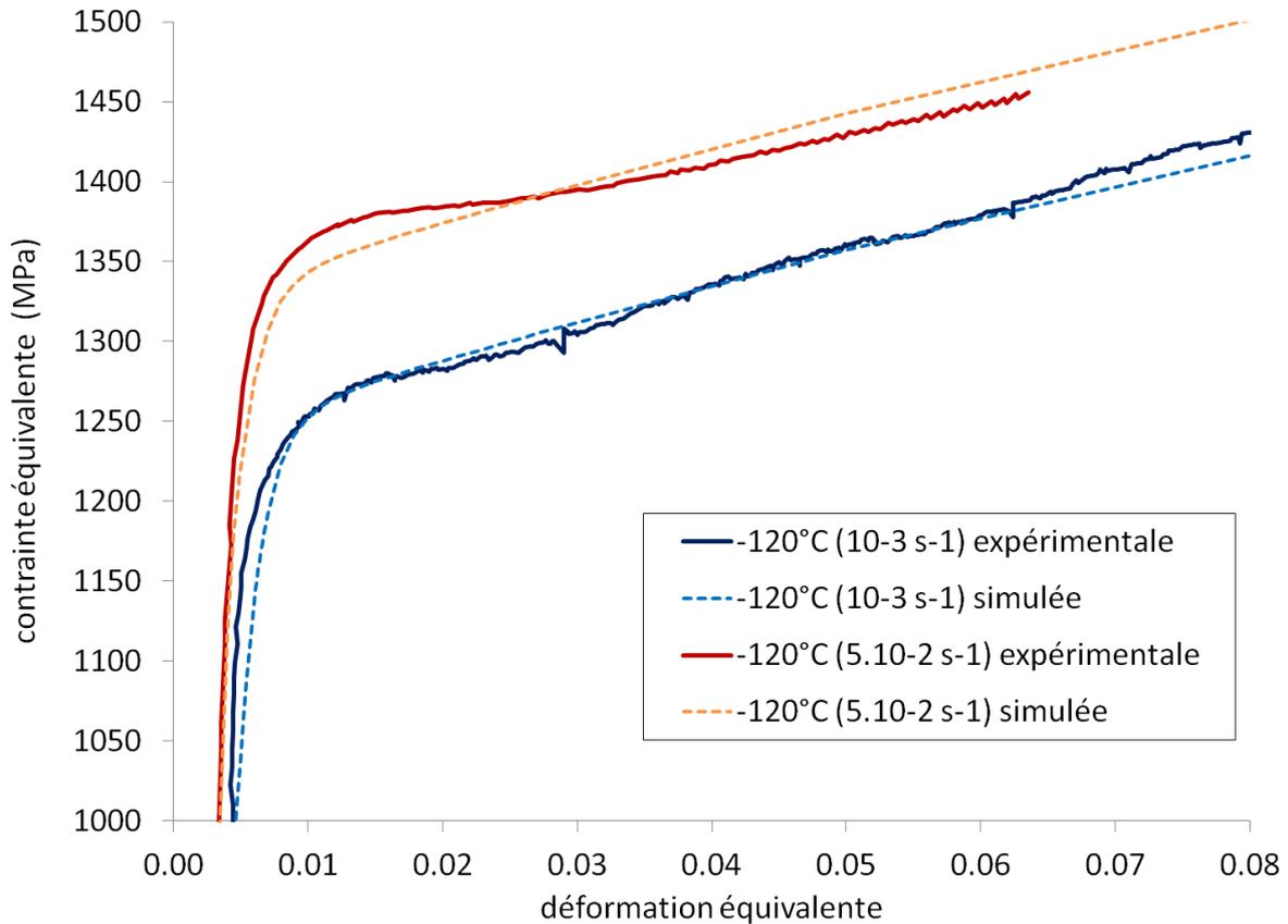
Figure V-12 : Simulations numériques des essais de traction à -120°C avec  $K=300$  MPa et  $n=7$ .
