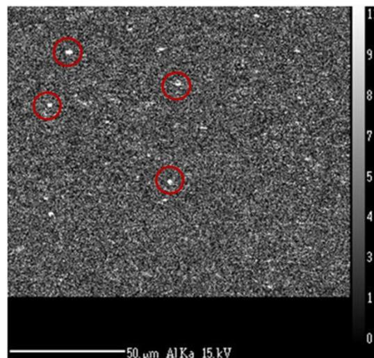
**Figure V-38 : Cartographie de l'élément aluminium réalisée à la microsonde de Castaing sur la nuance J27, les inclusions d'aluminium sont considérées comme les sites d'amorçage préférentiels de la rupture par clivage.**
