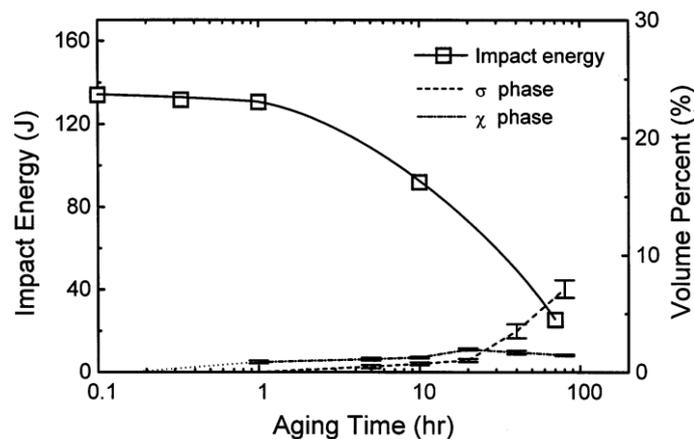
Figure III-17 : Evolutions de l'énergie à rupture mesurée lors des essais Charpy, en fonction de la fraction volumique de phases  $\sigma$  et  $\chi$  et de la durée du vieillissement à 850°C d'un acier duplex à 22%Cr-5,5%Ni-3%W [Kim-1998].
