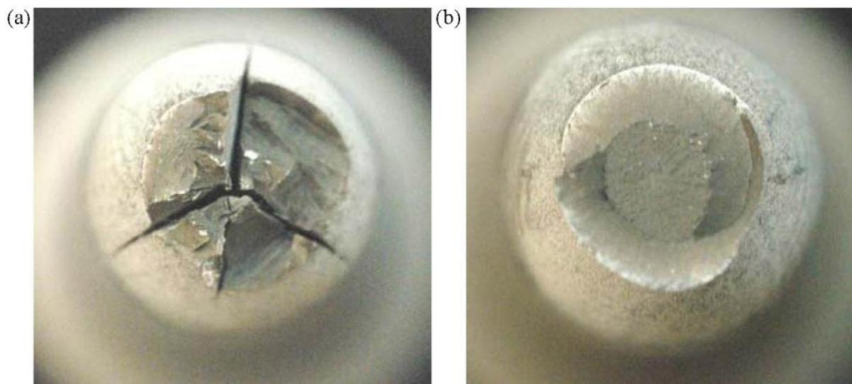
Figure IV-19 : Faciès de rupture de la nuance PM2000 non-vieillie obtenus en traction à température ambiante et en sollicitation longitudinale à la vitesse de a)  $5.10^{-5} \text{ s}^{-1}$  et b)  $5.10^{-2} \text{ s}^{-1}$  [Chao-2009].
