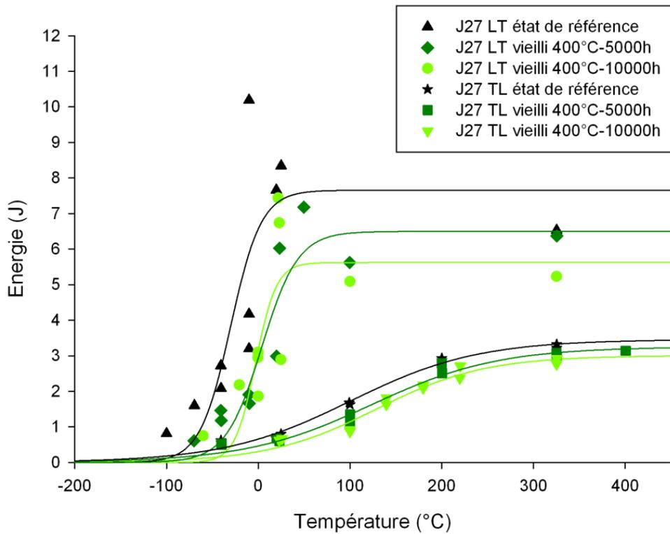
Figure III-52 : Courbes en énergies à rupture de la nuance J27, à l'état de référence et aux états vieillis à 400°C pendant 5000 et 10000 heures, en sollicitation LT et TL.
