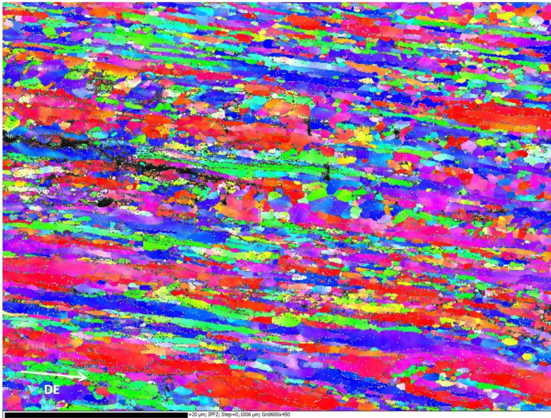
Figure A5-8 : Cartographie de la fissure de bifurcation décrite dans le chapitre IV dans le plan longitudinal selon la direction z, qui est ici perpendiculaire à la direction de filage (DE), donc dirigée selon l'axe radial comme pour l'axe y.
