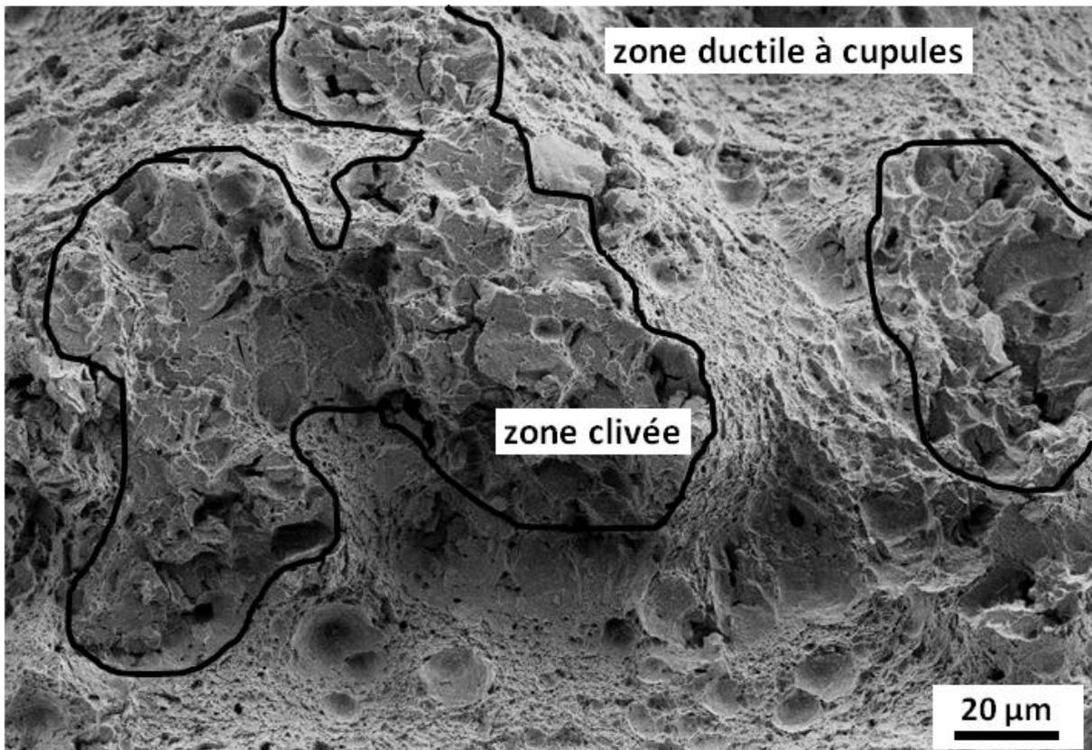
Figure III-37 : Faciès de rupture à +325°C de la nuance J03 vieillie à 600°C pendant 5000 heures, composé de zones ductiles à cupules et de zones rompues par clivage. Les zones rompues par clivage sont délimitées par un trait noir.
