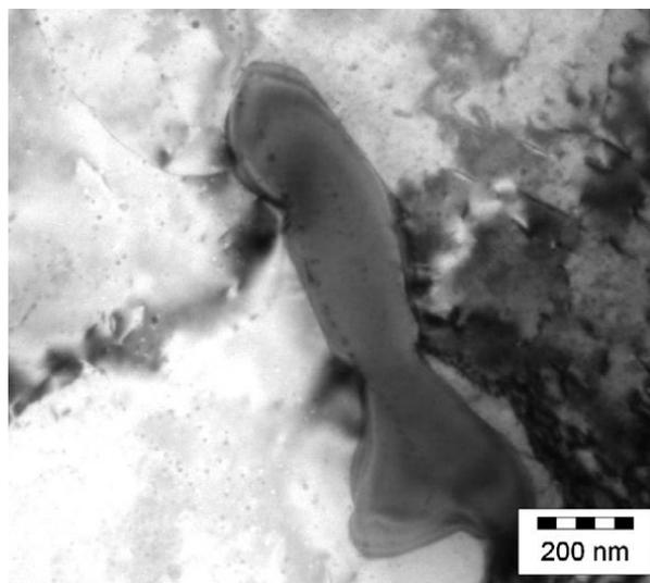
Figure II-1 : Carbure de chrome de type  $(Cr,Fe)_{23}C_6$  observé dans une nuance d'acier ODS à 14%Cr-1%W-0,25Ti-0,3%Y<sub>2</sub>O<sub>3</sub> [Olier-2013].
