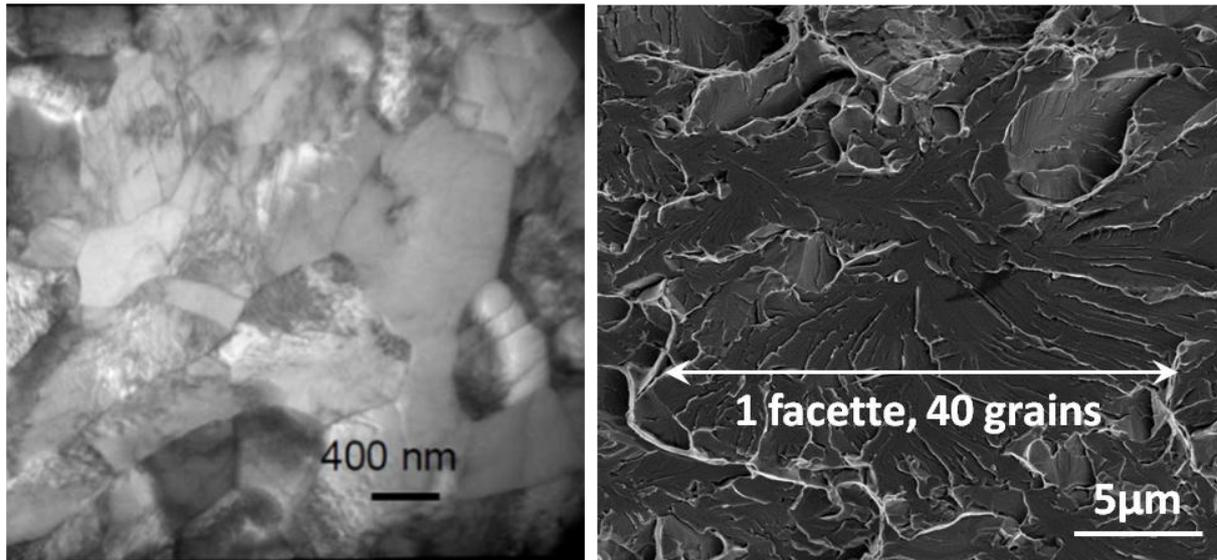
**Figure I-16 : Comparaison entre la taille des grains observés au MET sur la nuance F43 et celle des facettes de clivage observées sur le faciès de rupture de l'éprouvette testée à  $-130^{\circ}\text{C}$ . La facette de clivage observée correspond à environ 40 grains.**
