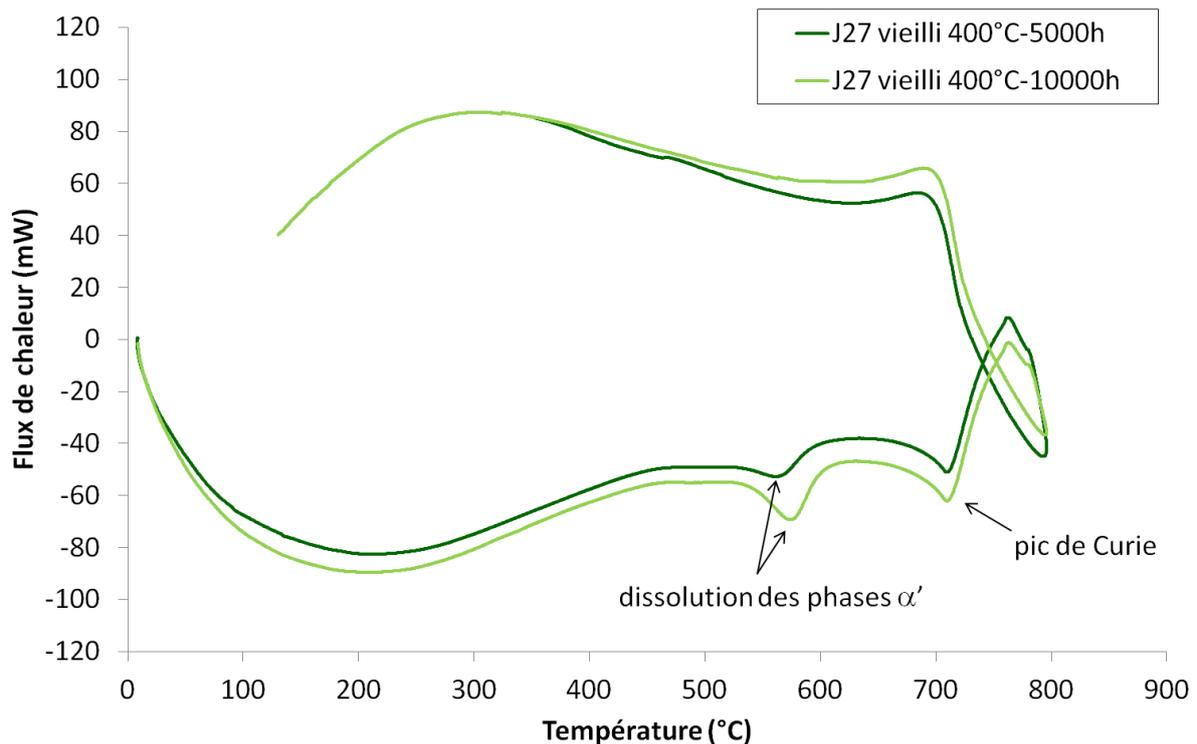
Figure III-67 : Cycles obtenues par calorimétrie différentielle pour la nuance J27 vieillie à 400°C pendant 5000 et 10000 heures. La vitesse de chauffage et de refroidissement est de 10°C/min.
