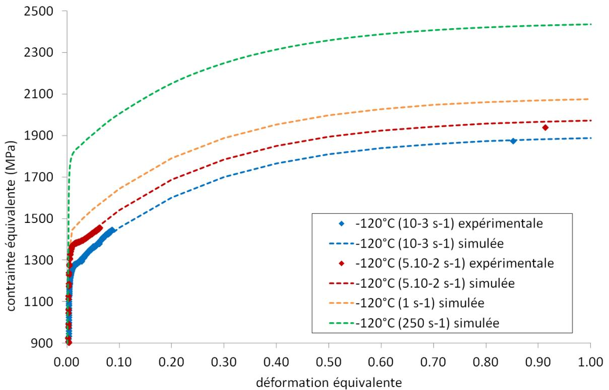
Figure V-20 : Simulations numériques des essais de traction menés en sollicitation axiale à -120°C aux vitesses de  $10^{-3} \text{ s}^{-1}$ ,  $5.10^{-2} \text{ s}^{-1}$ ,  $1 \text{ s}^{-1}$  et  $250 \text{ s}^{-1}$ .
