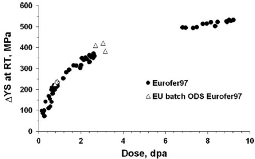
Figure I-9 : Evolution de l'augmentation de la limite d'élasticité à température ambiante des nuances EUROFER97 et EUROFER97 ODS sous irradiation à 300°C [Lugiznova-2012].
