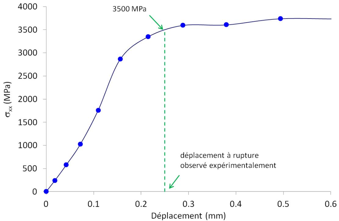
Figure V-30 : Evolution de la contrainte  $\sigma_{xx}$  au point de Gauss correspondant à la position du site d'amorçage du clivage de l'éprouvette mini-Charpy sollicitée à la vitesse de 3,83 m/s à la température de  $-100^{\circ}\text{C}$ .
