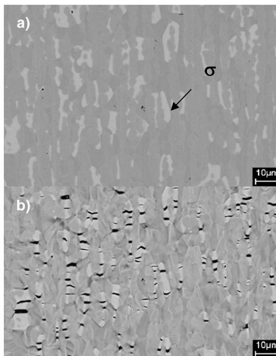
Figure III-18 : Evolution de la microstructure lors d'un essai de traction in-situ d'un acier duplex recuit à 950°C : a) microstructure après recuit, la phase  $\sigma$  apparaît en gris clair, et b) fissuration de la phase  $\sigma$  lors de l'essai de traction [Pohl-2007].
