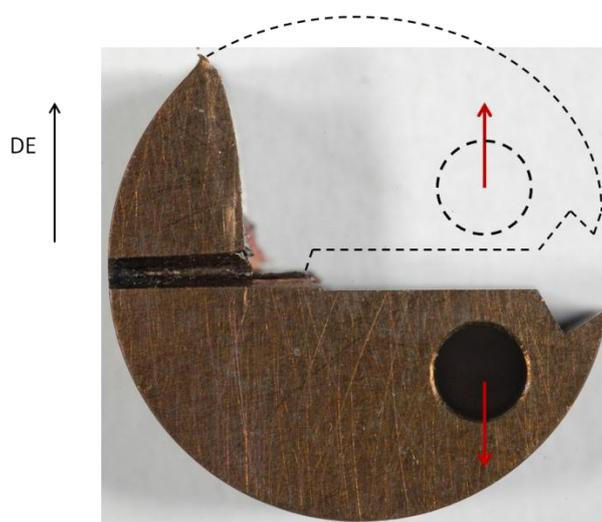
**Figure VI-2 : Eprouvette de ténacité issue de la nuance J05 rompue par bifurcation à la température de 20°C. Les flèches indiquent la direction de traction. La direction d'extrusion (DE) est représentée.**
