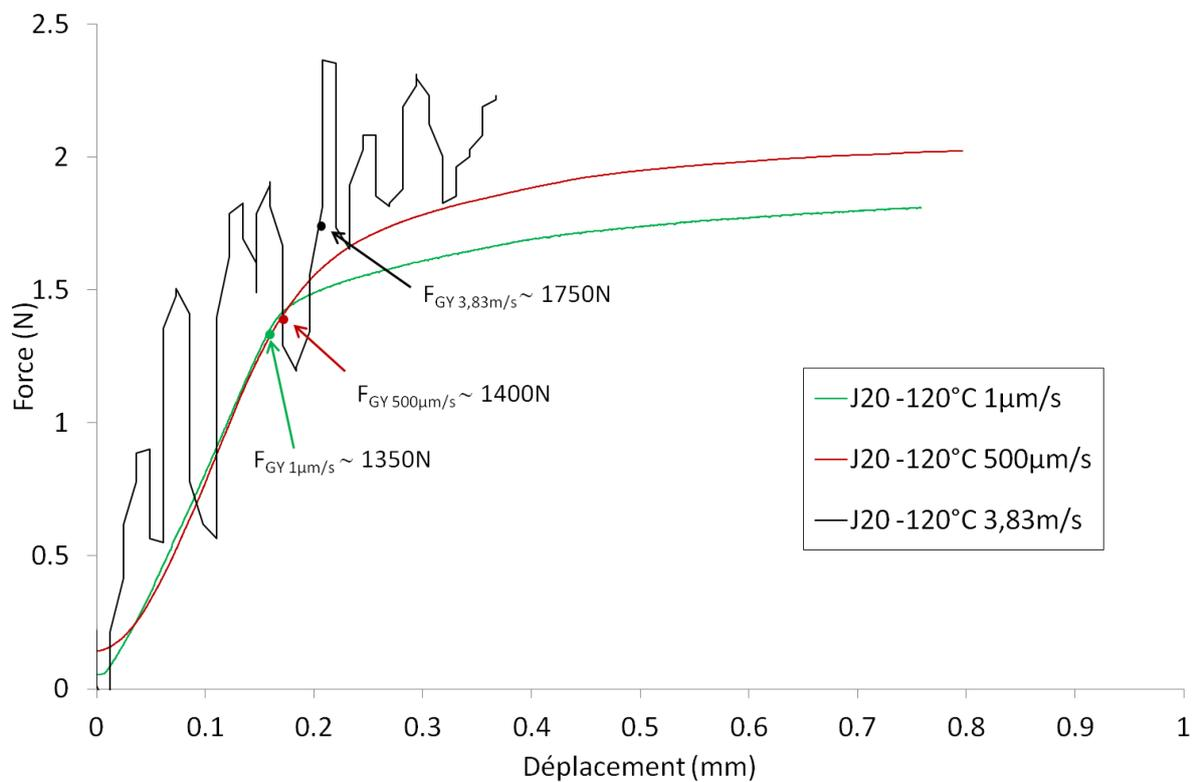
Figure V-7 : Courbes de flexion et de résilience et valeurs de  $F_{GY}$  de la nuance J20 à la vitesse de 1  $\mu\text{m/s}$ , 500  $\mu\text{m/s}$  et 3,8 m/s, à la température de -120°C en sollicitation LT.
