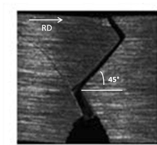
Figure IV-56 : Faciès de rupture de la nuance PM2000 filée sous forme de tube et testée en sollicitation LT à  $-196^{\circ}\text{C}$ . Les plans de rupture sont inclinés à  $45^{\circ}$  par rapport à l'axe de laminage RD [Chao-2013].
