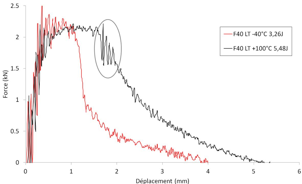
Figure IV-39 : Courbes force-déplacement associées aux éprouvettes de la nuance F40 testées en résilience en sollicitation LT à  $-40^{\circ}\text{C}$  et  $+100^{\circ}\text{C}$ . Les oscillations repérées sont probablement associées à l'apparition d'une fissure de délaminage.
