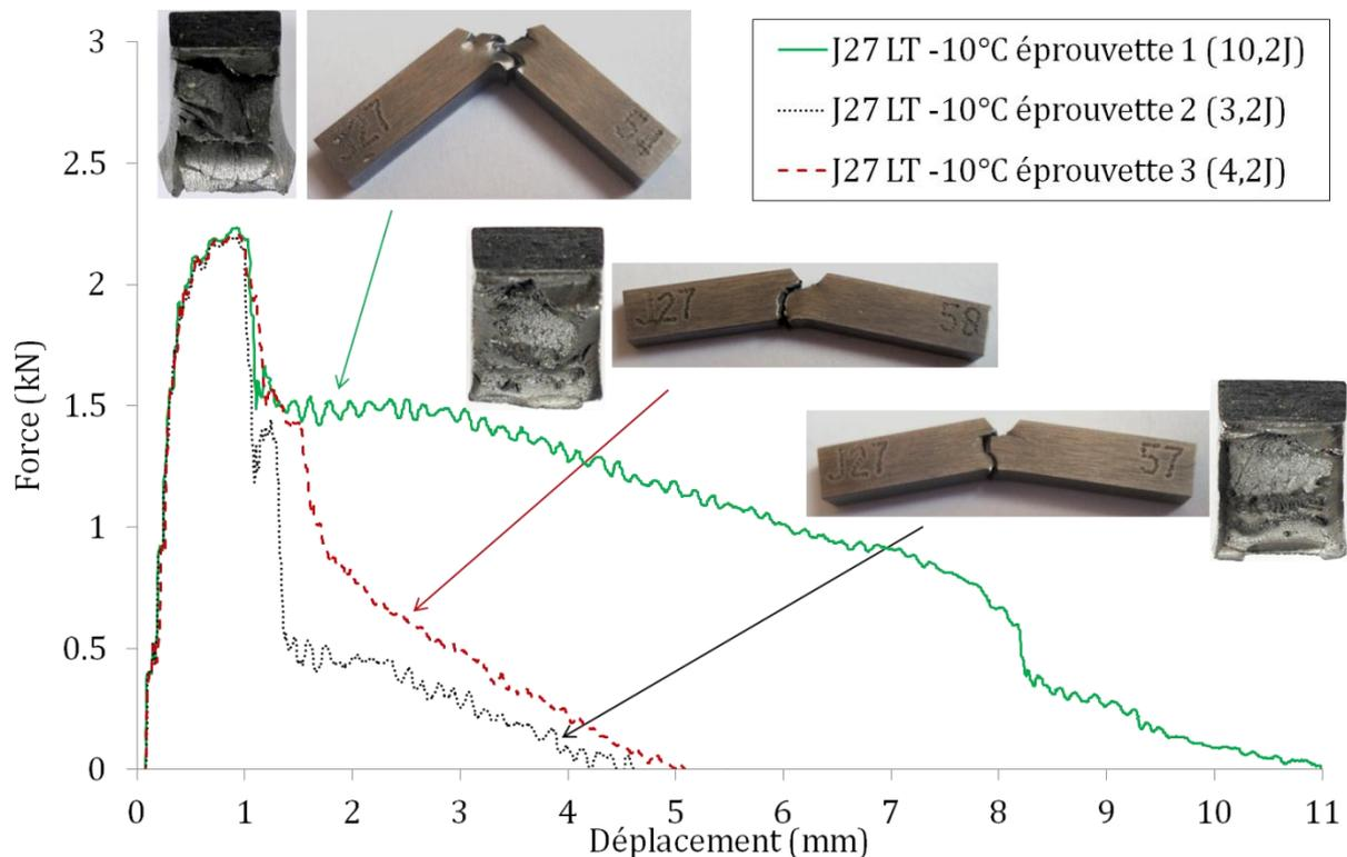
**Figure IV-22 : Courbes force-déplacement et faciès de rupture des éprouvettes de résilience testées à -10°C issues de la nuance J27. Le mécanisme de rupture de type bifurcation est apparu de manière significative sur l'éprouvette n°1 dont l'énergie à rupture est de 10,2 J.**
