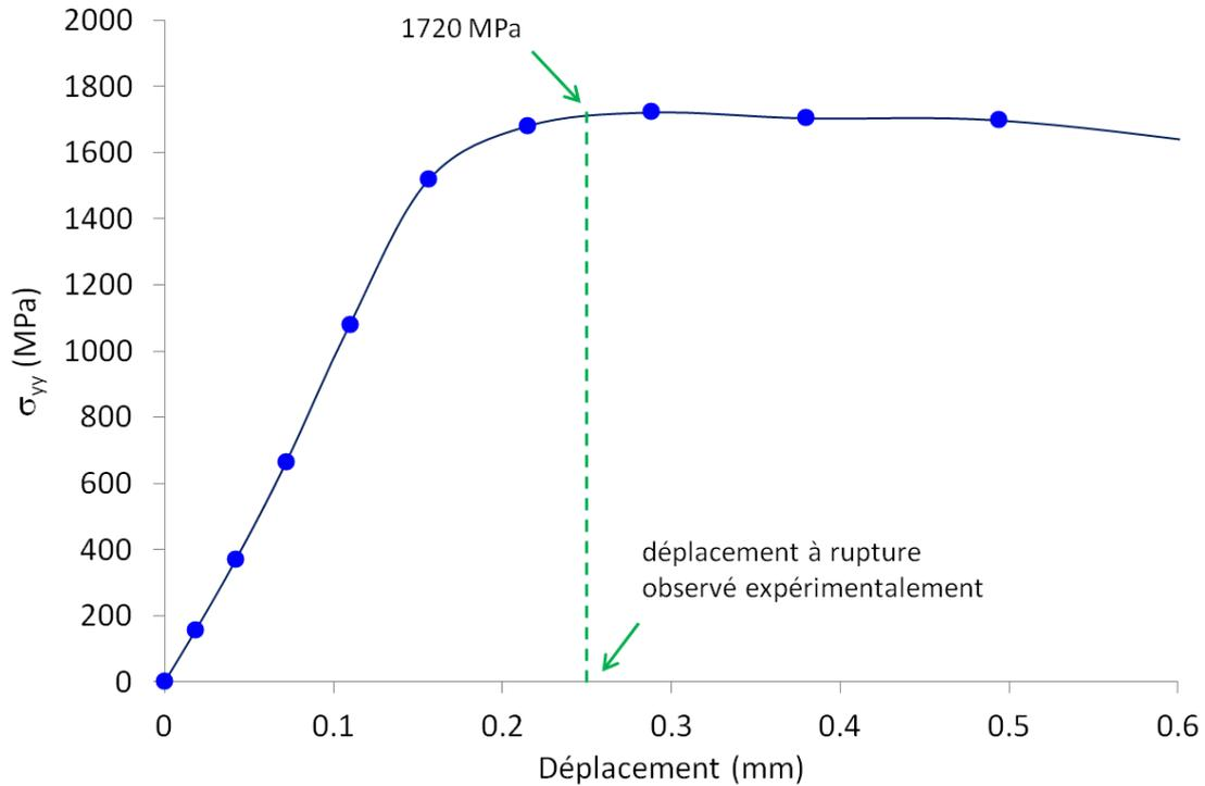
Figure V-32 : Evolution de la contrainte  $\sigma_{yy}$  au point de Gauss correspondant à la position du site d'amorçage du clivage de l'éprouvette mini-Charpy sollicitée à la vitesse de 3,83 m/s à la température de -100°C.
