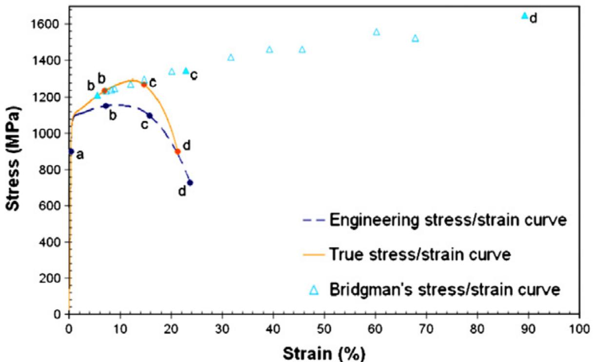
Figure V-3 : Evolution de la contrainte en fonction de la déformation de la nuance J05 sollicitée dans la direction axiale à la vitesse de  $10^{-3} \text{ s}^{-1}$ . La courbe contrainte équivalente – déformation équivalente a été obtenue par corrélation d'image avec la méthode de Bridgman [Steckmeyer-2010].
