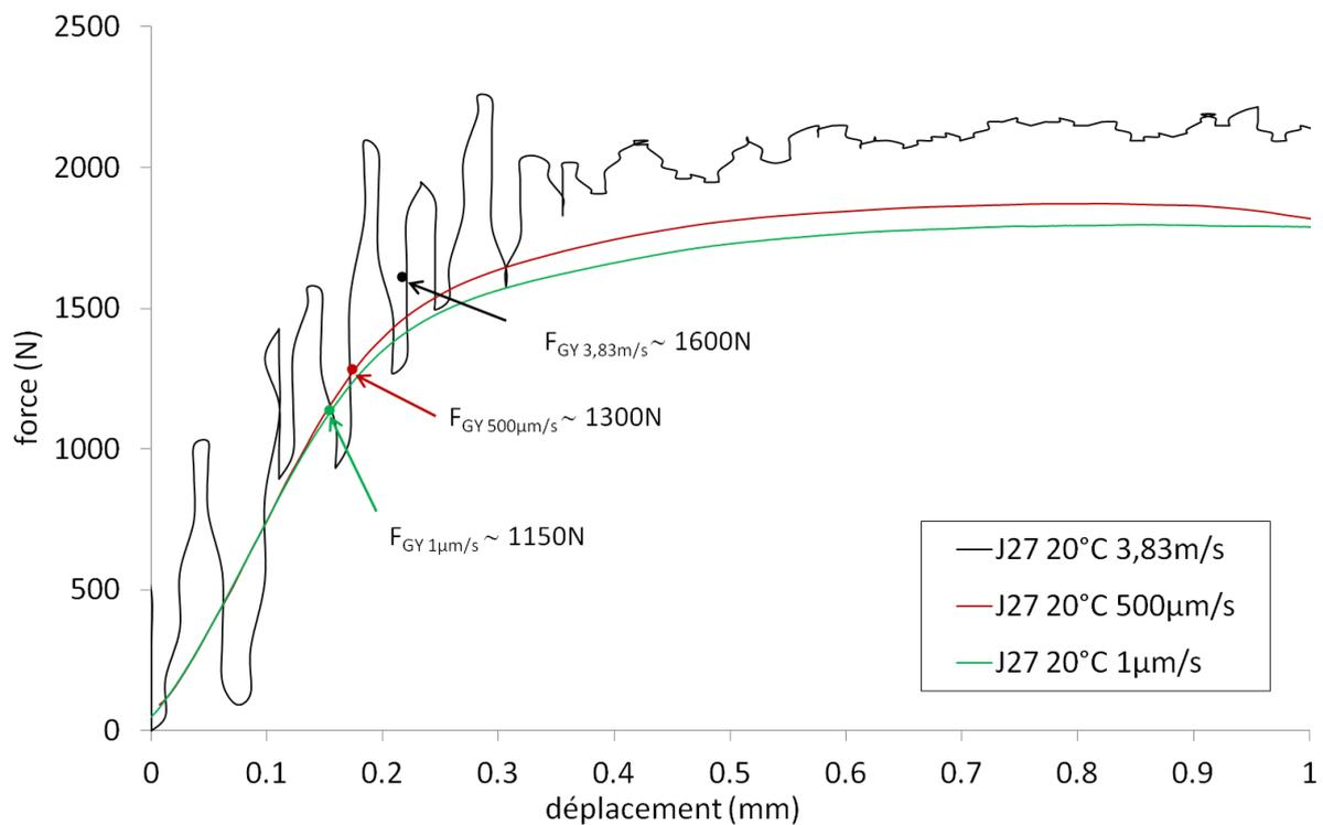
Figure V-6 : Courbes de flexion et de résilience et valeurs de  $F_{GY}$  de la nuance J27 à la vitesse de 1  $\mu\text{m/s}$ , 500  $\mu\text{m/s}$  et 3,8 m/s, à la température de 20°C en sollicitation LT.
