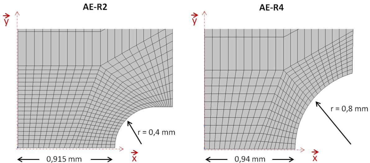
**Figure V-37 : Maillages réalisés avec le logiciel Z-Set et utilisés pour simuler les essais sur éprouvettes AE de type R2 et R4, dont le rayon d'entaille est respectivement égal à 0,4 mm et 0,8 mm. La hauteur de la géométrie maillée est de 7,5 mm, la vue présentée ici est un zoom sur la partie entaillée.**
