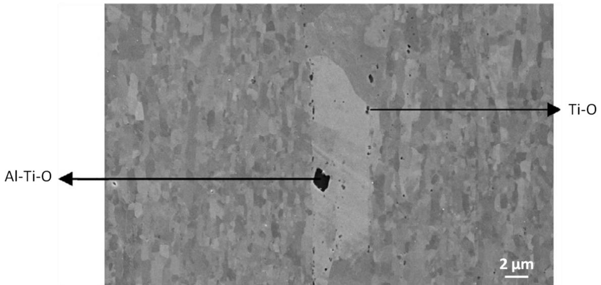
Figure II-4 : Oxydes de titane et oxydes d'aluminium observés dans une nuance d'acier ODS à 14%Cr-1%W-0,25Ti-0,3%Y<sub>2</sub>O<sub>3</sub> [Olier-2013].
