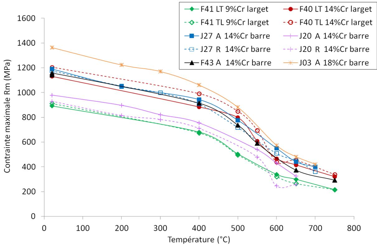
Figure II-17 : Evolution de la contrainte maximale des nuances d'aciers ODS à 9%Cr, 14%Cr et 18%Cr en fonction de la température d'essai à la vitesse de  $10^{-3} \text{ s}^{-1}$  [TEMAS-2009].
