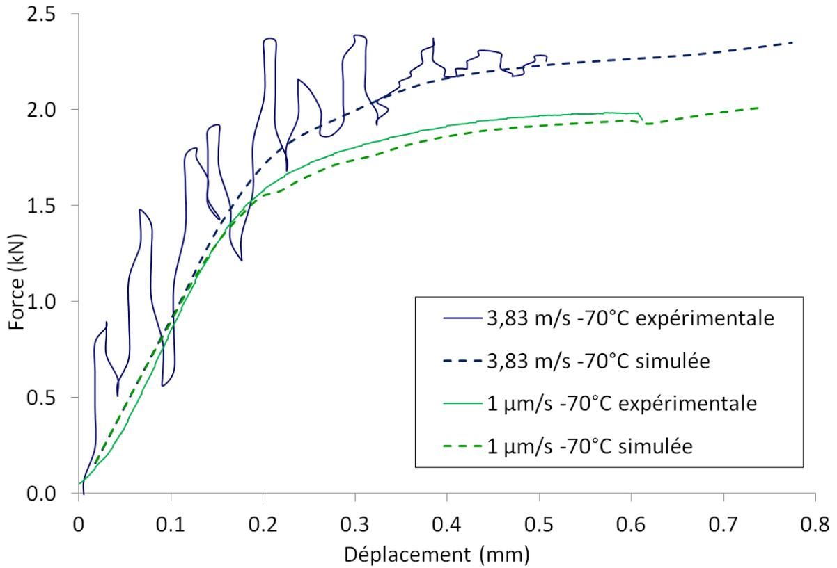
Figure V-25 : Réponses expérimentales et simulées des essais de flexion et de résilience réalisés à -70°C sur la nuance J27 aux vitesses de 1 μm/s et 3,8 m/s, en sollicitation LT.
