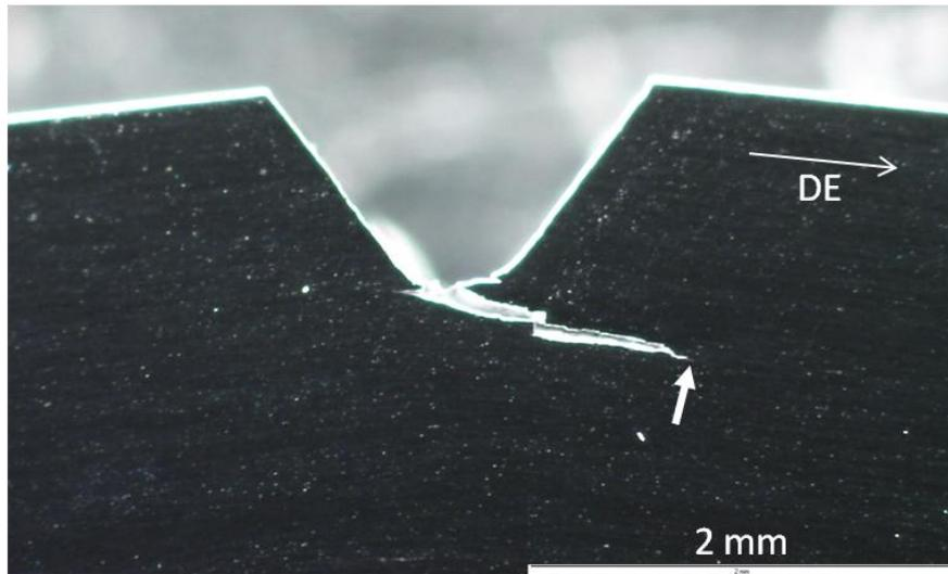
Figure IV-30 : Localisation de la pointe d'une fissure de bifurcation observée sur une éprouvette de flexion issue de la nuance J27 testée en sollicitation LT à 20°C et 500  $\mu\text{m/s}$  et arrêtée en cours d'essai. La direction d'extrusion (DE) est représentée.
