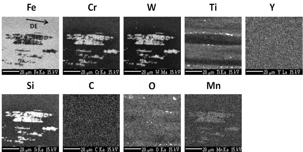
Figure III-44 : Cartographies réalisées à la microsonde de Castaing sur la phase  $\sigma$  observée dans la nuance J03 vieillie à 600°C pendant 5000 heures. La direction d'extrusion (DE) est représentée.
