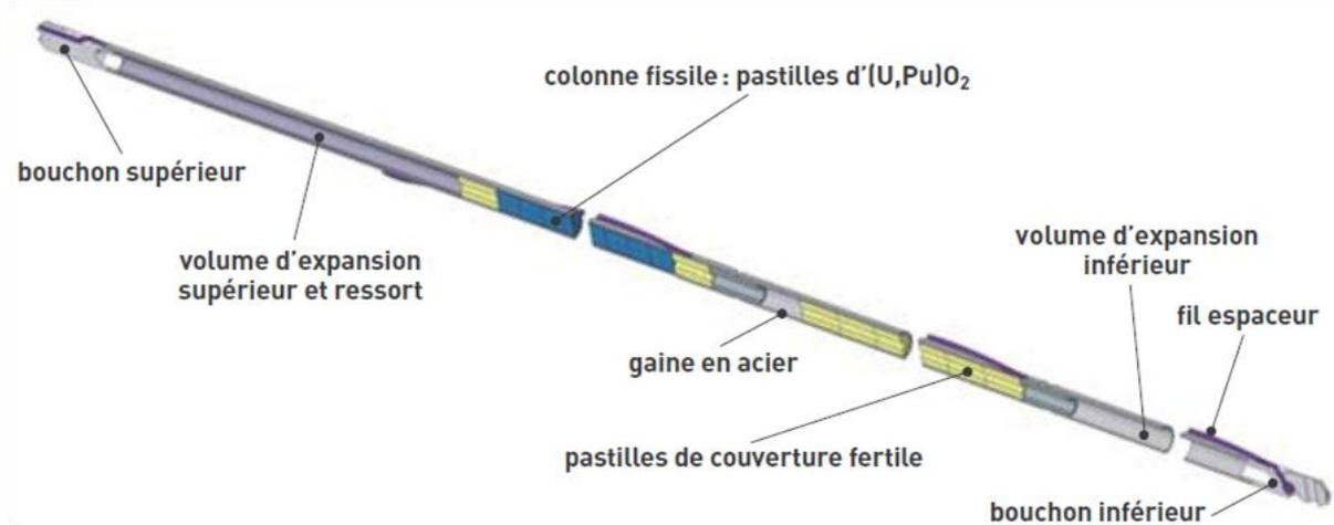
Figure I-2 : Schéma d'une gaine à combustible d'un RNR-Na [Clefs CEA-2007].
