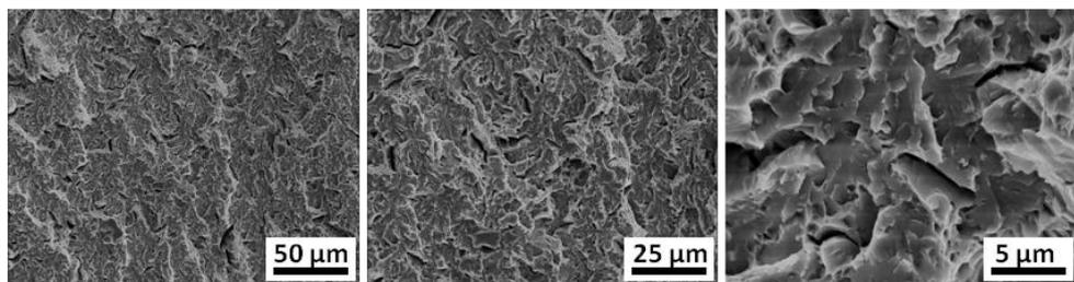
Figure III-60 : Faciès de rupture de la nuance J27 à l'échelle microscopique, avant et après vieillissement thermique à 400°C, 500°C et 600°C pendant 5000 heures, suivant la direction de sollicitation LT à -40°C.
