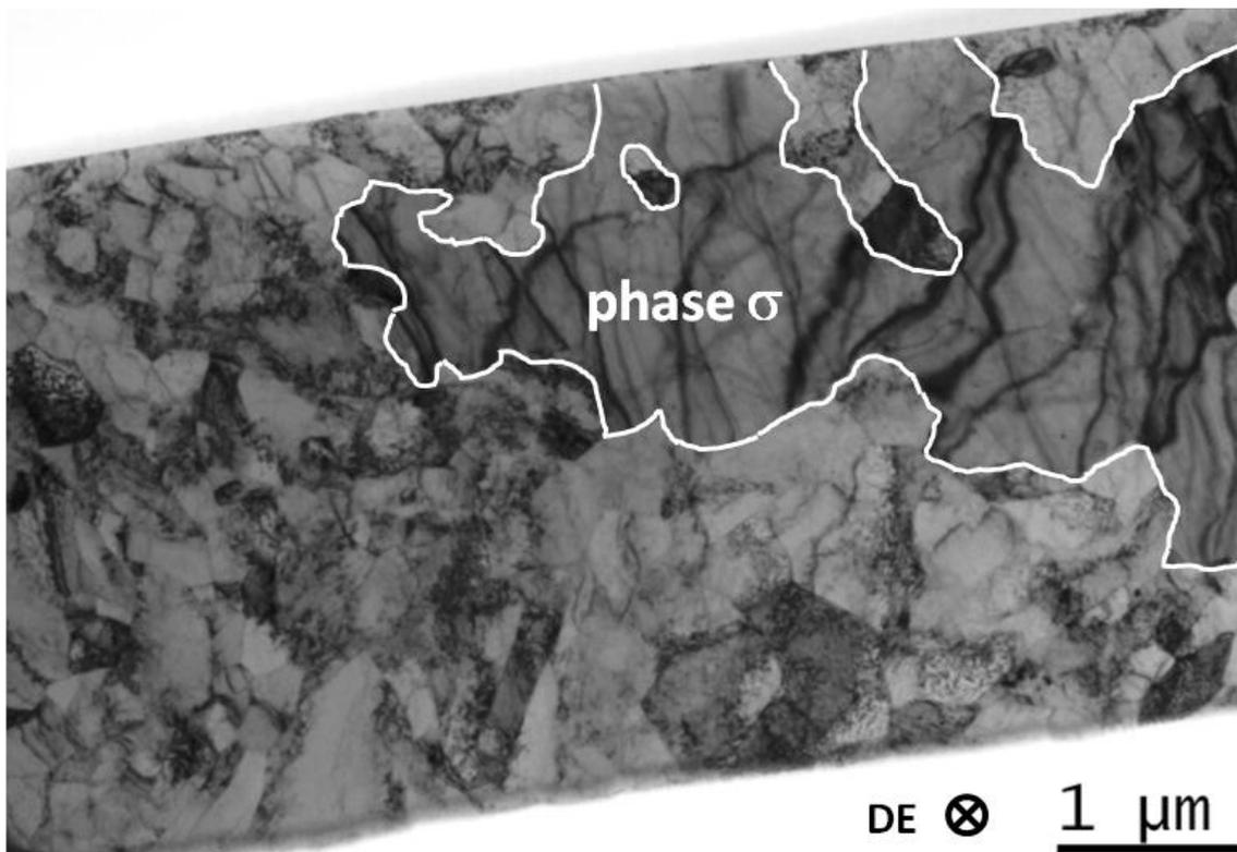
Figure III-48 : Cliché MET de la phase  $\sigma$  observée dans la nuance J03 vieillie à 600°C pendant 5000 heures. La direction d'extrusion (DE) est représentée. Les lignes noires à l'intérieur de la phase  $\sigma$  sont des bandes de contraste.
