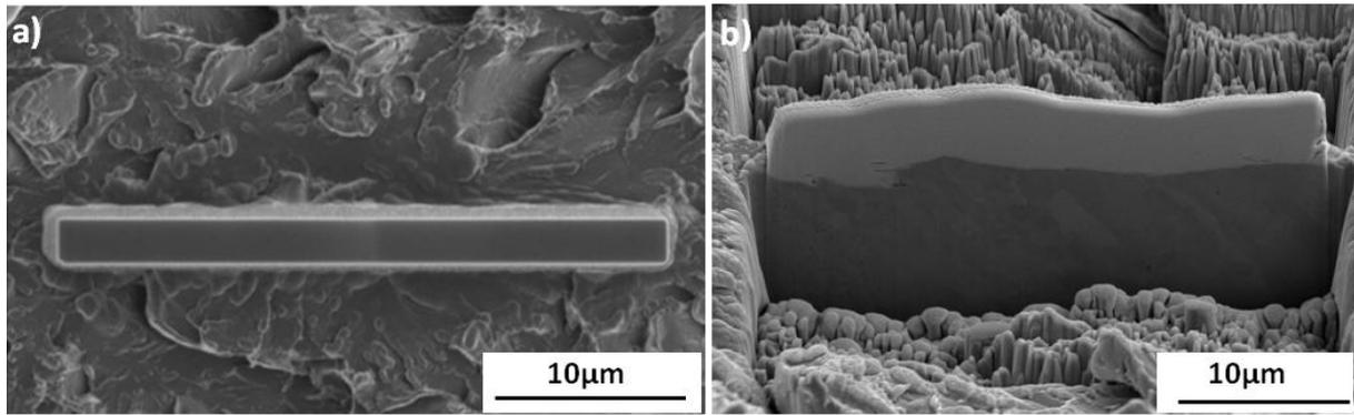
**Figure IV-63 : Découpe d'une lame au FIB sur une facette de clivage de la nuance F43 : a) réalisation d'un dépôt de platine sur la zone à observer en coupe et b) retrait de la matière de part et d'autre du dépôt de platine.**
