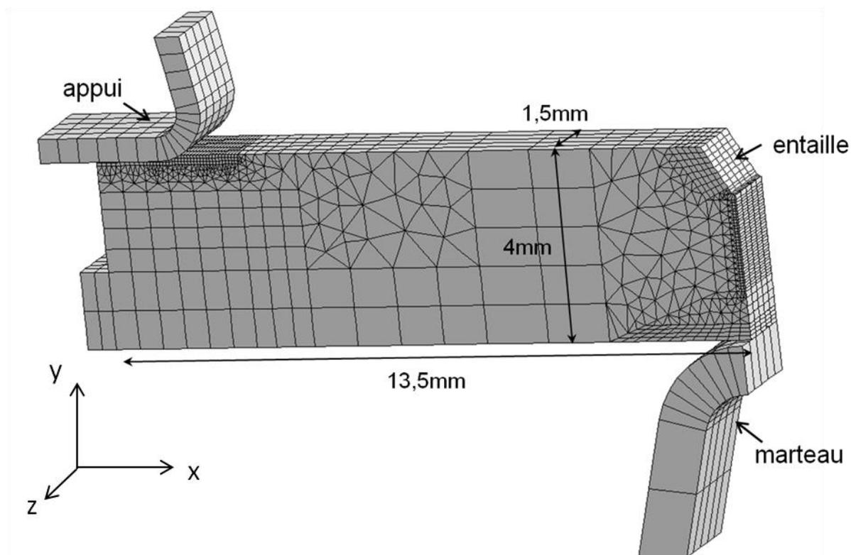
**Figure V-21: Maillage du quart d'une éprouvette mini-Charpy utilisé pour réaliser les simulations numériques avec le code de calcul Z-set. Un appui et la moitié du marteau sont également représentés.**
