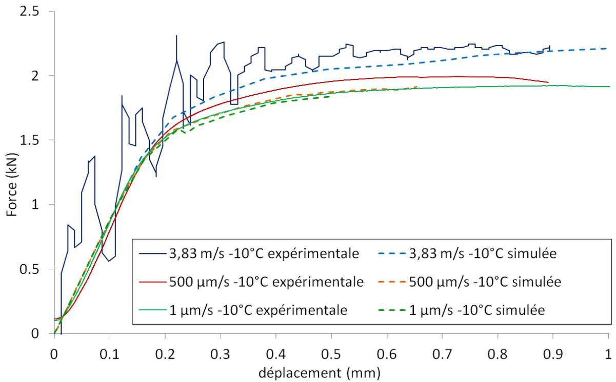
Figure V-23 : Réponses expérimentales et simulées des essais de flexion et de résilience réalisés à -10°C sur la nuance J27 aux vitesses de 1  $\mu\text{m/s}$ , 500  $\mu\text{m/s}$  et 3,8 m/s, en sollicitation LT.
