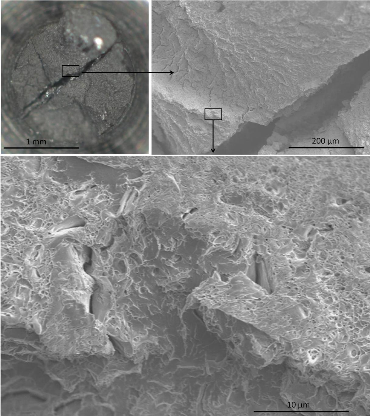
Figure V-44 : Identification d'un site d'amorçage potentiel de la rupture par clivage situé au centre de l'éprouvette AE-R4 testée en sollicitation axiale à -120°C.
