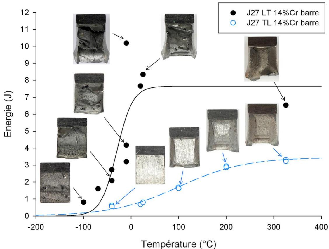
**Figure II-29 : Courbes en énergie à rupture et vues macroscopiques des faciès de rupture de la nuance J27 à 14%Cr filée sous forme de barre, sollicitée en sens LT et TL.**
