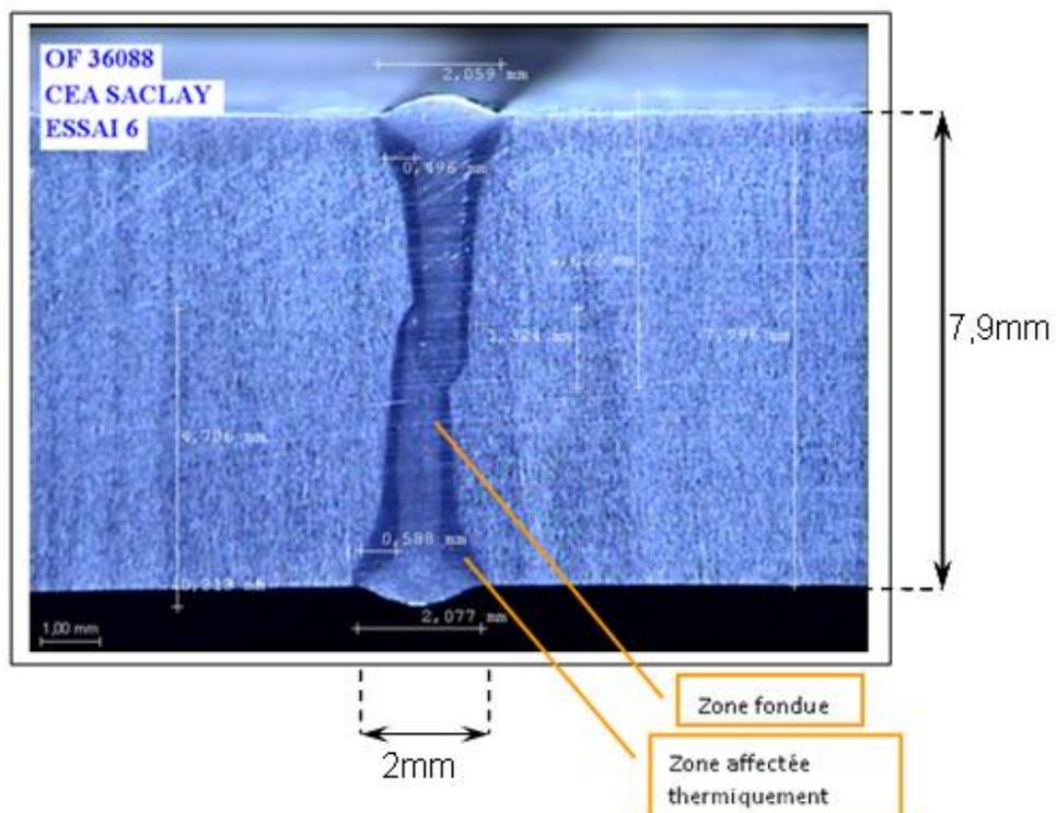
Figure A1-3 : mesures de la zone fondue et de la zone affectée thermiquement après soudage au LASER CO<sub>2</sub> par la société SAFEL.
