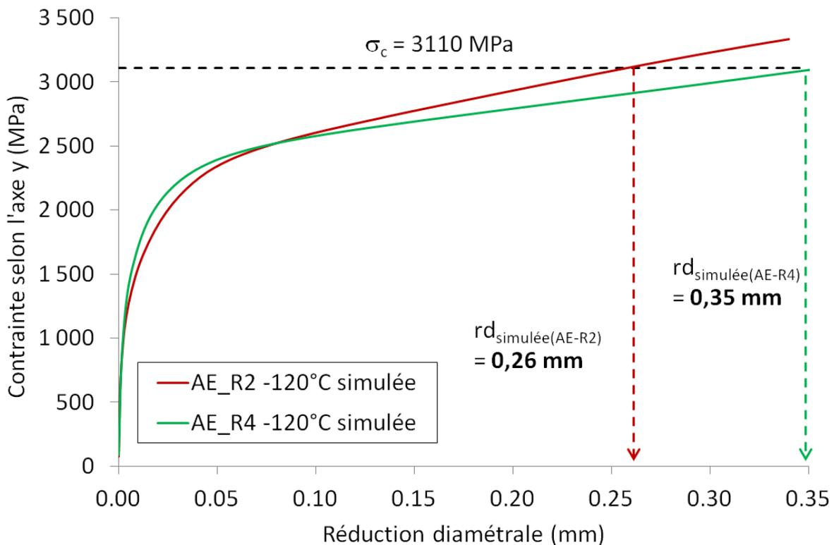
Figure V-39 : Simulation de l'évolution de la contrainte  $\sigma_{yy}$  en fonction de la réduction diamétrale donnée dans le cas des essais de traction à  $-120^\circ\text{C}$  sur les géométries AE-R2 et AE-R4. D'après le modèle, la contrainte critique de 3110 MPa est atteinte lorsque la réduction diamétrale de la section en fond d'entaille est égale à 0,26 mm sur la géométrie AE-R2 et 0,35 mm sur la géométrie AE-R4.
