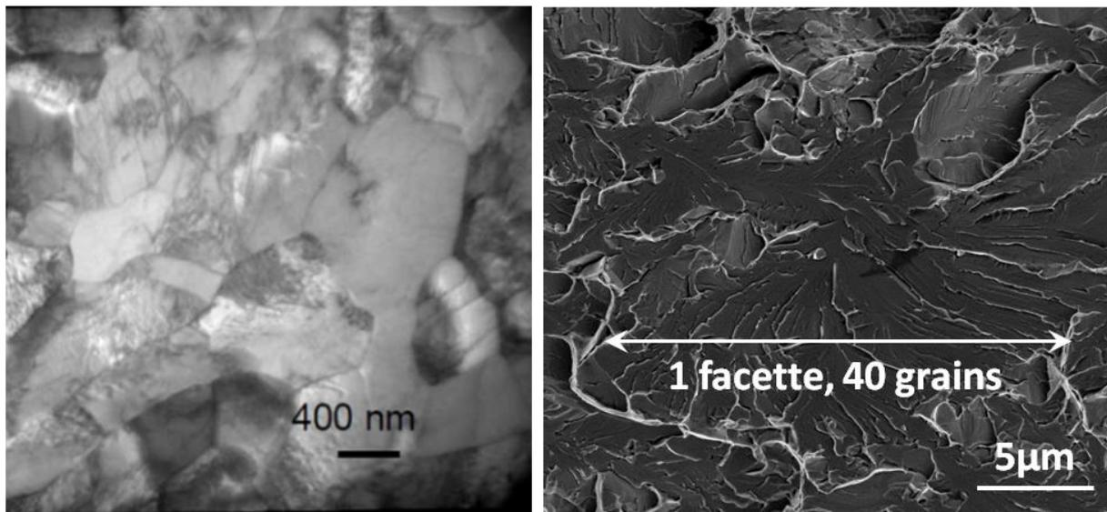
Figure IV-62 : Comparaison entre la taille des grains observés au MET sur la nuance F43 et celle des facettes de clivage observées sur le faciès de rupture de l'éprouvette testée à  $-130^{\circ}\text{C}$ . La facette de clivage observée contient environ 40 grains.
