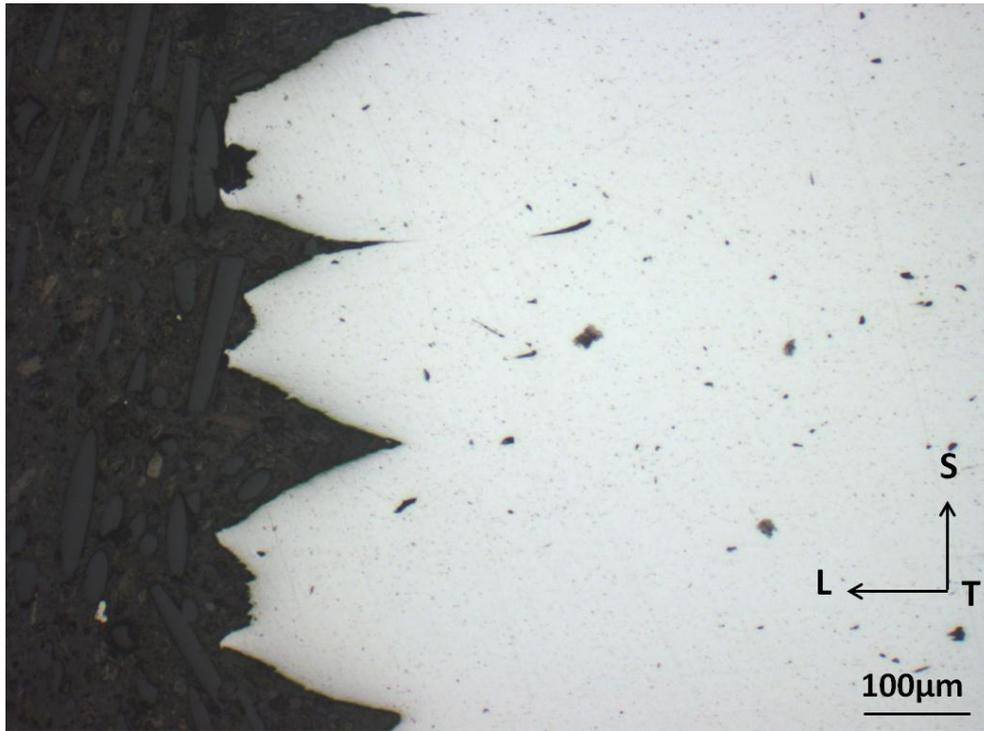
**Figure IV-40 : Micrographie réalisée au microscope optique sur une éprouvette de résilience de la nuance F40 rompue à -40°C en sollicitation LT. L'éprouvette est observée dans le plan L-S, les directions L, T et S du target sont représentées. Les éléments sombres sont des artefacts dus au polissage.**
