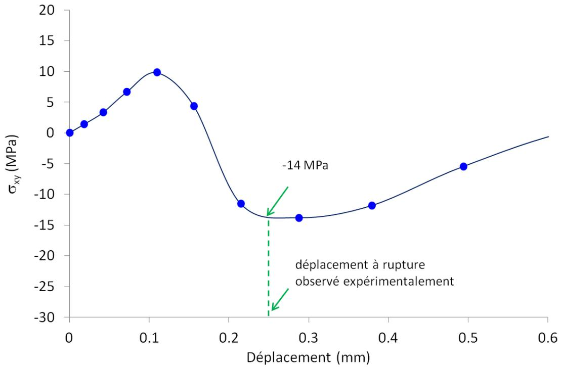
Figure V-31 : Evolution de la contrainte  $\sigma_{xy}$  au point de Gauss correspondant à la position du site d'amorçage du clivage de l'éprouvette mini-Charpy sollicitée à la vitesse de 3,83 m/s à la température de -100°C.
