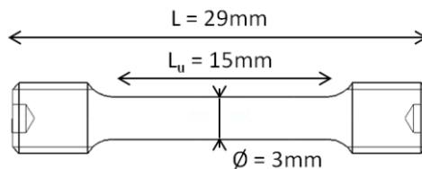
**Figure II-11 : Schéma d'une éprouvette de traction cylindrique.**
