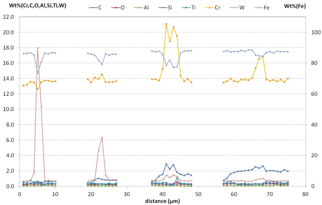
Figure III-64 : Profil d'analyse réalisé sur la nuance J27 à l'état vieilli à 600°C pendant 10000 heures. Les composés quantifiés entre les distances de 0 et 30  $\mu\text{m}$  sont des phases de Laves  $\text{Fe}_2\text{W}$ , et ceux entre 30 et 80  $\mu\text{m}$  sont des carbures de Cr, probablement de type  $\text{M}_{23}\text{C}_6$ .
