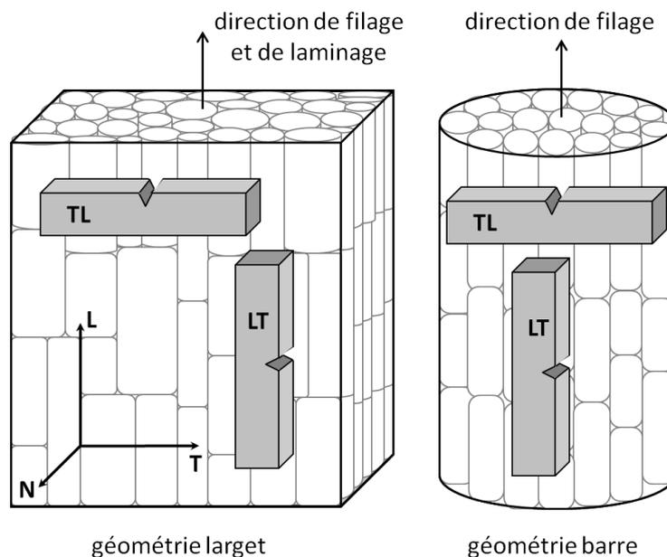
**Figure II-21 : Schéma des éprouvettes mini-Charpy prélevées en sens LT et TL dans les géométries largets (F41 et F40) et dans la barre J27 de diamètre 36 mm, et de la microstructure sous-jacente.**
