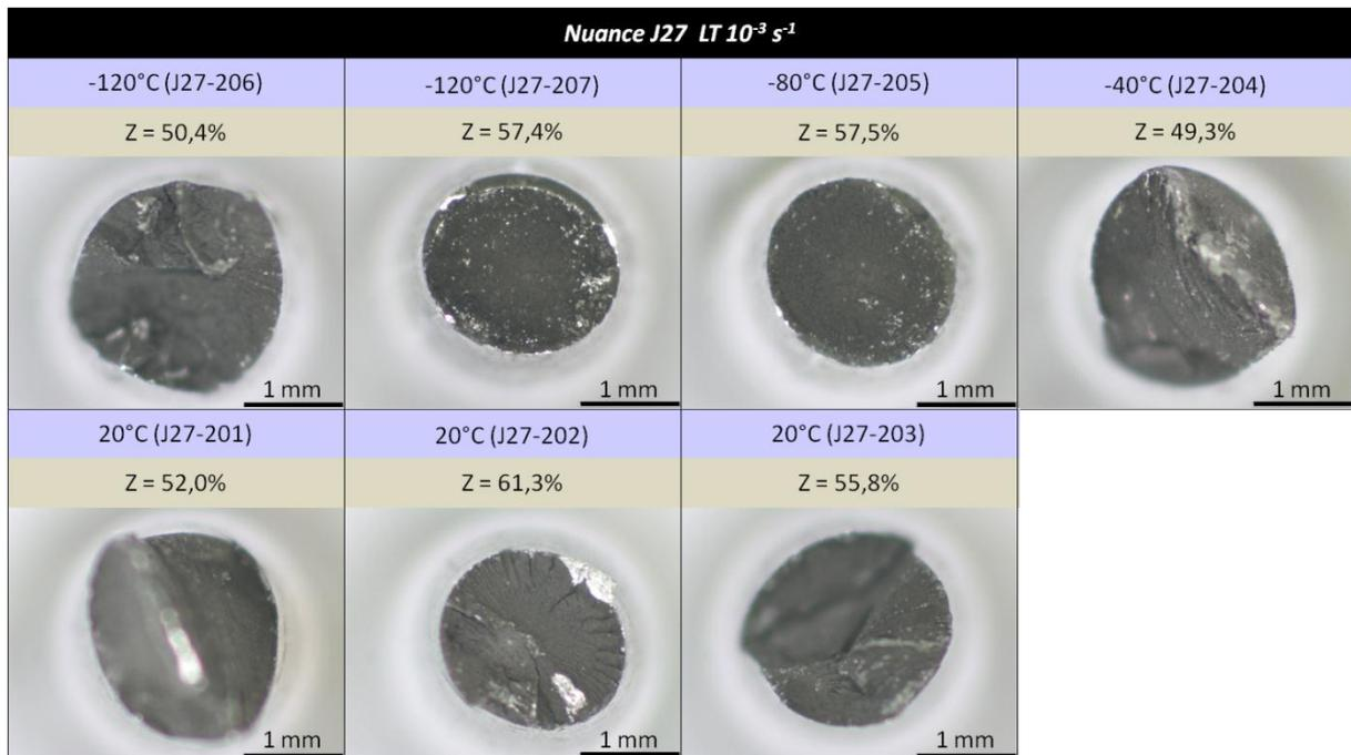
Figure A3-1 : Vues macroscopique des faciès de rupture et coefficients de striction de la nuance J27 testée en traction à basse température à la vitesse de déformation moyenne de  $10^{-3} s^{-1}$ .
