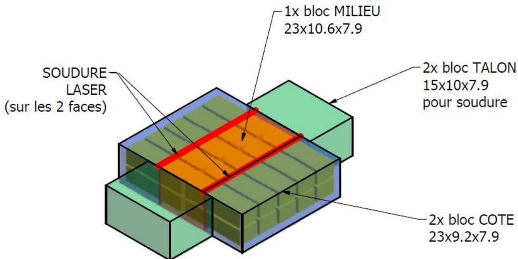
Figure A1-2 : Schéma de la disposition des différents blocs lors du soudage au LASER CO<sub>2</sub>.
