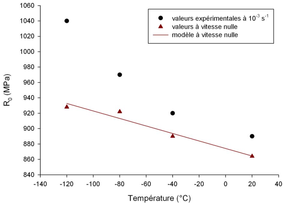
Figure V-14 : Evolution du paramètre  $R_0$  (équation V.11) en fonction de la température, à la vitesse de déformation de  $10^{-3} \text{ s}^{-1}$  et à la vitesse de référence.
