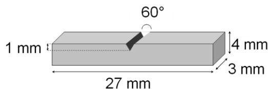
Figure II-20 : Schéma d'une éprouvette de résilience de type mini-Charpy.
