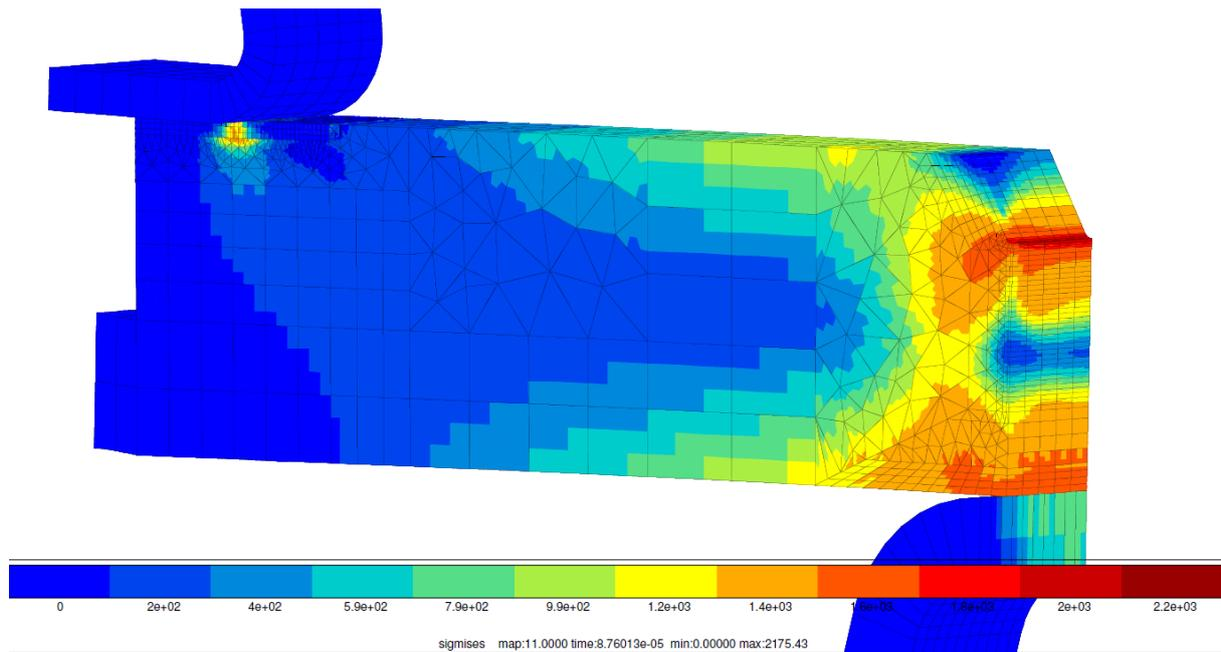
Figure V-27 : Champs de contrainte équivalente de von Mises observé au cours d'un essai de flexion à  $-100^{\circ}\text{C}$  à la vitesse de 3,83 m/s.
