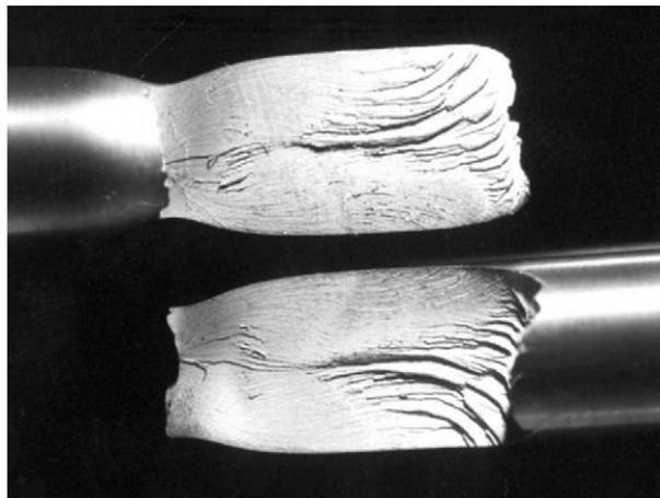
Figure IV-18 : Eprouvette de traction issue de l'acier ODS PM2000 vieilli à 475°C pendant 100 heures, rompue par bifurcation lors d'un essai à température ambiante dans la direction de sollicitation longitudinale [Chao-2009].
