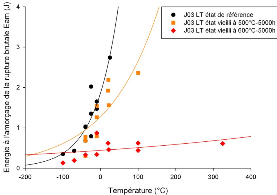
**Figure III-33 : Evolution de l'énergie à l'amorçage de la rupture brutale en fonction de la température pour la nuance J03 à l'état de référence et aux états vieillis à 500°C et 600°C pendant 5000 heures.**
