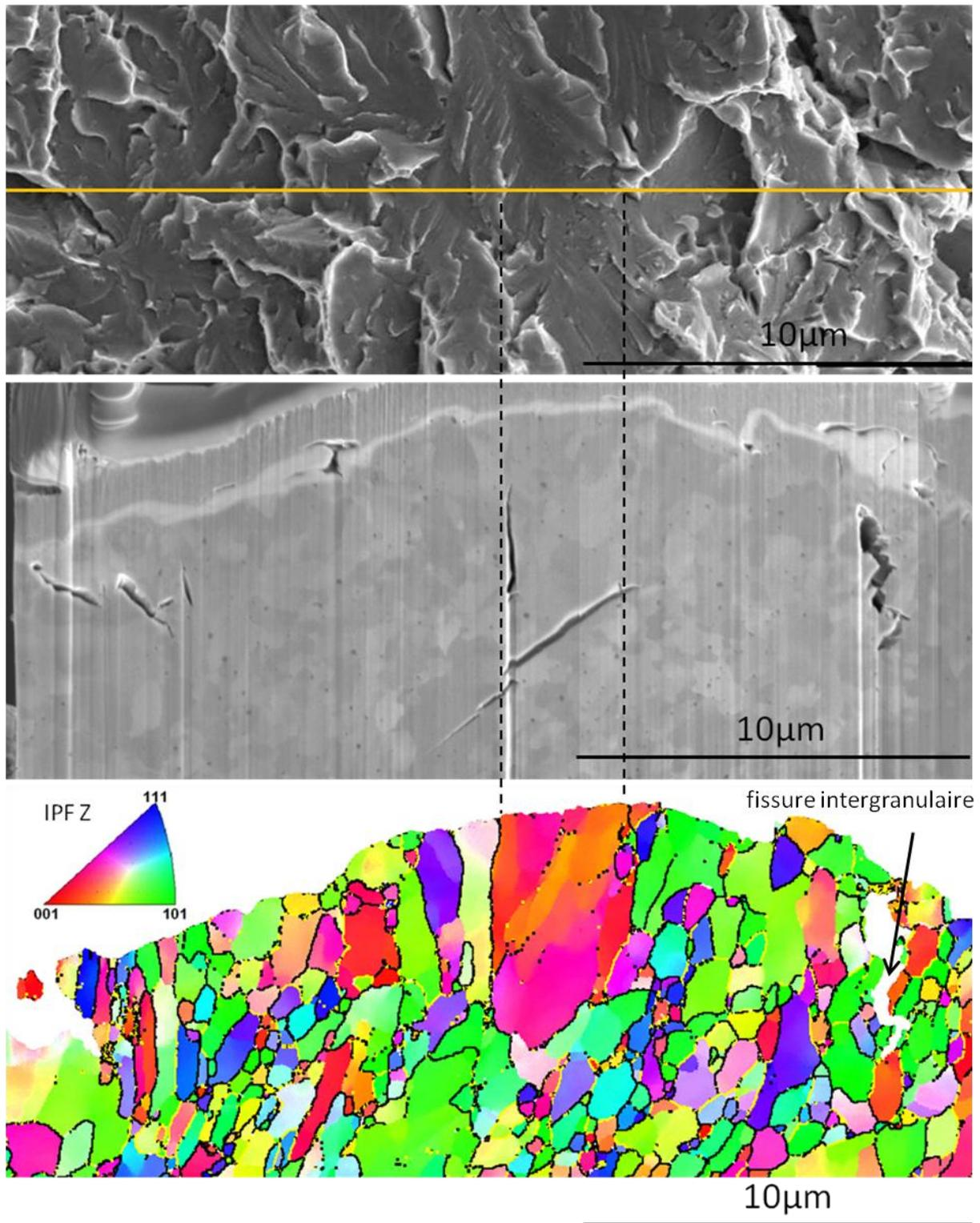
Figure IV-65 : Position de la ligne de découpe sur le faciès de rupture de la nuance F43, lame prélevée au FIB et cartographie EBSD réalisée sur la lame. Sur la cartographie, les joints de grains marqués en noir présentent des désorientations cristallographiques  $> 15^\circ$  et les jaunes des désorientations  $> 50^\circ$ . Une fissure intergranulaire est observée sur cette coupe.
