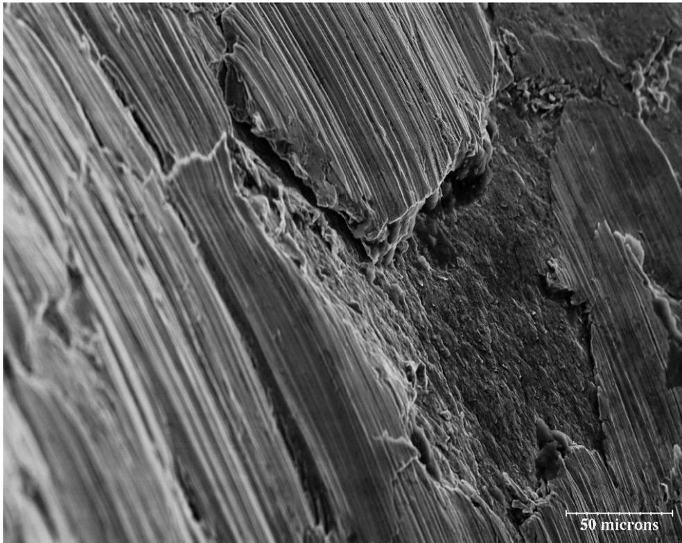
Figure V-49 : Cliché MEB d'un défaut apparu après usinage au tour de la nuance J27 et responsable de l'amorçage de la rupture en surface de l'éprouvette.
