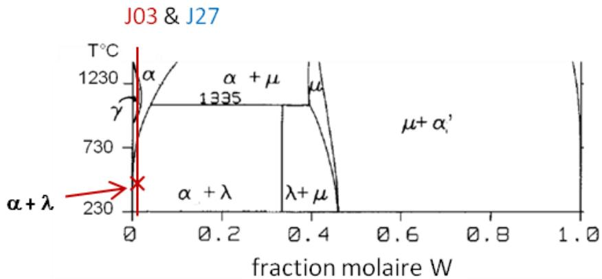
Figure III-2 : Diagramme de phases Fe-W, la phase de Laves  $\lambda$  est de type  $\text{Fe}_2\text{W}$ , la phase  $\mu$  est de type  $\text{Fe}_7\text{W}_6$  [Gustafson-1988]. Le trait rouge correspond à la teneur en tungstène des nuances J03 et J27.
