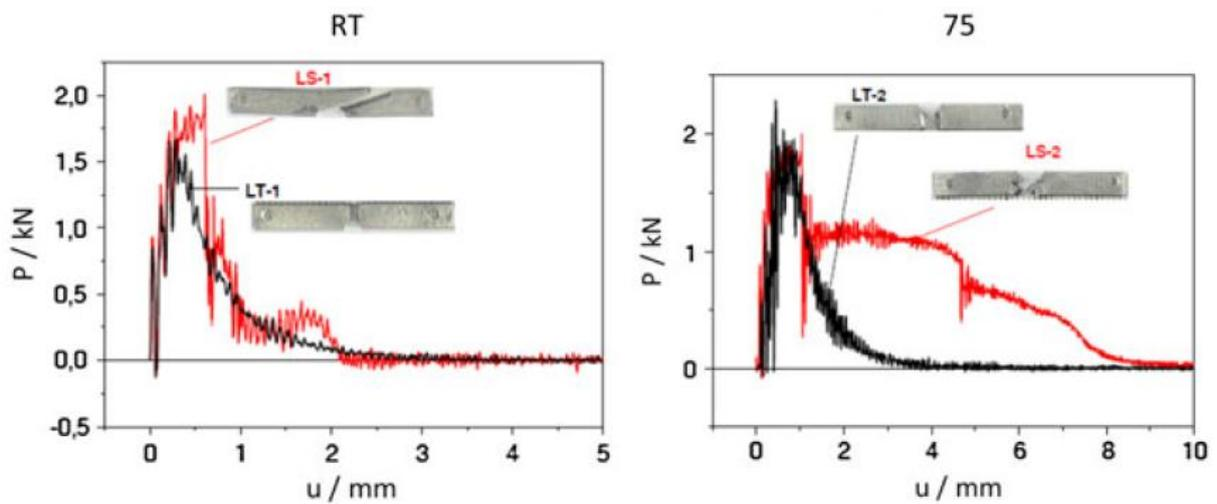
Figure IV-16 : Courbes force (P) - déplacement (u) obtenues lors des essais de résilience en sollicitation LT et LS sur la nuance PM2000 [Chao-2013].
