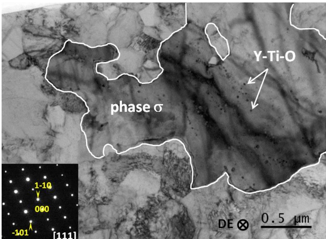
Figure III-49 : Cliché MET et cliché de diffraction de la phase  $\sigma$  observée dans la nuance J03 vieillie à 600°C pendant 5000 heures. Des oxydes de type Y-Ti-O sont présents à l'intérieur de la phase  $\sigma$ . La direction d'extrusion (DE) est représentée.
