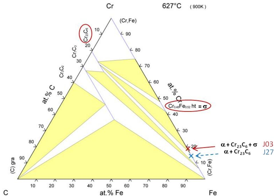
Figure III-5 : Diagramme de phases Fe-Cr-C à 627°C [Raghavan-1994]. Le point marqué par une flèche rouge correspond à la composition de la nuance J03 à 18%Cr, et le point indiqué par la flèche bleue en pointillés correspond à la composition de la nuance J27 à 14%Cr.
