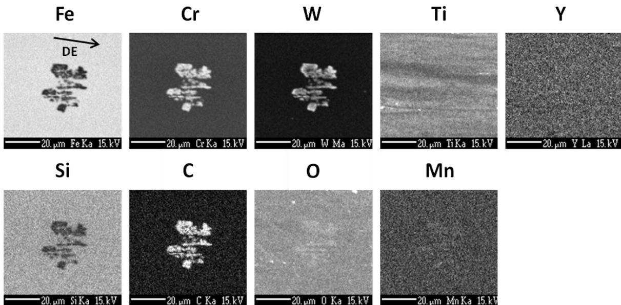
Figure III-46 : Cartographies réalisées à la microsonde de Castaing sur le carbure  $M_{23}C_6$  observé dans la nuance J03 vieillie à 600°C pendant 5000 heures. La direction d'extrusion (DE) est représentée.
