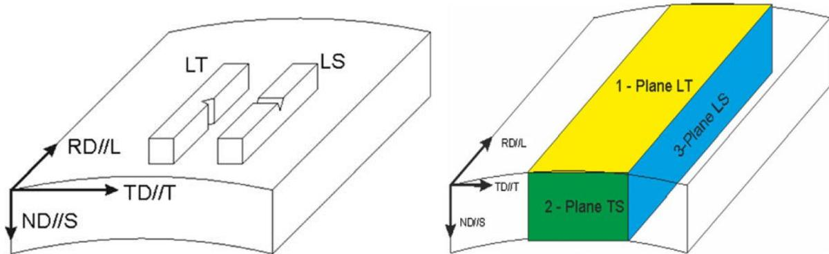
Figure IV-11 : Schéma du sens de prélèvement des éprouvettes de résilience de types LT et LS et dénominations des différents plans dans la nuance PM2000 laminage sous forme de tube [Chao-2013].
