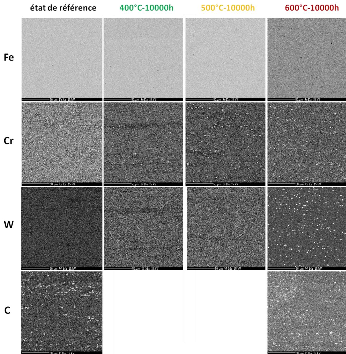
Figure III-62 : Cartographies des éléments chimiques Fe, Cr, W et C obtenues à la microsonde de Castaing pour la nuance J27 avant et après vieillissement thermique à 400°C, 500°C et 600°C pendant 10000 heures.
