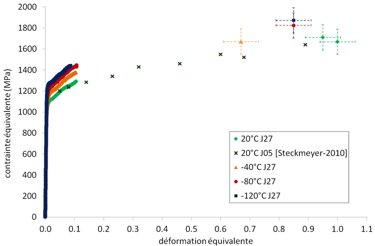
Figure V-4 : Evolution de la contrainte équivalente en fonction de la déformation équivalente des nuances J27 et J05 sollicitées en sens axial à la vitesse de  $10^{-3} \text{ s}^{-1}$ . Les points correspondant aux grandes déformations sont obtenus par analyse de Bridgman, les barres d'erreur sont représentées pour ces points.
