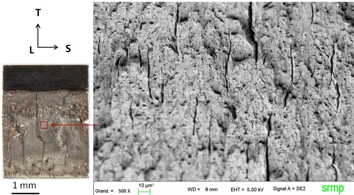
**Figure IV-42 : Vue macroscopique du faciès de rupture de la nuance F40 testée en résilience à -100°C dans la direction de sollicitation LT, et cliché réalisé au MEB-FEG dans la zone repérée sur la vue macroscopique.**
