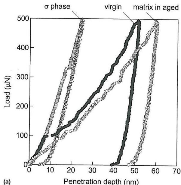
**Figure III-10 : Courbes de nanodureté obtenues pour la matrice non vieillie, la matrice vieillie et la phase  $\sigma$  dans un acier austénitique (type 316) après vieillissement de 39332 heures à 700°C [Ohmura-2006].**
