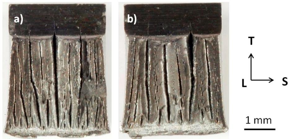
Figure IV-38 : Faciès de rupture de la nuance F40 testée en résilience en sollicitation LT a) à  $-40^{\circ}\text{C}$  et b) à  $+100^{\circ}\text{C}$  et présentant de nombreuses fissures de délaminage.
