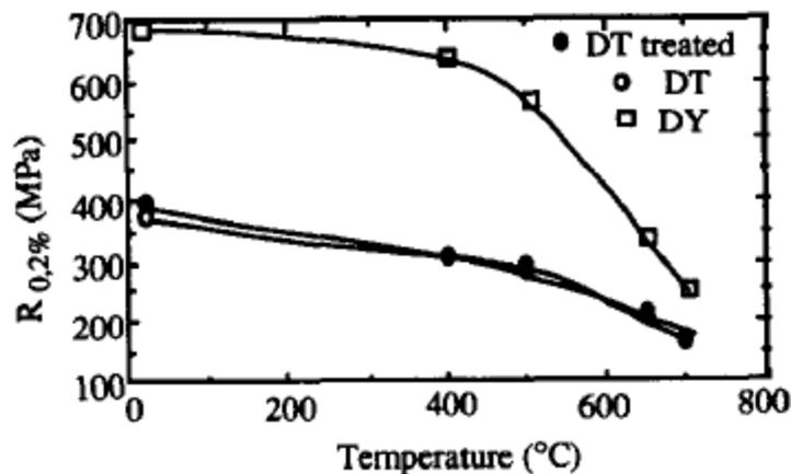
Figure III-22 : Evolution de la limite d'élasticité des nuances d'acier DT, DT traité et DY ODS en fonction de la température. La nuance DT traitée est la seule à ne pas contenir de phase  $\chi$  [Zakine-1996].
