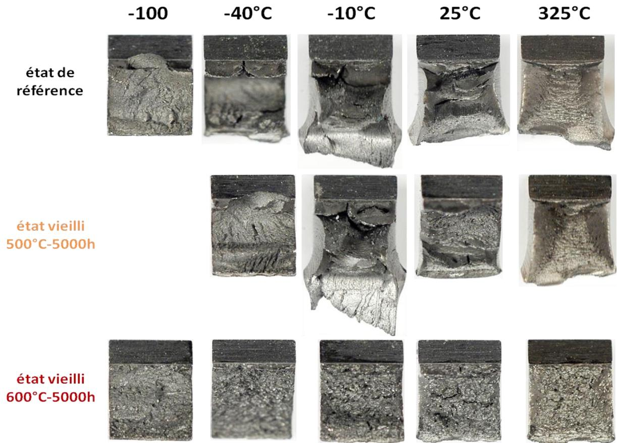
Figure III-34 : Faciès de rupture de la nuance J03, avant et après vieillissement thermique à 500°C et 600°C pendant 5000 heures.
