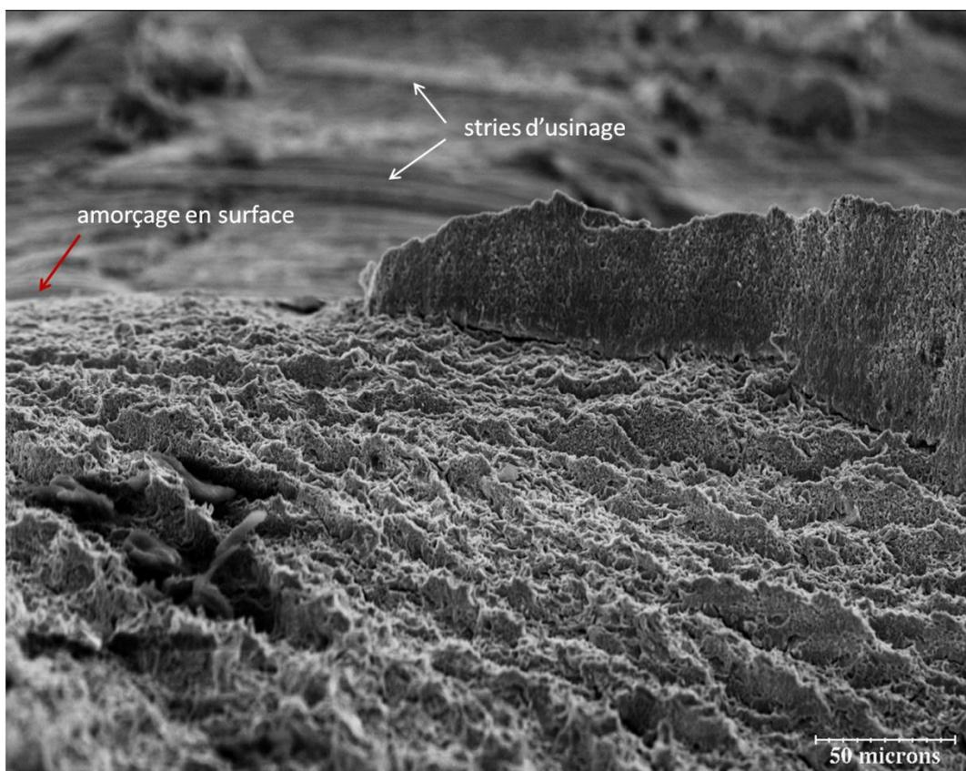
Figure V-50 : Amorçage de la rupture en surface à partir d'un défaut d'usinage sur une éprouvette de type AE-R2 testée à  $-120^{\circ}\text{C}$ .
