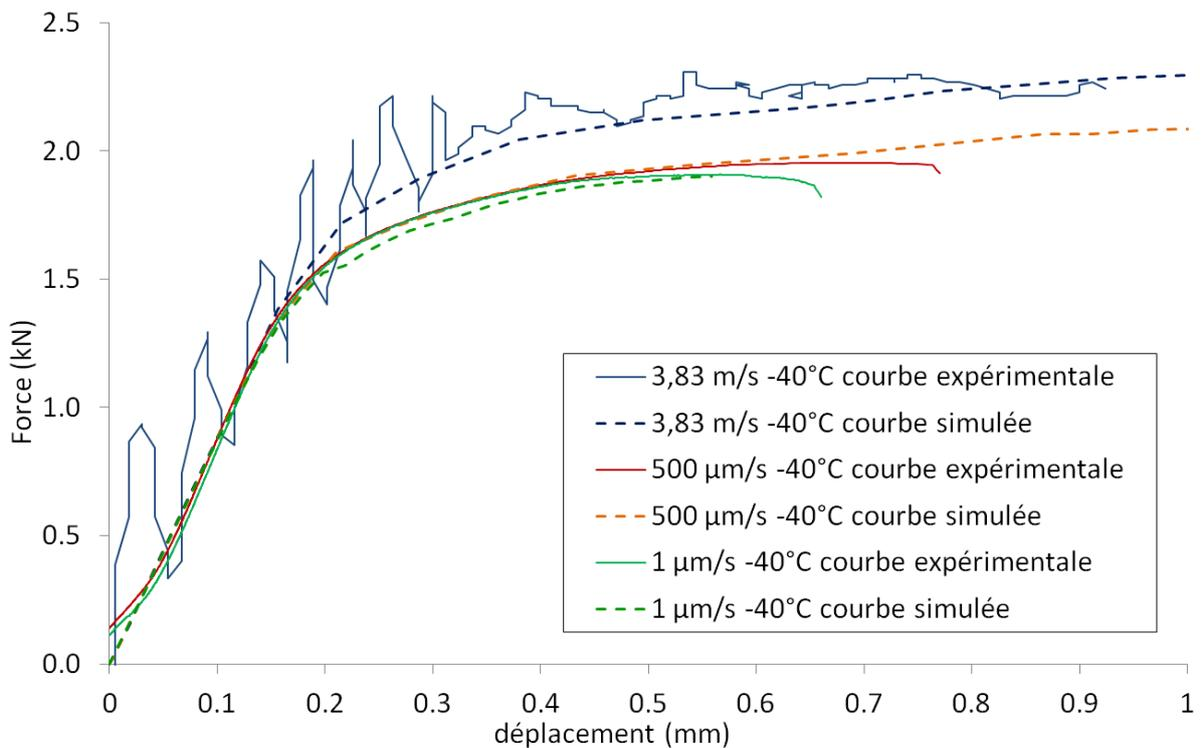
Figure V-24 : Réponses expérimentales et simulées des essais de flexion et de résilience réalisés à -40°C sur la nuance J27 aux vitesses de 1  $\mu\text{m/s}$ , 500  $\mu\text{m/s}$  et 3,8 m/s, en sollicitation LT.
