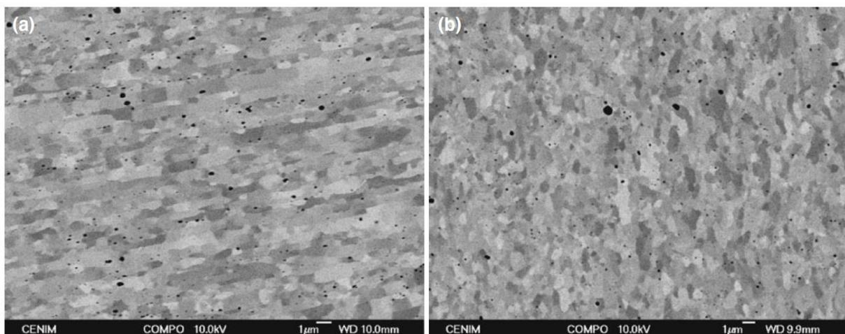
Figure IV-12 : Microstructure de la nuance PM2000 laminée sous forme de tube vue a) dans le plan LT et b) dans le plan LS [Chao-2013].
