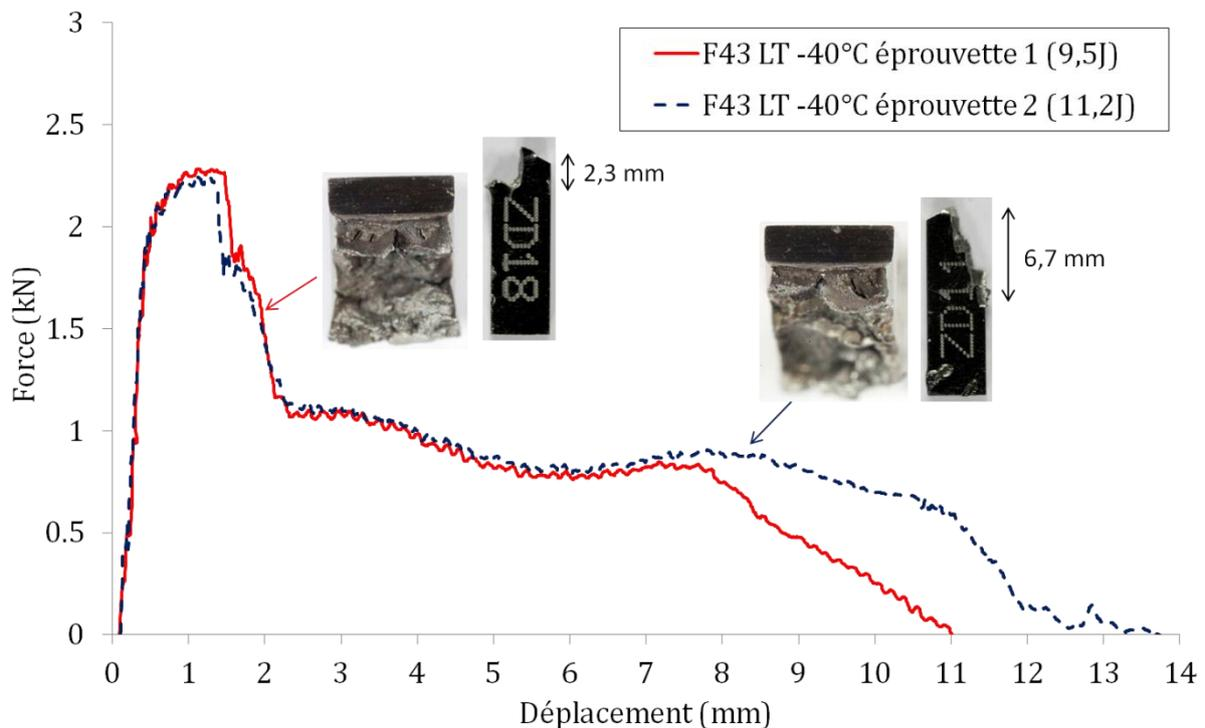
**Figure IV-21 : Courbes force-déplacement et faciès de rupture des deux éprouvettes testées en résilience en sollicitation LT à  $-40^{\circ}\text{C}$  issues de la nuance F43. Le mécanisme de rupture de type bifurcation est apparu sur ces deux éprouvettes.**
