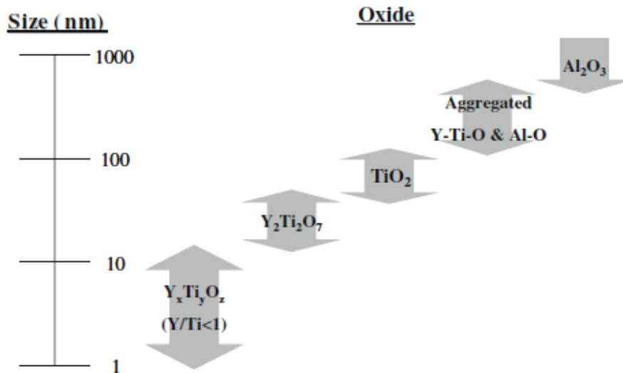
Figure II-2 : Récapitulatif des types d'oxydes et de leurs tailles observées dans le cas d'un acier ODS MA957 à 14%Cr-1%Ti-0,3%Mo-0,3%Y<sub>2</sub>O<sub>3</sub> [Sakasegawa-2009].
