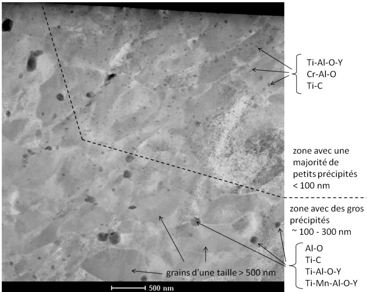
Figure IV-33 : Populations de précipités observées sur la nuance d'acier ODS J27 sur une lame mince prélevée au FIB. Deux zones apparaissent : une zone avec une majorité de petits précipités d'une taille inférieure à 100 nm, et une zone avec de nombreux précipités dont la taille dépasse 100 nm.
