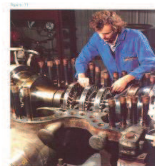
Figure 1.9 Photo de la turbine à l'ammoniac (source EDF)
