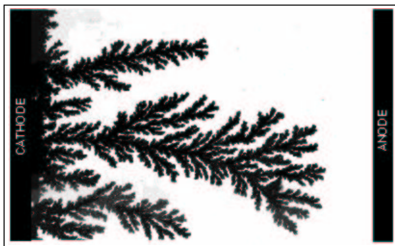
FIG. 1.1 – croissance arborescente d’une cathode de cuivre, plongée dans une solution de sulfate de cuivre (avec la permission de V. Fleury). On voit une partie de la cellule quasi-bidimensionnelle, de taille 3 \times 2 \text{ mm}^2 . Les phénomènes impliqués dans cette expérience sont détaillés à la figure 1.2
