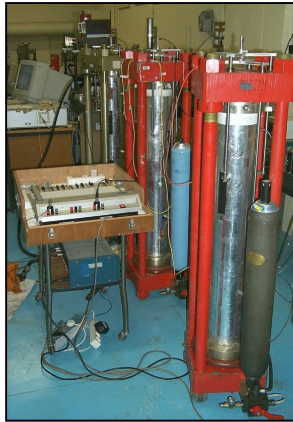
Bâti de fluage 16/100 (3 en tout) préparation de la mise en charge jauges (longitudinales) + capteurs LVDT + CFO n°2 + CCV
