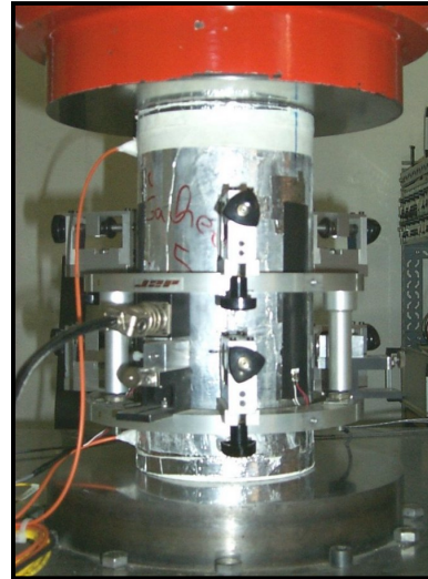
Presse n°1 16/32 chargement/ déchargement par paliers 3 jauges (longitudinales) + J2P + 1 CFO n°2
