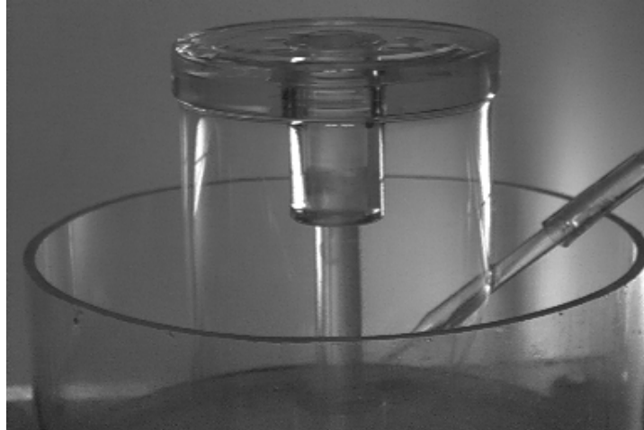
FIG. 3.1 – Cylindre liquide obtenu par gonflement d'une cloche.
