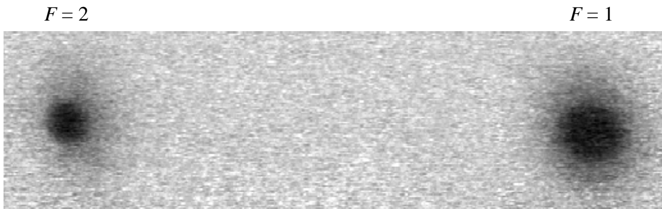
FIG. IV.25 – Image en absorption d'un condensat contenant les deux espèces |2, 2\rangle et |1, -1\rangle . Un gradient appliqué brièvement durant la coupure permet de séparer par effet Stern et Gerlach les deux condensats. Après un temps de vol de 20 ms, la séparation apparente des deux nuages est de 1,5 mm.
