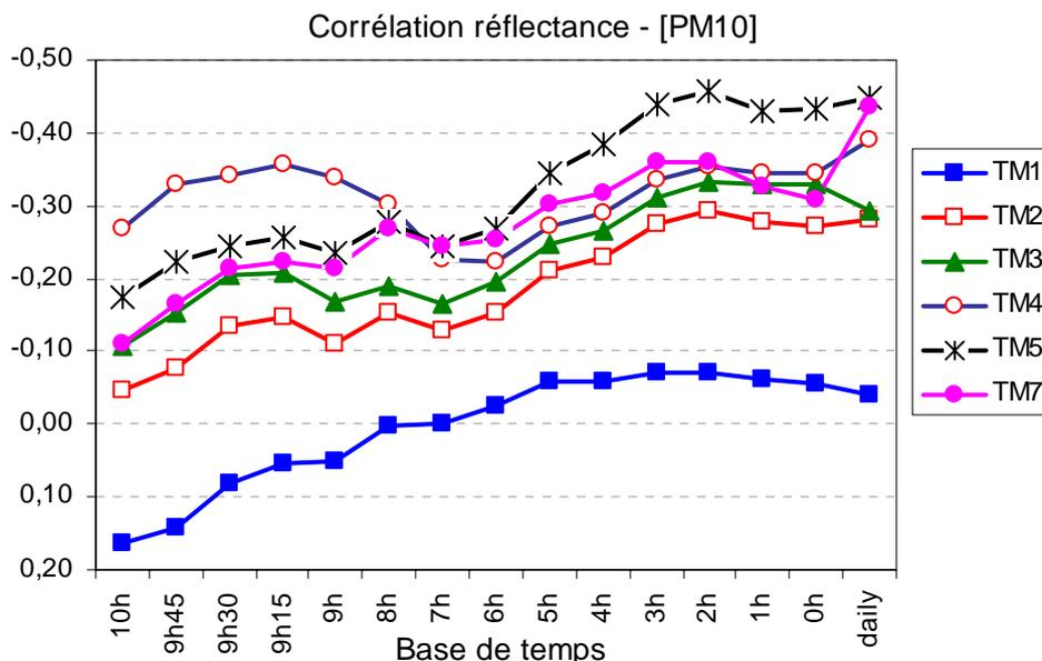
Figure 6.9 : Corrélations multitudes et toutes stations confondues entre les réflectances exo-atmosphériques corrigées  $F$  et les concentrations en particules  $PM_{10}$  intégrées sur une base de temps.
