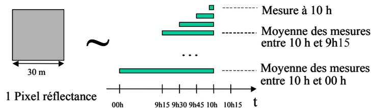
Figure 6.7 : Mise en correspondance de la mesure de réflectance avec ceux de concentrations de polluants
