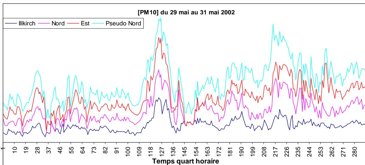
Figure 6.5 : Evolution temporelle de la concentration en  $PM_{10}$  en  $\mu\text{g}/\text{m}^3$  pour les stations STG Illkirch, STG Est et STG Nord et la pseudostation associée à STG Nord, du 29 au 31 mai 2002. Les courbes ont été décalées pour une meilleure visibilité.
