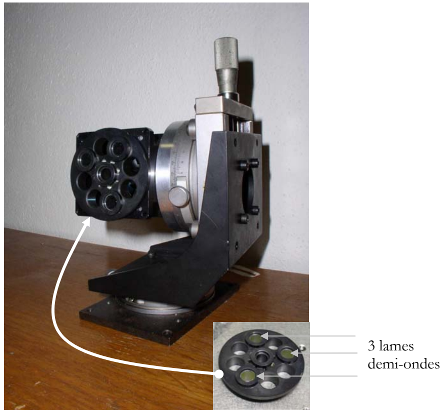
Photo III.2 : système de lames demi-ondes permettant le contrôle de la polarisation.
