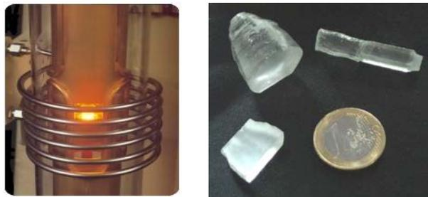
Figure 1-20 – Méthode de Czochralski. À gauche, vue intérieure d'un système commercial de croissance cristalline. À droite, exemple d'échantillons d'Yb: SYS.
